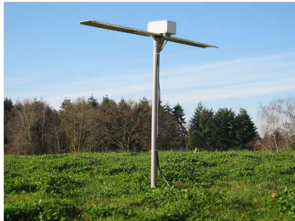
FIGURE 3.11 – Antenne dipolaire de CODALEMA II.
