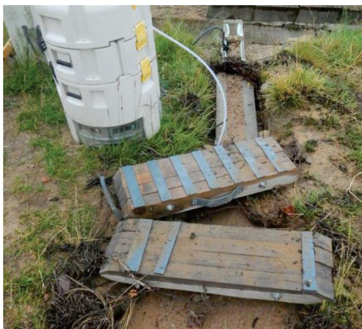
**Figure 37 : photographie du dispositif de suivi du ruissellement après un événement pluvieux très érosif : on constate un remplissage du canal**
