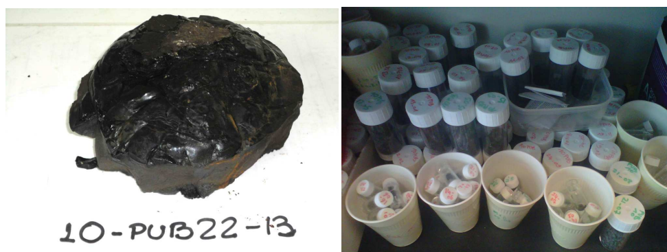
FIGURE 3.1 – Aperçu des échantillons. A gauche un bloc de basalte recouvert d’une épaisse couche de verre à partir de laquelle est faite l’analyse géochimique. A droite les échantillons après triage sous loupe binoculaire et rangés dans des petits piluliers.
