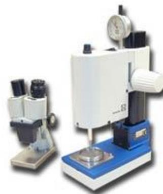
Figure 7 : Carotteuse à ultrason « 601 TPC-Tool ultrasonic cutter »
