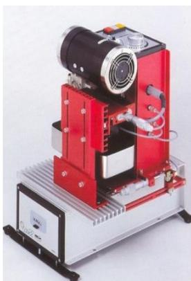
Figure 2 : Scie à fil « W3242 ».
