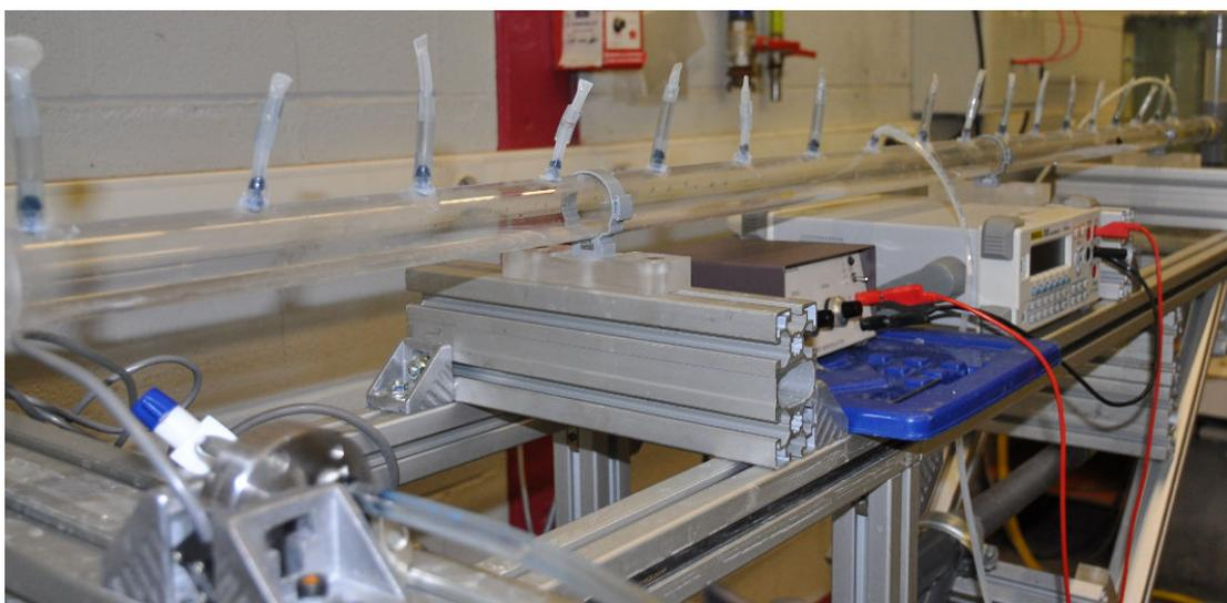
FIGURE 2.18 – Photographie du montage avec prises de pression.
