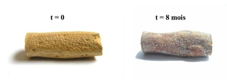
Une manière de remédier à l'instabilité biologique des polyECs de liqueur noire consiste à transformer la matrice polymère en matrice carbonée. Ce chapitre concerne l'étude de la carbonisation des polyECs de liqueur noire, de façon à s'affranchir des contraintes climatiques et d'augmenter les propriétés poreuses, tout en gardant la forme microcellulaire interconnectée qui fait la spécificité de ces matériaux.
