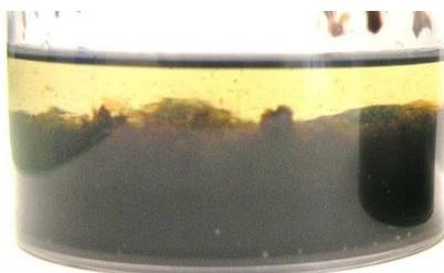
2. Les émulsions sont placées dans des moules en téflon cylindriques hermétiques et démontables. Ces moules sont placés dans une étuve à 60°C pendant 24 h afin de réaliser la réaction de réticulation et obtenir des monolithes rigidifiés. Si un surnageant est présent à la surface du monolithe ou si l'émulsion est partiellement liquide alors un déphasage a eu lieu pendant la réticulation.
