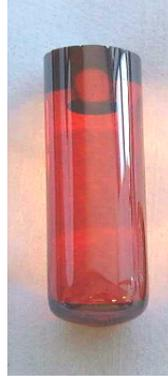
FIG. 2.1: Photographie des verres d' $As_2S_3$  utilisés
