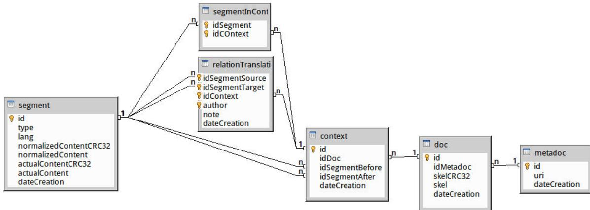
Figure 8 : Structure logique d'une base de données de corpus multilingues
