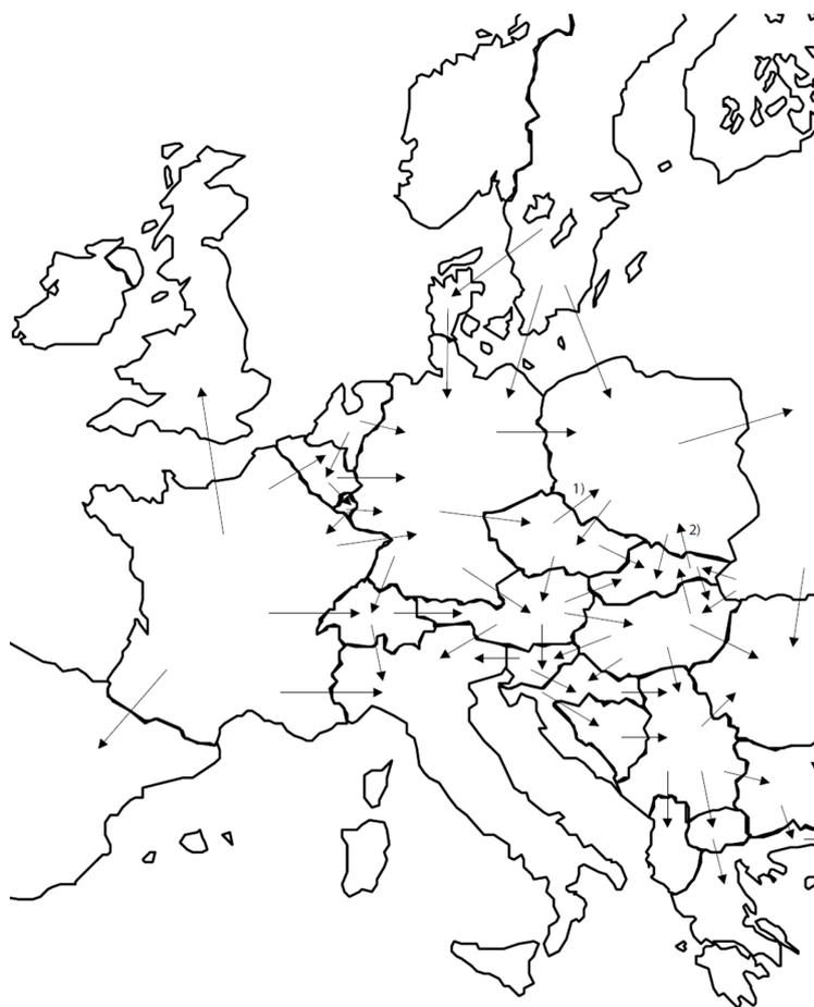
FIGURE 4.7 – Sens de la marche des trains à numérotation impaire – Source : extrait Fiche UIC 419-2
