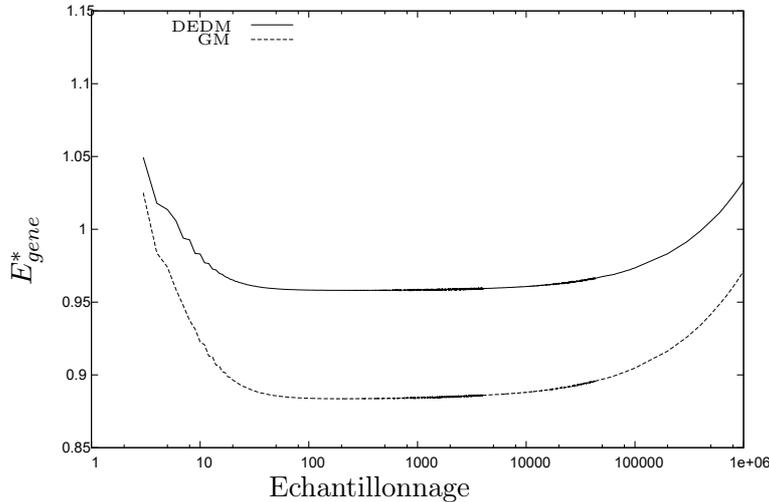
FIGURE 4.1 – Evolution de l'erreur généralisée normalisée des estimateurs optimaux *EO-GM* et *EO-DEDM* en fonction de leur échantillonnage
