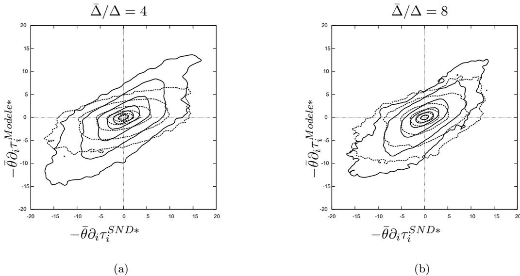
FIGURE 4.11 – Fonction de densité de probabilité jointe entre le transfert sous-maille exact et le transfert sous-maille du *DEDM* (-----) et du *ANNM* (—) pour plusieurs tailles de filtre  $\bar{\Delta}/\Delta = 4, 8$ . la forme étoilée signifie que le transfert sous-maille est normalisé par l'écart type du transfert sous-maille exact. Les lignes de niveaux vont d'une densité de probabilité de 0.0001 % à 10 % avec une progression géométrique de raison 10.
