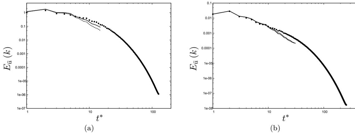
FIGURE 5.25 – Spectre de l'énergie cinétique des champs de vitesse pour les SGE avec les modèles sous-maille *ACLNM* (—), *DSM* (-----) et la SGE filtrée (• •) pour les résolutions de  $32^3$  points à  $Re_\lambda = 90$  (a) et  $64^3$  points à  $Re_\lambda = 160$  (b).
