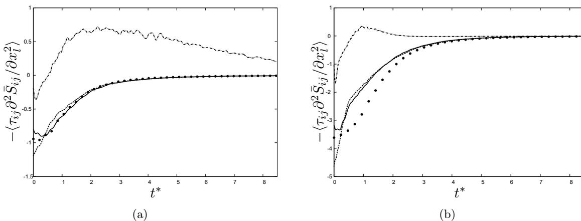
FIGURE 3.20 – Evolution de la dissipation sous-maille d'enstrophie des modèles *DSM* (-----), *DRGM* (—), *GM* (.....) en comparaison avec la *SND* filtrée (••) pour les résolutions de  $32^3$  (a) et  $64^3$  (b).
