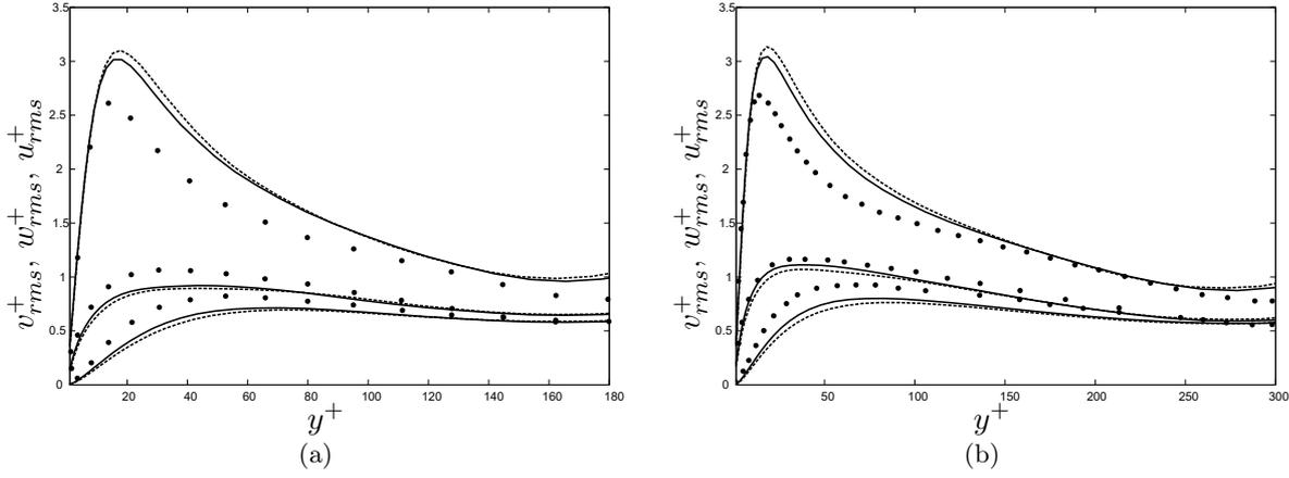
FIGURE 3.24 – Profils des fluctuations des composantes de la vitesse en fonction de la distance à la paroi pour les modèles *DRGM* (—), *DSM* (-----) et la SND (• •) pour les  $Re_\tau$  de 180 (a) et 300 (b) théoriques.
