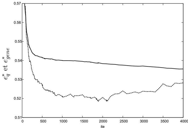
FIGURE 4.8 – Evolution des erreurs d'entraînement  $e_q^*$  (—) et de généralisation  $e_{gene}^*$  (-----) au cours de l'apprentissage du réseau défini par l'ensemble de paramètres  $\{7, 1, 15, 15\}$  selon la définition (4.30)
