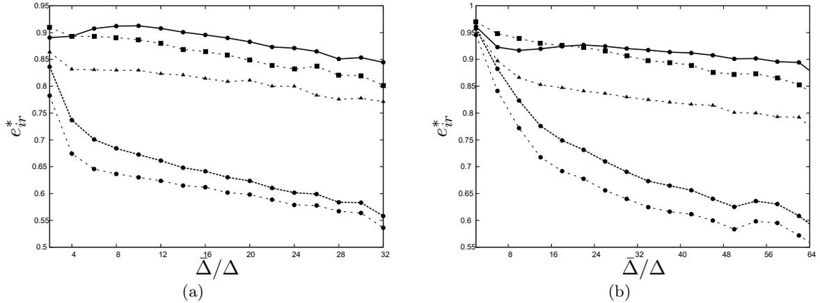
FIGURE 3.3 – Evolution des erreurs irréductibles des jeux de variables  $\phi^{GM}$  ( $-\blacktriangle-$ ),  $\phi^{DSM}$  ( $-\blacksquare-$ ),  $\phi^{RGM1}$  ( $--\bullet--$ ),  $\phi^{RGM2}$  ( $-\bullet-$ ) et  $\{\phi\}^{RGM3}$  ( $-\bullet-$ ) sur les bases de données  $Re_\lambda = 160$ ,  $Sc = 0.7$  (a) et  $Re_\lambda = 90$ ,  $Sc = 16$  (b)
