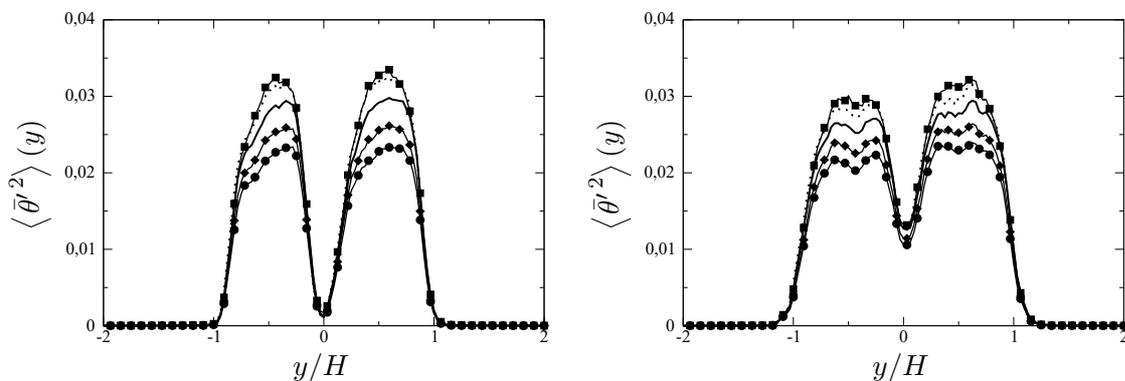
FIGURE 3.10 – Profils des variances des scalaires résolus avec les modèles *DSM* ( $\bullet$ ), *DRGM* ( $\blacklozenge$ ) et *GM* ( $\blacksquare$ ) en comparaison avec la SND filtrée (—) et la SND ( $\cdots$ ) pour deux instants différents du développement du jet.
