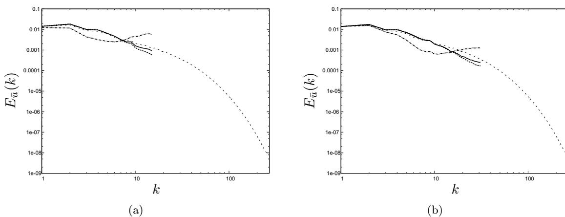
FIGURE 3.17 – Spectres d'énergie cinétique des champs de vitesse de la décroissance avec les modèles sous-maille *DSM* (-----), *DRGM* (—), *GM* (-·-·-) en comparaison avec la SND (- - -) pour les résolutions de  $32^3$  (a) et  $64^3$  (b) à l'instant  $t^* = 1$ .
