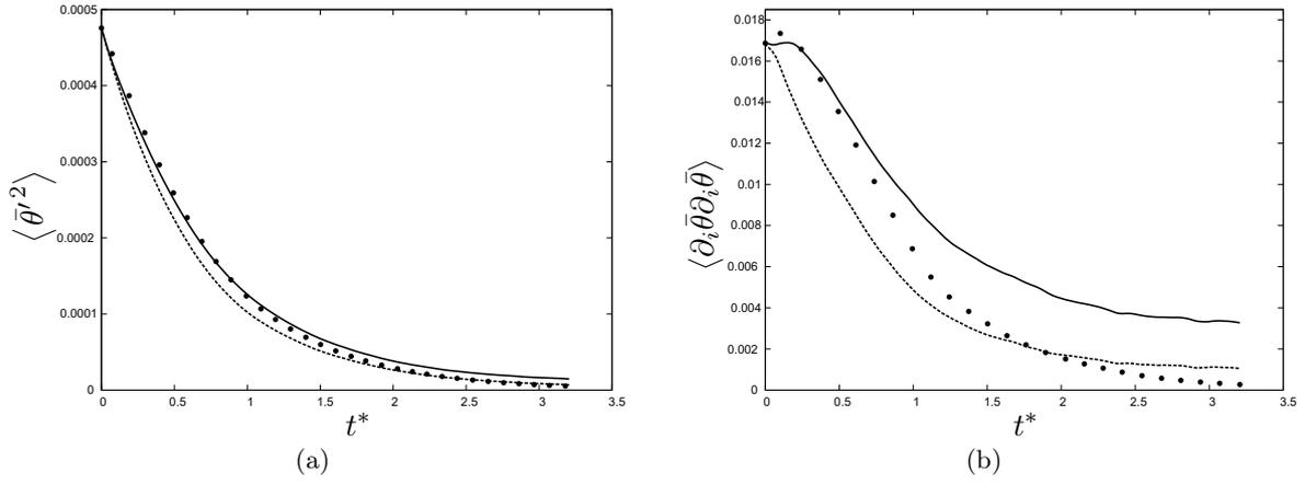
FIGURE 5.9 – Evolution de la variance (a) et de l’entropie (b) de scalaire résolu pour les modèles *ACWM* (—), *DEDM* (-----) et de la SCD filtrée ( $\bullet \bullet$ ) ( $Re_\lambda = 90$ ,  $N_\theta = 64^3$ ).
