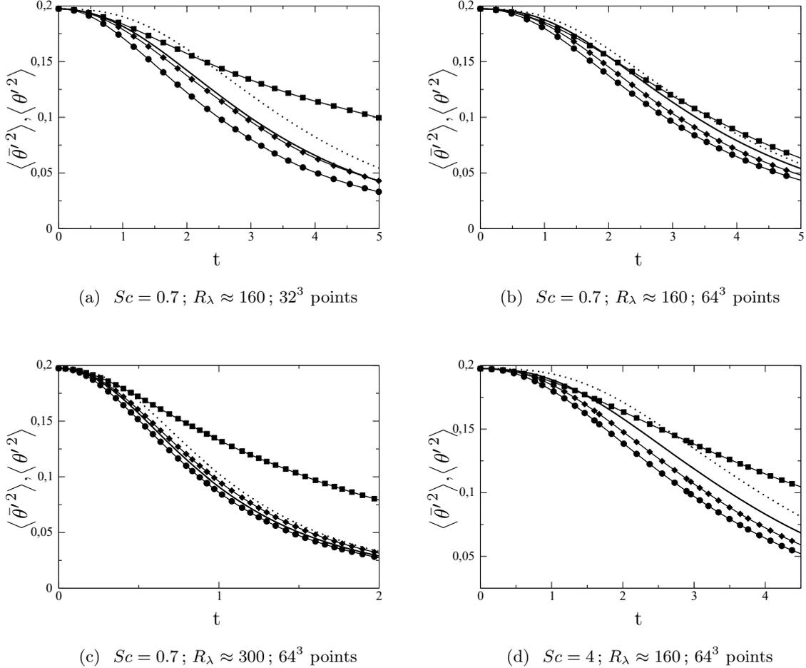
FIGURE 3.6 – Evolution des variances des scalaires résolus par SGE avec les modèles sous-maille *DSM* ( $\bullet$ ), *DRGM* ( $\blacklozenge$ ) et *GM* ( $\blacksquare$ ) en comparaison avec la SVD filtrée ( $\text{—}$ ) et la SVD ( $\cdots$ ).
