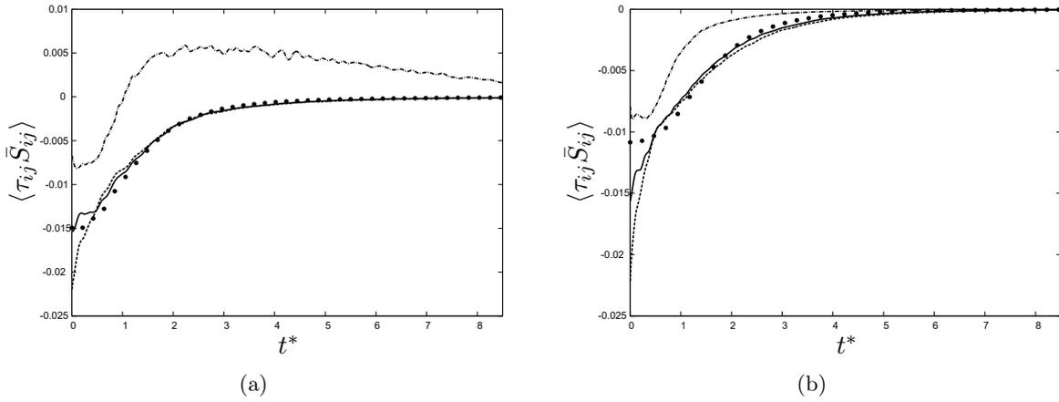
FIGURE 3.18 – Evolution de la dissipation sous-maille d'énergie cinétique des modèles *DSM* (.....), *DRGM* (—), *GM* (-----) en comparaison avec la SND filtrée (• •) pour les résolutions de  $32^3$  (a) et  $64^3$  (b).
