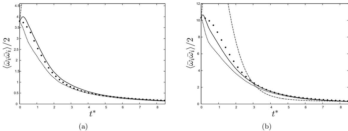
FIGURE 3.19 – Evolution de l'enstrophie résolue des champs de vorticit  de la THI en d croissance avec les mod les sous-maille *DSM* (.....), *DRGM* (—), *GM* (-----) en comparaison avec la SND filtr e (• •) pour les r solutions de  $32^3$  (a) et  $64^3$  (b).
