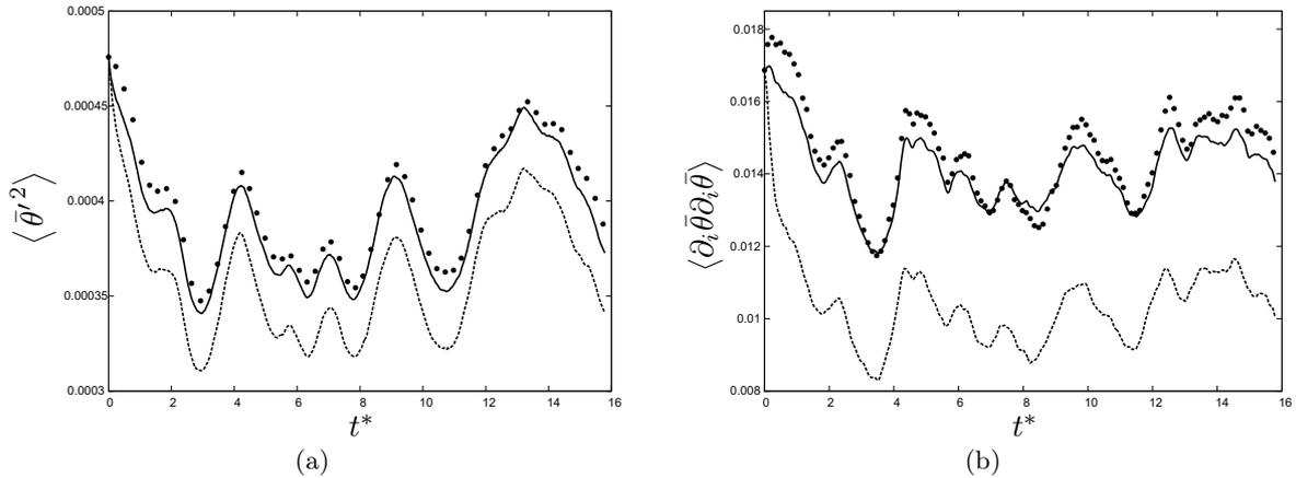
FIGURE 5.7 – Evolution de la variance (a) et de l'enstrophie (b) de scalaire résolu pour les SGE des modèles  $ACWM$  (—),  $DEDM$  (-----) et de la SND filtrée ( $\bullet \bullet$ ) ( $Re_\lambda = 90$ ,  $N_\theta = 64^3$ ).
