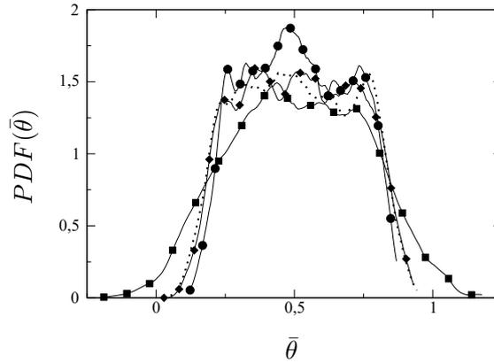
FIGURE 3.8 – Fonctions de densité de probabilité des scalaires résolus par SGE de résolution  $32^3$  points avec les modèles sous-maille *DSM* (●), *DRGM* (◆) et *GM* (■) en comparaison avec la *SND* filtrée (⋯) à l'instant où  $\langle \bar{\theta}'^2 \rangle^{SND} = 0.1$ .
