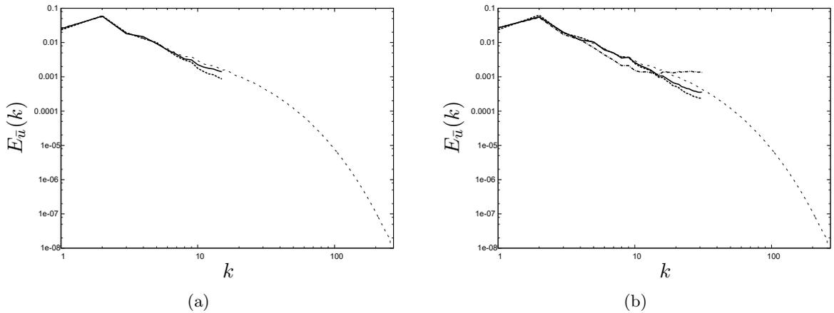
FIGURE 3.22 – Spectres de l' nergie cin tique r solv e moyenn s sur 7 unit s de temps de retournement tourbillonnaire pour les mod les sous-maille *DSM* (-----), *DRGM* (—), *GM* (.....) en comparaison avec la *SND* (- - -) pour les r solutions de  $32^3$  (a) et  $64^3$  (b). Le spectre de l' nergie cin tique du champ de vitesse du *GM* n'est pas repr sent  pour la SGE de  $32^3$    cause de son instabilit .
