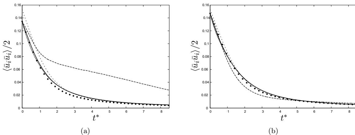
FIGURE 3.16 – Evolution de l'énergie cinétique résolue des champs de vitesse de la décroissance avec les modèles sous-maille *DSM* (-----), *DRGM* (—), *GM* (-·-·-) en comparaison avec la SND (- - -) et la SND filtrée ( $\bullet \cdot$ ) pour les résolutions de  $32^3$  (a) et  $64^3$  (b).
