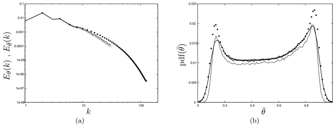
FIGURE 5.18 – Spectre de la variance (a) et densité de probabilité (b) de scalaire des SGE des modèles *ACWM* (—), *DEDM* (-----) et du scalaire de *SND* (• •) sur (a) et de *SND* filtrée sur (b) à  $t^* = 0.54$  ( $Re_\lambda = 91$ ,  $N_\theta = 64$ ).
