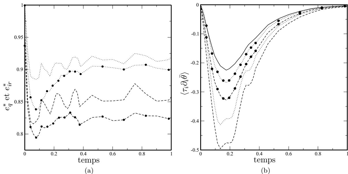
FIGURE 4.3 – Evolution des performances structurelles (a) et fonctionnelles (b) au cours du temps pour les modèles *DEDM* (.....), *CM* (-----) et leurs modèles optimaux associés (••). Pour la performance fonctionnelle (b), la dissipation sous-maille exacte est également représentée (—).
