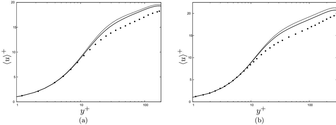
FIGURE 3.23 – Profils de vitesse débitante moyenne en fonction de la distance à la paroi en unité de paroi pour les modèles *DRGM* (—), *DSM* (-----) et la *SND* (• •) pour les  $Re_\tau$  de 180 (a) et 300 (b) théoriques.
