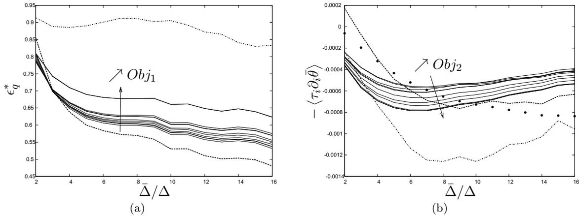
FIGURE 5.6 – Tests *a priori* des modèles  $ACWM_i$  générés par les  $p_i^{inter}$ . Evolution des erreurs quadratiques normalisées (a) et évolution des dissipations sous-maille (b) en fonction de la taille de filtre  $\bar{\Delta}/\Delta$  pour les modèles  $DEDM$  (-----),  $ANNM$  (-·-·-·-) et  $ACWM_i$  (—) en comparaison à la SND filtrée ( $\bullet \bullet$ ).
