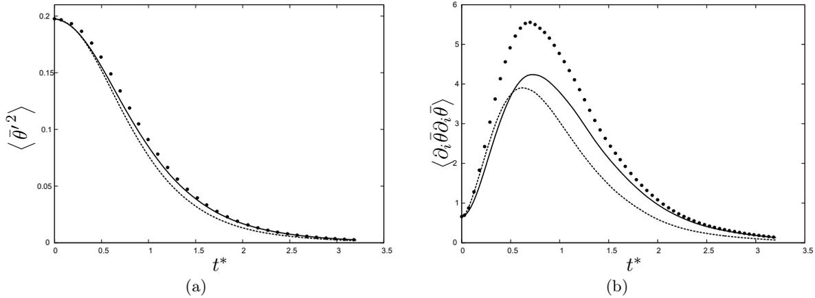
FIGURE 5.11 – Evolution de la variance (a) et de l'enstrophie (b) de scalaire résolu pour les SGE des modèles *ACWM* (—), *DEDM* (-----) et de la SND filtrée ( $\bullet \bullet$ ) ( $Re_\lambda = 90$ ,  $N_\theta = 64^3$ ).
