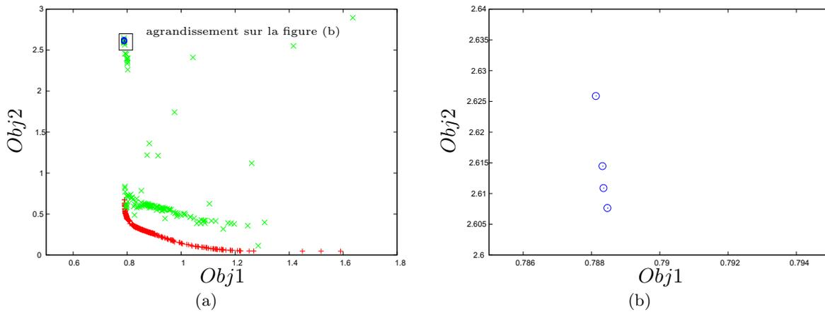
FIGURE 5.20 – (a) Représentation des individus des fronts de Pareto globaux calculés sur la base de données d'entraînement  $\{\mathbf{p}\}^{train}$  (+) et sur la base de données de test  $\{\mathbf{p}\}^{test}$  (x). Les symboles ( $\circ$ ) représentent l'intersection des deux ensembles d'individus. (b) Agrandissement de la zone du plan des objectifs où se trouvent les individus formant l'intersection des deux fronts de Pareto ( $\circ$ ).
