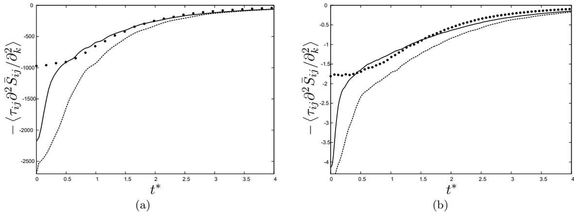
FIGURE 5.27 – Evolution de la dissipation sous-maille de l’enstrophie des mod les sous-maille *ACLMN* (—) *DSM* (-----) et la *SND* filtr e (• •) pour les r solutions de  $32^3$  points    $Re_\lambda = 90$  (a) et  $64^3$  points    $Re_\lambda = 160$  (b).
