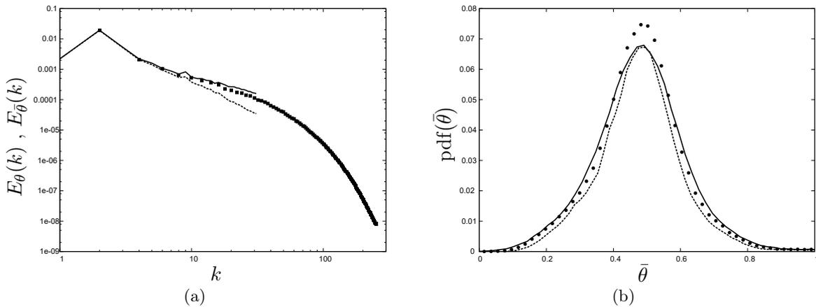
FIGURE 5.16 – Spectre de la variance (a) et densité de probabilité (b) de scalaire des SGE des modèles *ACWM* (—), *DEDM* (-----), du scalaire de SND filtrée (• •) et de la SND (■ ■) à  $t^* = 3.68$  ( $Re_\lambda = 160$ ,  $N_\theta = 64^3$ ).
