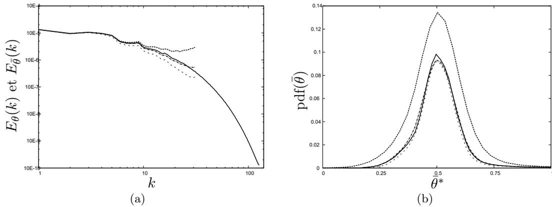
FIGURE 4.15 – Simulation sans forçage du scalaire. Spectres (a) et fonction de densité de probabilité (b) pour le scalaire à  $t^* = 0.74$ . *DEDM* (- - -), *DNTDM* (.....) et *ANNM* (-·-·-) comparés à la *SND* (a) et *SND* filtrée (b) (—).
