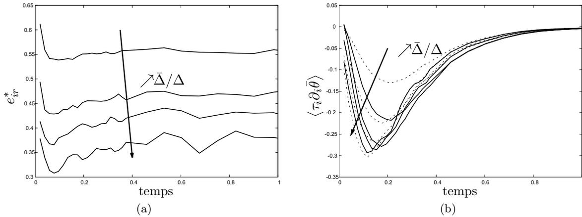
FIGURE 4.6 – Comparaison des erreurs irréductibles de l’ensemble  $\{\phi\}^{Noll}$  au cours du mélange (a). Comparaison de la performance fonctionnelle des modèles basés sur l’ensemble  $\{\phi\}^{Noll}$  (—) avec la dissipation sous-maille exacte (- - -) (b). Sur les deux figures, les tests sont effectués pour quatre rapports de filtrage  $\bar{\Delta}/\Delta = 4, 8, 12$  et  $16$ .
