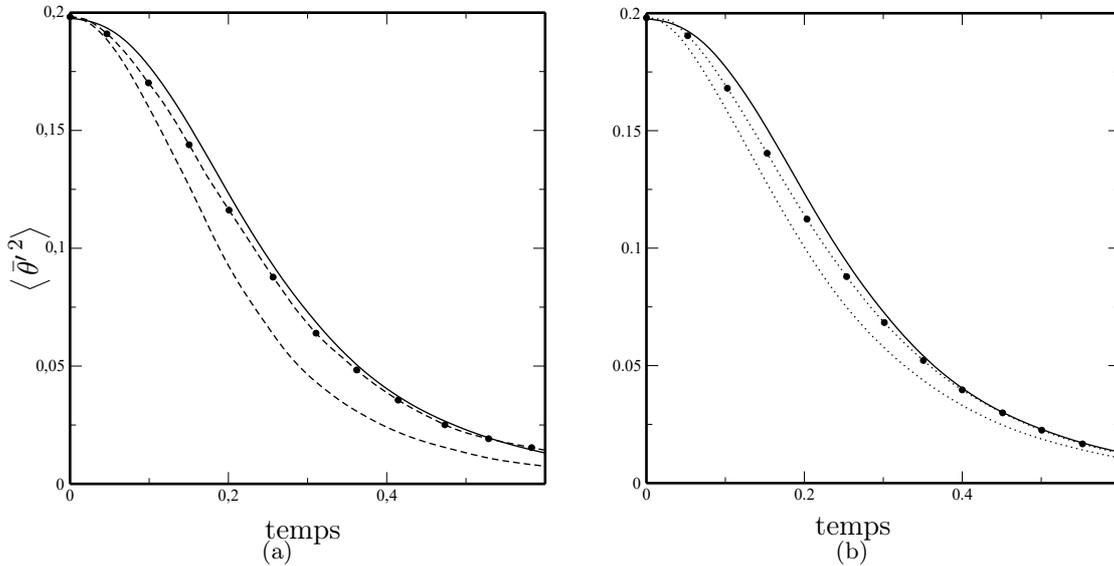
FIGURE 4.4 – Evolution de la variance statistique du scalaire résolu  $\langle \bar{\theta}^2 \rangle$  des SGE à  $\bar{\Delta} = 8\Delta$ . (a) :  $CM$  (-----) et  $EO - CM$  ( $\bullet \bullet$ ). (b) :  $DEDM$  ( $\cdots$ ) et  $EO - DEDM$  ( $\bullet \bullet$ ). Le trait fort représente l'évolution de la variance de la SND filtrée.
