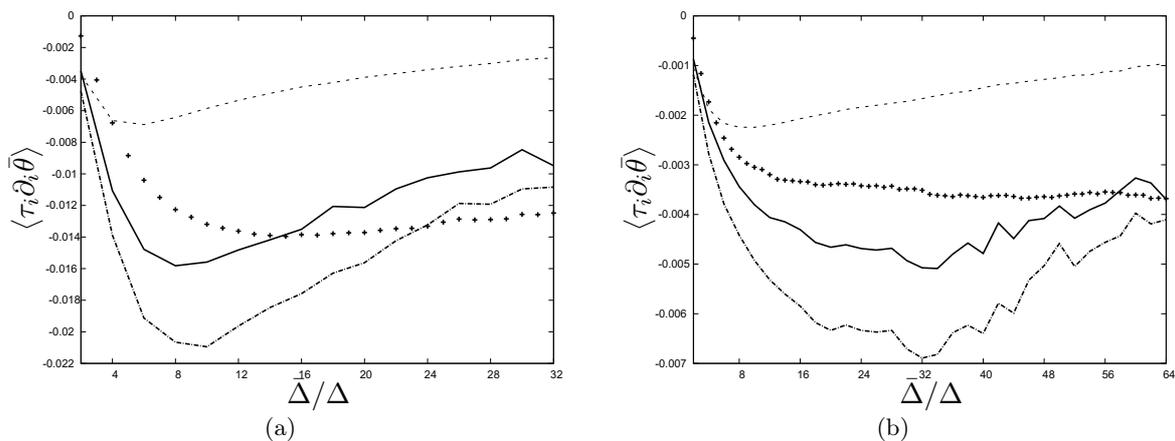
FIGURE 3.5 – Dissipations de la variance du scalaire sous-maille des modèles  $GM$  (- - -),  $DSM$  (-·-·-·-),  $DRGM$  (—) en comparaison avec la dissipation sous-maille exacte de la SND filtrée (+ +), pour les bases de données  $Re_\lambda = 160$ ,  $Sc = 1$  (a) et  $Re_\lambda = 90$ ,  $Sc = 16$  (b)
