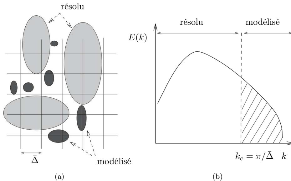
FIGURE 1.6 – Schéma représentatif des structures résolues et modélisées dans l'espace physique (a) et la fonction de densité d'énergie de ces mêmes parties dans l'espace de Fourier (b).
