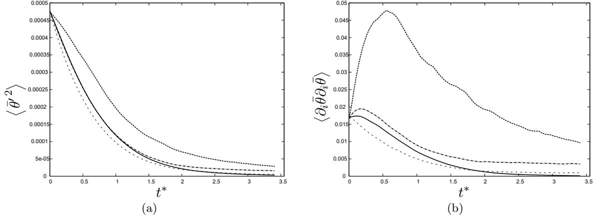
FIGURE 4.14 – Simulation sans forçage du scalaire. Evolution de la variance du scalaire résolu (a) et évolution de l'enstrophie du scalaire (b) pour des SGE utilisant les modèles *DEDM* (- - -), *DNTDM* (.....) et *ANNM* (-·-·-) comparés à la *SND* filtrée (—).
