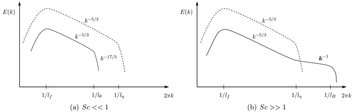
FIGURE 1.4 – Représentation schématique en échelle logarithmique des spectres de la variance de scalaire (—) et de l'énergie cinétique (-----) en fonction de la norme du vecteur d'onde  $\mathbf{k}$  pour  $Sc \ll 1$  (a) et  $Sc \gg 1$  (b).
