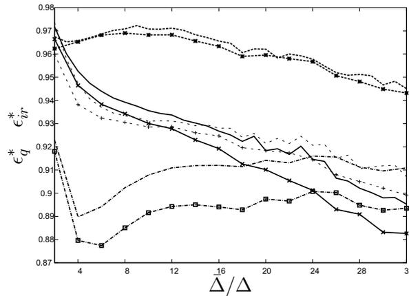
FIGURE A.2 – Erreurs irréductibles  $\epsilon_{ir}^*$  (symboles) et quadratique  $\epsilon_q^*$  des modèles  $DFS2RGM$  (---),  $GM$  (-----),  $DRGM$  (—), et  $DSM$  (-----) en fonction de la taille de filtre  $\bar{\Delta}/\Delta$
