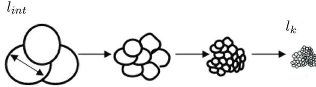
FIGURE 1.1 – Schéma des mécanismes de cascade énergétique où les structures de taille  $l_{int}$  représentent les plus grandes structures qui se subdivisent en de plus petites structures jusqu'à atteindre la taille minimale de  $l_\eta$ .
