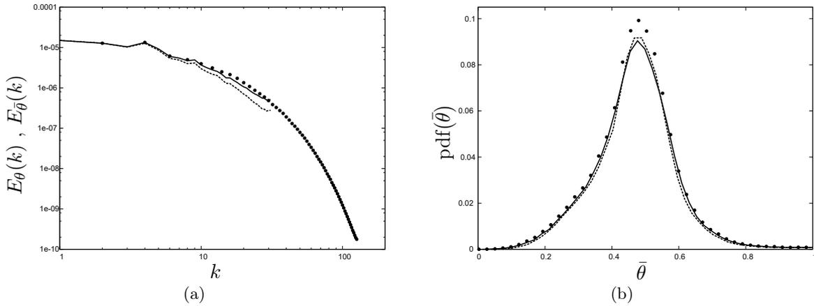
FIGURE 5.10 – Spectre de la variance (a) et densité de probabilité (b) de scalaire des SGE des modèles *ACWM* (—), *DEDM* (-----) et du scalaire de SCD ( $\bullet \bullet$ ) sur (a) et de la SCD filtrée sur (b), à  $t^* = 0.64$  ( $Re_\lambda = 90$ ,  $N_\theta = 64^3$ ).
