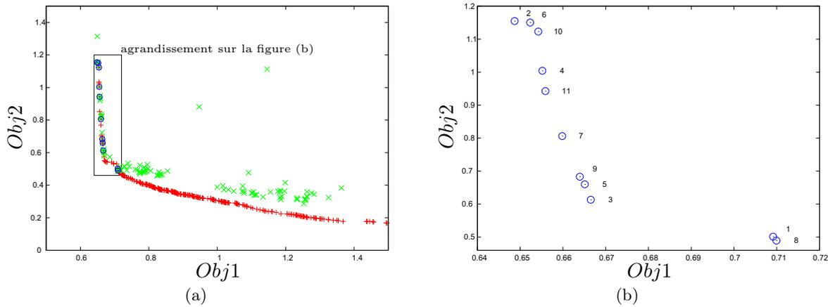
FIGURE 5.4 – (a) Représentation des individus des fronts de Pareto globaux pour la base de données d’entraînement  $\{\mathbf{p}\}^{train}$  (+) et pour la base de données de test  $\{\mathbf{p}\}^{test}$  (x) dans le plan des objectifs calculé sur la base de données d’entraînement. Les symboles (o) représentent les individus de l’intersection des deux ensembles. (b) : Agrandissement de la zone du plan des objectifs où se trouve les individus formant l’intersection des deux fronts de Pareto (o).
