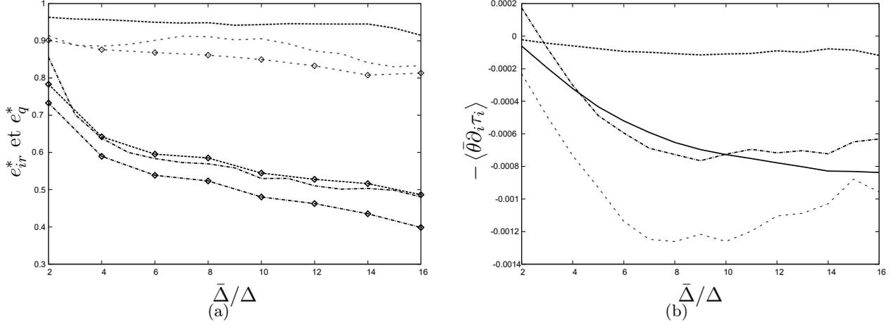
FIGURE 4.9 – Erreur irréductible et quadratique normalisées des modèles *DEDM* (- - -), *DNTDM* (- · - · -) et *ANNM* (· · · · ·) et des modèles optimaux ( $\diamond$ ) en fonction des tailles de filtre (a) et dissipation sous-maille des modèles en comparaison avec la dissipation sous-maille exacte (—) en fonction de la taille de filtre
