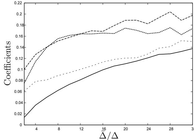
FIGURE A.1 – Evolution des coefficients dynamique  $C_{GL}$  (---·---),  $C_F$  (-----),  $C_{YM}$  (- - -),  $C_{SND}$  (—) en fonction de la longueur de coupure.
