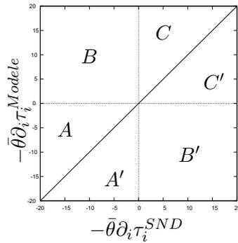
FIGURE 4.10 – Schéma explicatif des zones de probabilité d'existence des transferts sous-maille entre le modèle exact de la SND filtrée et un modèle à tester.
