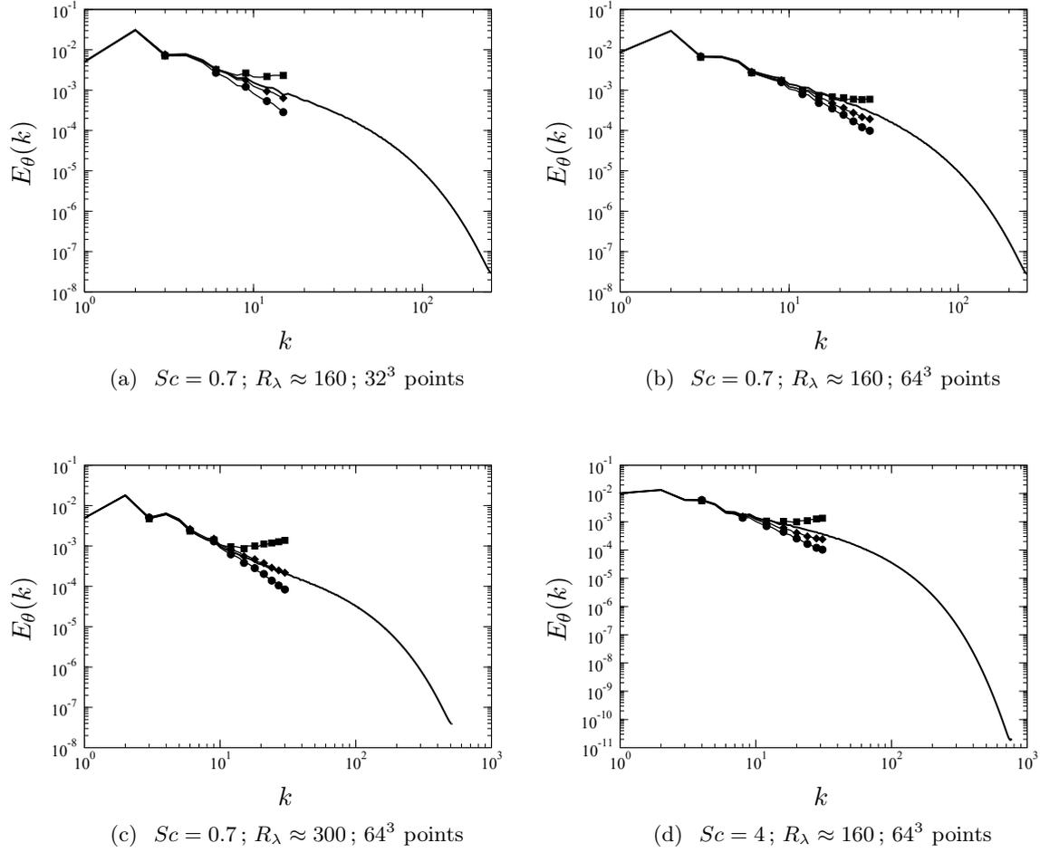
FIGURE 3.7 – Spectres des variances des scalaires résolus par SGE avec les modèles sous-maille *DSM* ( $\bullet$ ), *DRGM* ( $\blacklozenge$ ) et *GM* ( $\blacksquare$ ) en comparaison avec le spectre de la variance du scalaire de la SND ( $\text{—}$ ) à l’instant où  $\langle \bar{\theta}'^2 \rangle^{SND} = 0.1$ .
