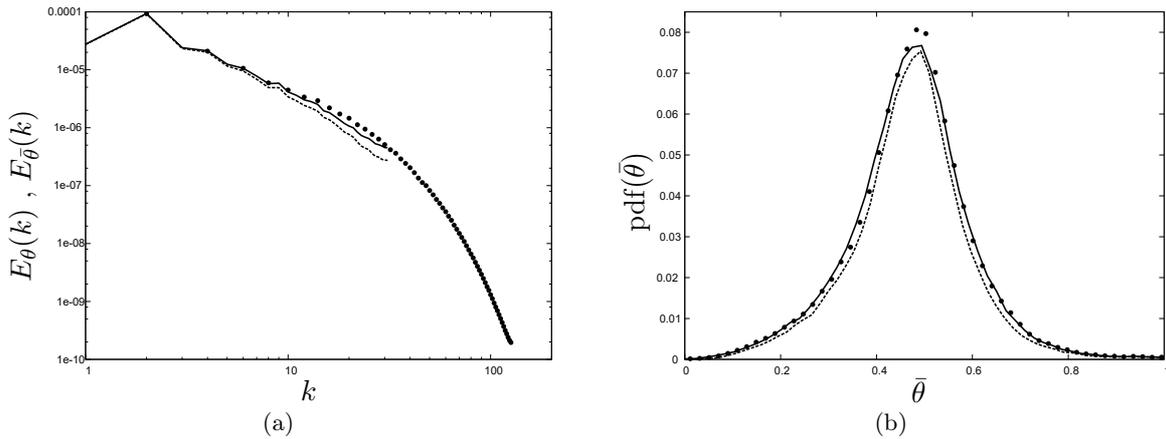
FIGURE 5.8 – Spectre de la variance de scalaire (a) et densité de probabilité de scalaire (b) des SGE des modèles *ACWM* (—), *DEDM* (-----) et du scalaire de *SND* (• •) sur (a) et de la *SND* filtrée sur (b) à  $t^* = 8.85$  ( $Re_\lambda = 90$ ,  $N_\theta = 64^3$ ).
