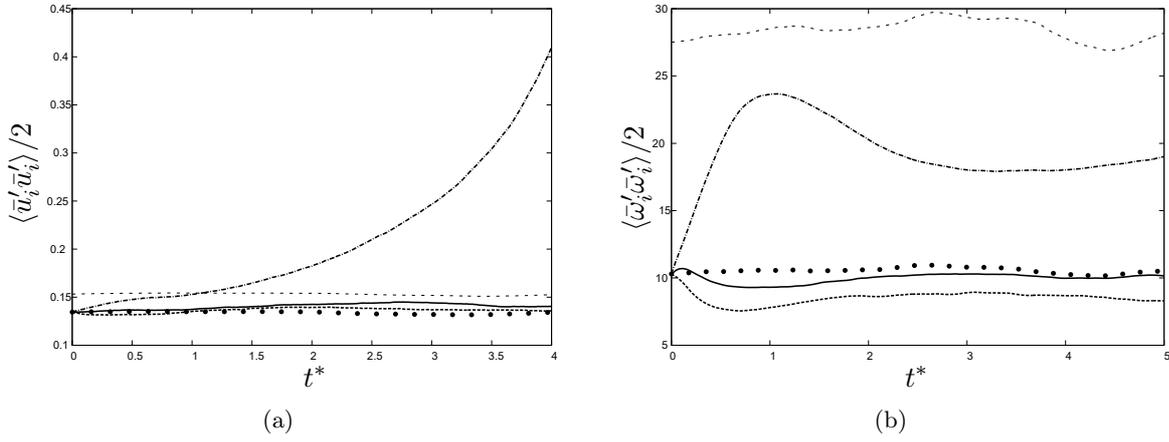
FIGURE 3.21 – Evolution de l'énergie cinétique résolue des champs de vitesse de la THIF avec les modèles sous-maille *DSM* (-----), *DRGM* (—), *GM* (.....) en comparaison avec la *SND* (- - -) et la *SND* filtrée (• •) pour la résolution de  $32^3$  (a). Evolution de l'entropie résolue des champs de vorticit  de la THIF pour les m mes mod les sous-maille dans le cas de la r solution de  $64^3$  (b).
