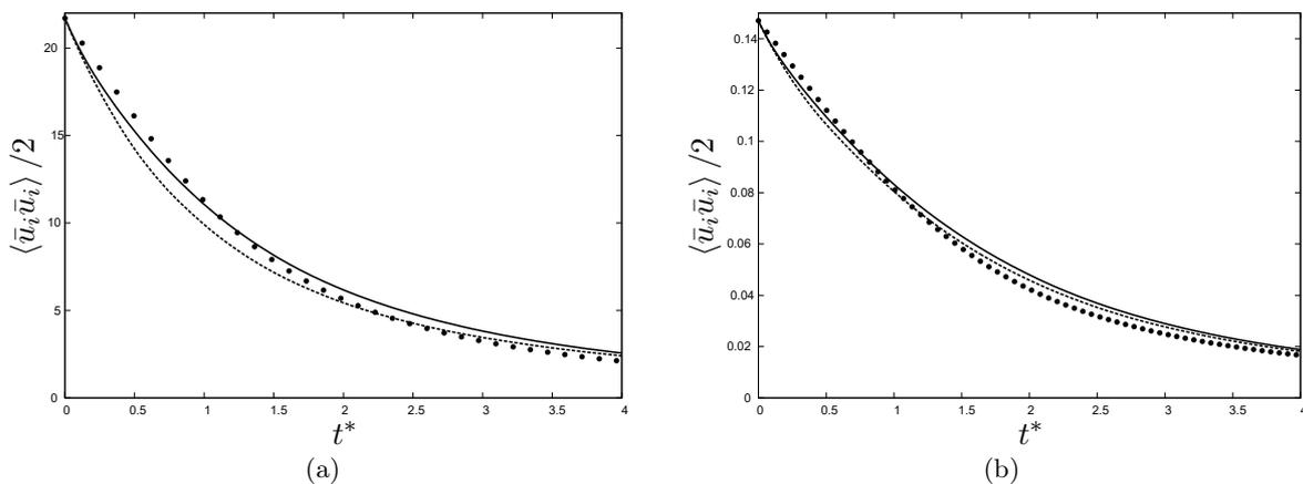
FIGURE 5.23 – Evolution de l'énergie cinétique des champs de vitesse en SGE avec les modèles sous-maille  $ACLNM$  (—)  $DSM$  (-----) et la SND filtrée ( $\bullet$ ) pour les résolutions de  $32^3$  points à  $Re_\lambda = 90$  (a) et  $64^3$  points à  $Re_\lambda = 160$  (b).
