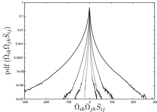
FIGURE 3.12 – Fonctions de densité de probabilité du terme  $\bar{\Omega}_{ik}\bar{\Omega}_{jk}\bar{S}_{ij}$  pour différentes tailles de filtre, calculées *a priori* sur la base de données THI représentée par le spectre 2.2.
