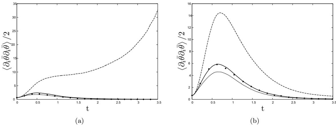
FIGURE 3.27 – Evolution de l'enstrophie des scalaires résolus avec les couples de modèles Smagorinsky dynamique (-----), gradient régularisé (—), gradient (-----) en comparaison avec la SND (---) et la SND filtrée ( $\bullet \bullet$ ) pour les résolutions  $32^3$  (a) et  $64^3$  (b).
