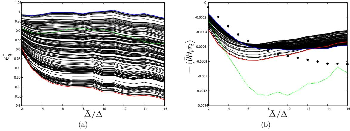
FIGURE 5.3 – Test *a priori* des modèles *ACWM* construits avec les individus du front de Pareto global. (a) : évolution de l'erreur quadratique normalisée. (b) : évolution de la dissipation sous-maille des modèles *ACWM* (—), *DEDM* (---) et de la *SND* filtrée (• •) en fonction de la taille de filtre  $\bar{\Delta}/\Delta$ .
