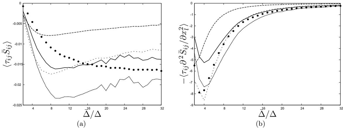
FIGURE 3.15 – Dissipations sous-maillage d'énergie cinétique (a) et d'entrophie (b) des modèles  $GM$  (-----),  $DRGM$  (—),  $MRGM$  (- - -) et  $DSM$  (-----) en comparaison avec la dissipation sous-maillage de la SND filtrée (••) en fonction de la taille de filtre.
