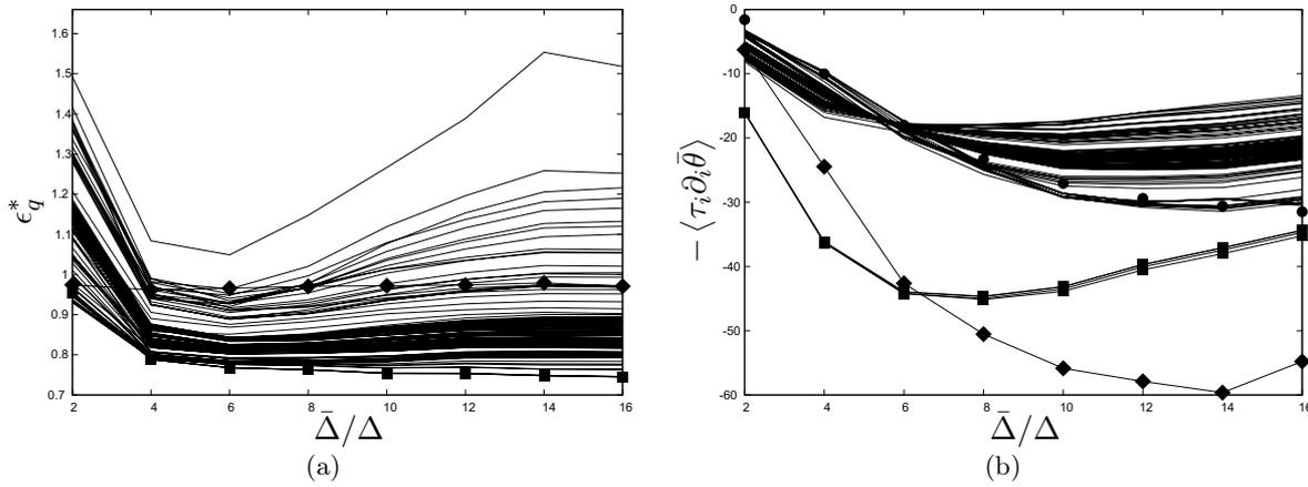
FIGURE 5.22 – Tests *a priori* des modèles *ACLNM* générés par les individus  $\mathbf{p}^{train}$ . (a) Evolution des erreurs quadratiques normalisées. (b) Evolution des dissipations sous-maille en fonction de la taille de filtrage  $\bar{\Delta}/\Delta$  des modèles *DSM* ( $\blacklozenge$ ),  $ACLNM^{inter}$  ( $\blacksquare$ ),  $ACLNM^{train}$  (—) en comparaison avec la *SND* filtrée ( $\bullet \bullet$ ).
