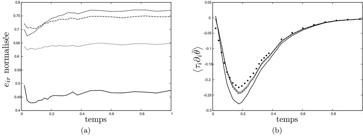
FIGURE 4.5 – Tests *a priori* des variables de conditionnement  $\{\phi\}_k$  à la taille de filtre  $\bar{\Delta}/\Delta = 8$  en fonction du temps pour la décroissance du scalaire.  $M_{1,ij}^*$  (—)  $M_{2,ij}^*$  (-----),  $M_{3,ij}^*$  (.....),  $M_{4,ij}^*$  (-.-.-) et la SND filtrée ( $\bullet \bullet$ ) sur la figure (b) : comparaison des erreurs irréductibles (a) et comparaison des dissipations sous-maille (b).
