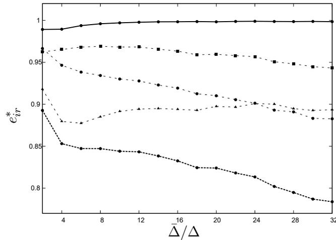
FIGURE 3.13 – Erreurs irréductibles  $e_{ir}^*$  des jeux de variables  $\phi_i^{RGM1}$  (-●-),  $\phi_i^{RGM2}$  (--●--),  $\phi_i^{RGM3}$  (—●—),  $\phi_i^{GM}$  (-▲-) et  $\phi_i^{DSM}$  (-■-) en fonction de la taille de filtre  $\bar{\Delta}/\Delta$ .
