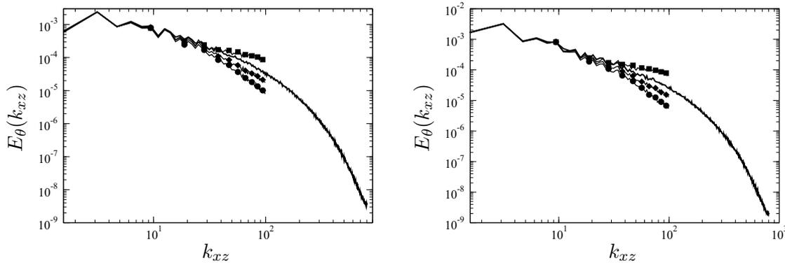
FIGURE 3.11 – Spectres de la variance des scalaires résolus avec les modèles *DSM* ( $\bullet$ ), *DRGM* ( $\blacklozenge$ ) et *GM* ( $\blacksquare$ ) en comparaison avec la SND ( $\text{—}$ ) pour deux instants différents du développement du jet dans les plans  $|y/H| = 0.5$ .
