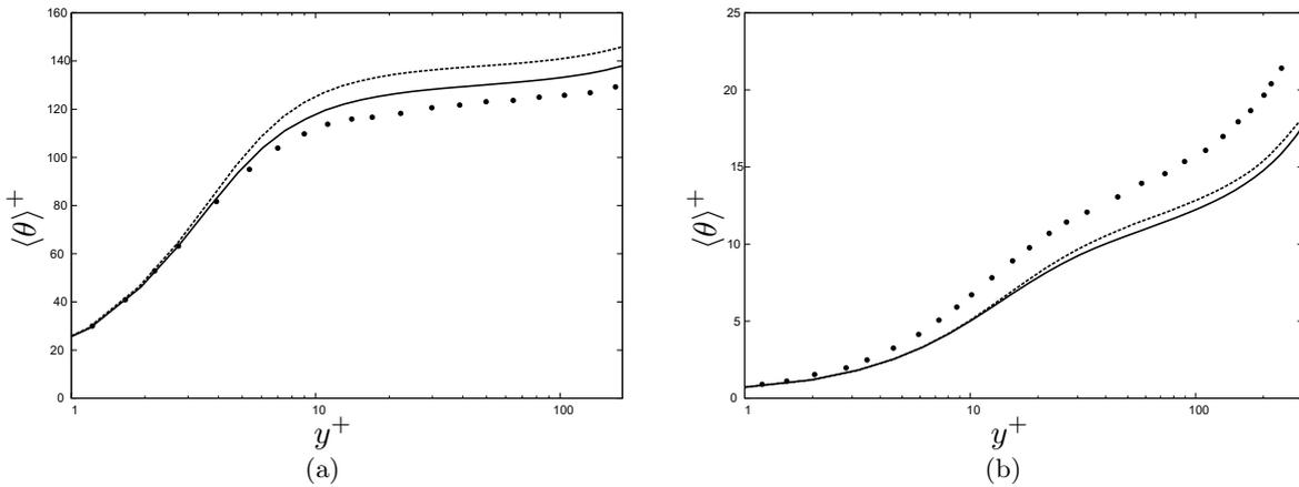
FIGURE 3.29 – Profils de scalaire moyen en fonction de la distance à la paroi en unité de paroi pour les SGE des familles de modèles Smagorinsky dynamique (-----) et gradient régularisé (—) en comparaison avec la SND ( $\bullet \bullet$ ) et de caractéristique  $Re_\tau = 180$  et  $Sc=25$  (a) et  $Re_\tau = 300$  et  $Sc=0.72$  (b)
