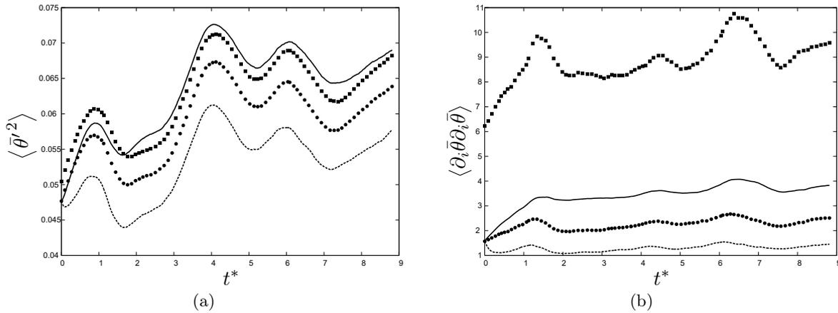
FIGURE 5.15 – Evolution de la variance (a) et de l’entrophie (b) de scalaire résolu pour les SGE des modèles *ACWM* (—), *DEDM* (-----), la SND filtrée (• •) et la SND (■ ■) ( $Re_\lambda = 160$ ,  $N_\theta = 64^3$ ).
