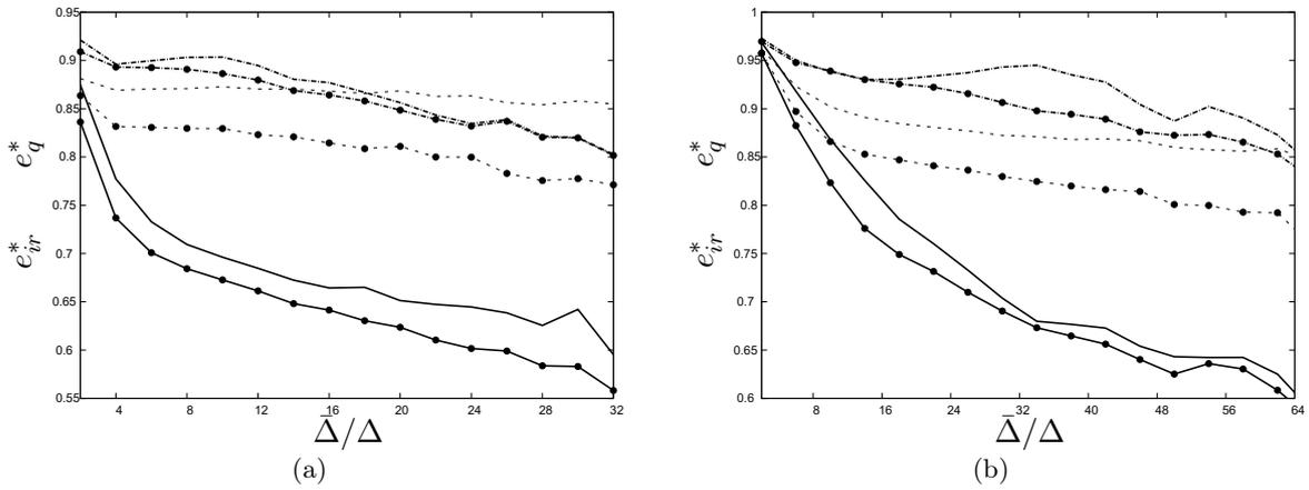
FIGURE 3.4 – Evolution des erreurs quadratiques des modèles *GM* (---), *DSM* (----), *DRGM* (—) et de leurs erreurs irréductibles (• •) pour les bases de données  $Re_\lambda = 160$ ,  $Sc = 0.7$  (a) et  $Re_\lambda = 90$ ,  $Sc = 16$  (b)
