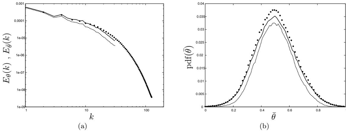
FIGURE 5.12 – Spectre de la variance (a) et densité de probabilité (b) de scalaire des SGE des modèles *ACWM* (—), *DEDM* (-----) et du scalaire de SND ( $\bullet \bullet$ ) sur (a) et de la SND filtrée (b) à  $t^* = 0.62$  ( $Re_\lambda = 90$ ,  $N_\theta = 64^3$ ).
