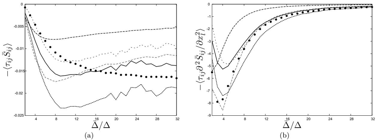
FIGURE A.3 – Dissipations sous-maille d'énergie cinétique (a) et d'entrophie (b) des modèles  $DFS2RGM$  (---),  $GM$  (-----),  $DRGM$  (—) et  $DSM$  (-----) en fonction de la taille de filtre. Les transferts exacts de la SND filtrée sont tracés avec (••).
