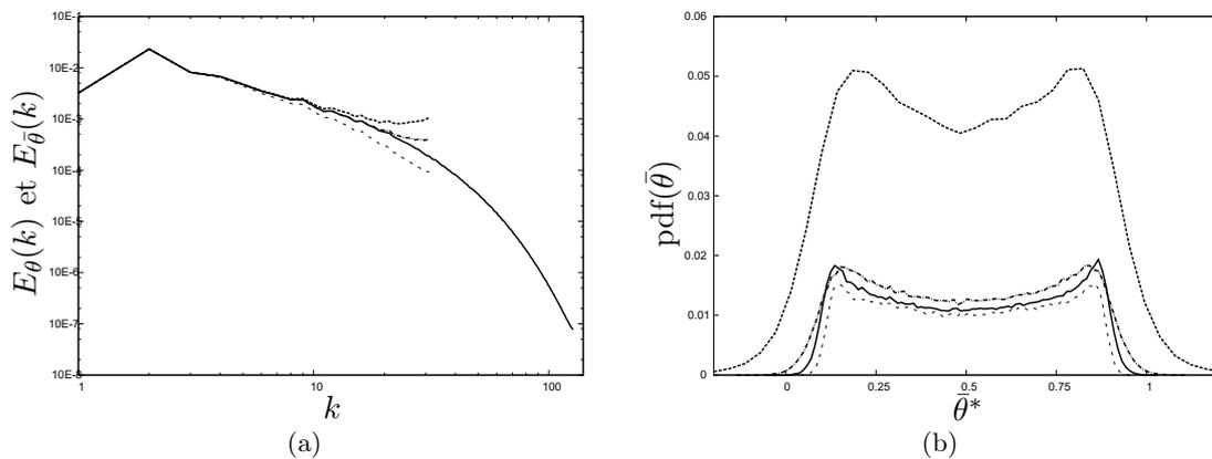
FIGURE 4.17 – Simulation depuis un scalaire initialisé aléatoirement. Spectres (a) et fonction de densité de probabilité (b) pour le scalaire à  $t^* = 0.74$ . *DEDM* (---), *DNTDM* (.....) et *ANNM* (----) comparés à la *SND* (a) et *SND* filtrée (b) (—).
