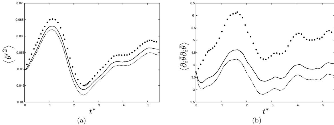
FIGURE 5.13 – Evolution de la variance (a) et de l'enstrophie (b) de scalaire résolu pour les SGE des modèles *ACWM* (—), *DEDM* (-----) et de la *SND* filtrée ( $\bullet \bullet$ ) ( $Re_\lambda = 160, N_\theta = 128^3$ ).
