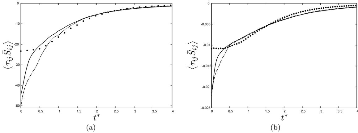
FIGURE 5.24 – Evolution de la dissipation sous-maille de l'énergie cinétique des modèles sous-maille *ACLNM* (—) *DSM* (-----) et la SGE filtrée (• •) pour les résolutions de  $32^3$  points à  $Re_\lambda = 90$  (a) et  $64^3$  points à  $Re_\lambda = 160$  (b).
