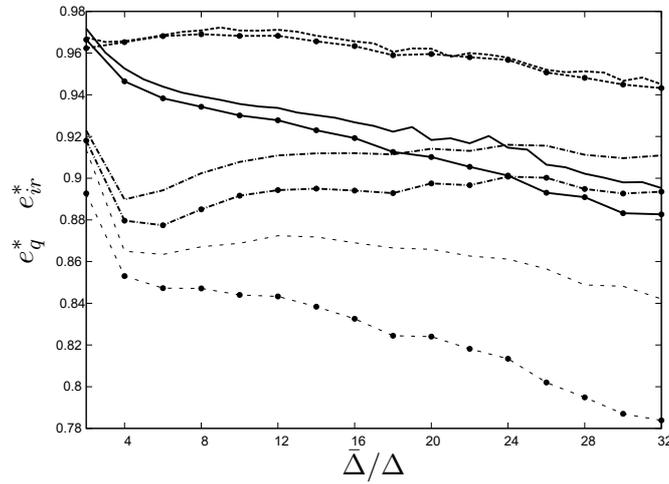
FIGURE 3.14 – Erreurs irréductibles  $e_{ir}^*$  (••) et quadratique  $e_q^*$  des modèles  $GM$  (-----),  $DRGM$  (—),  $MRGM$  (- - -) et  $DSM$  (-----) en fonction de la taille de filtre  $\bar{\Delta}/\Delta$
