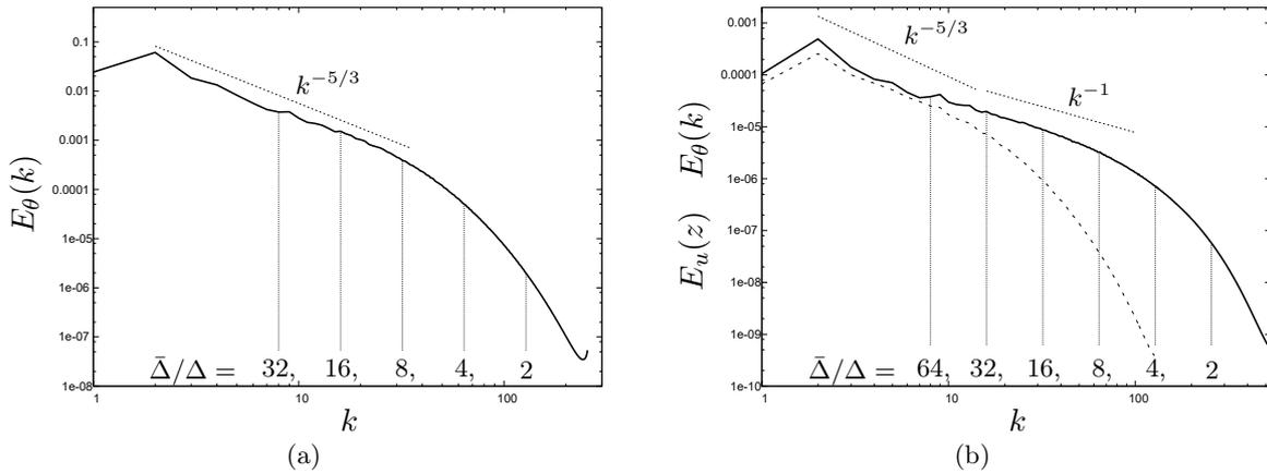
FIGURE 2.3 – Spectres de la variance du scalaire (—) des bases de données  $Re_\lambda = 160$ ,  $Sc = 0.7$  (a) et  $Re_\lambda = 90$ ,  $Sc = 16$  (b) utilisées pour les tests *a priori*. Le spectre d'énergie cinétique (- - -) est également représenté pour la seconde base de données afin d'illustrer la séparation d'échelles. La position des différentes tailles de filtre est également illustrée.
