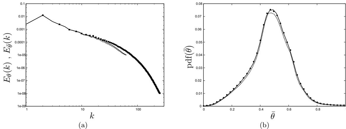
FIGURE 5.14 – Spectre de la variance (a) et densité de probabilité (b) de scalaire des SGE des modèles *ACWM* (—), *DEDM* (-----) et du scalaire de *SND* ( $\bullet \bullet$ ) sur (a) et de la *SND* filtrée sur (b) à  $t^* = 4.59$  ( $Re_\lambda = 160, N_\theta = 128^3$ ).
