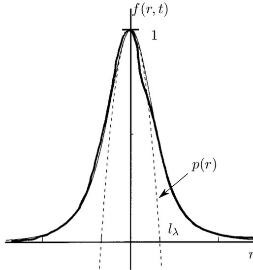
FIGURE 1.2 – Fonction d'autocorrélation longitudinale d'une THI (—) et sa parabole osculatrice  $p(r)$  (- - -) en  $f(0, t)$  où  $p(l_\lambda) = 0$  avec  $l_\lambda$  la longueur caractéristique de Taylor.
