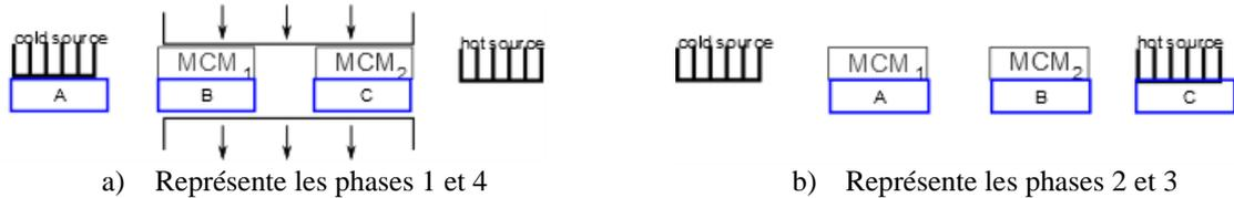
Figure III-10 Exemple de structure avec des échanges indirects
