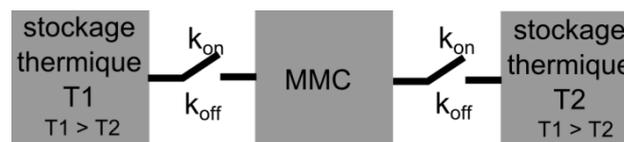
Figure III-15 Contrôle du flux de chaleur avec une diode thermique ou un interrupteur thermique
