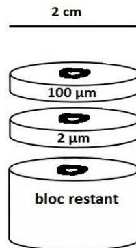
FIGURE I.18 – Découpe des échantillons pour le protocole MMA.
