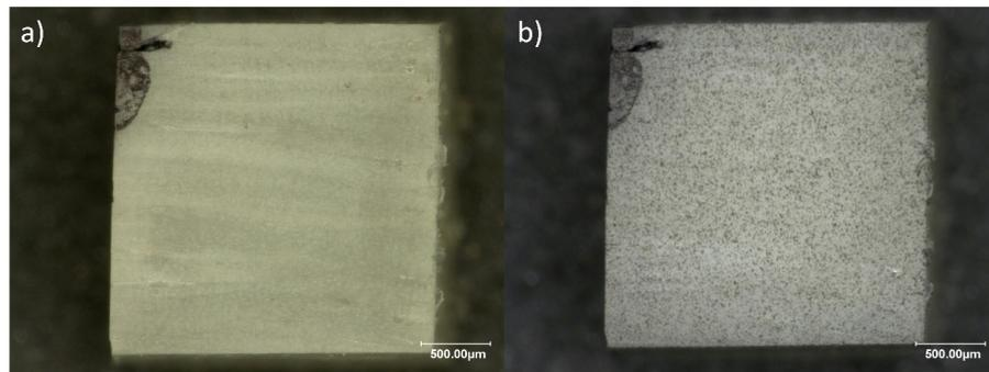
FIGURE III.5 – Préparation de l'échantillon avant compression. a)- Echantillon avant préparation. b)- Echantillon recouvert d'un mouchetis.
