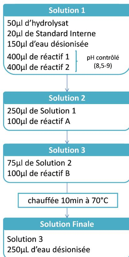
FIGURE II.4 – Protocole de préparation avant dosage par HPLC.
