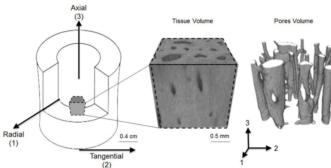
FIGURE II.2 – Découpe d'échantillon d'os en vue de l'évaluation de l'architecture du réseau poreux. Les axes principaux de l'os ont été conservés : radial (1), tangential (2) et axial (3).
