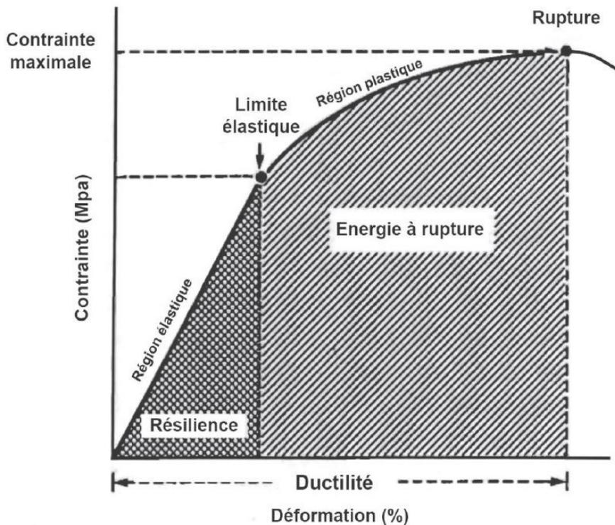
FIGURE I.13 – Courbe contrainte/déformation caractéristique d'un essai de compression.
