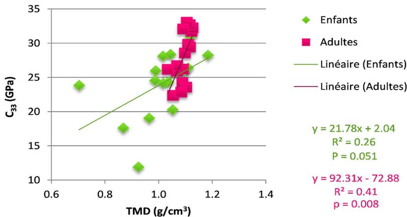
FIGURE IV.2 – Evolution du coefficient de rigidité axial en traction-compression en fonction de la TMD.
