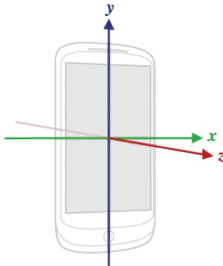
FIGURE 6.1: Système de coordonnées employé pour la mesure d'accélération sur un smartphone
