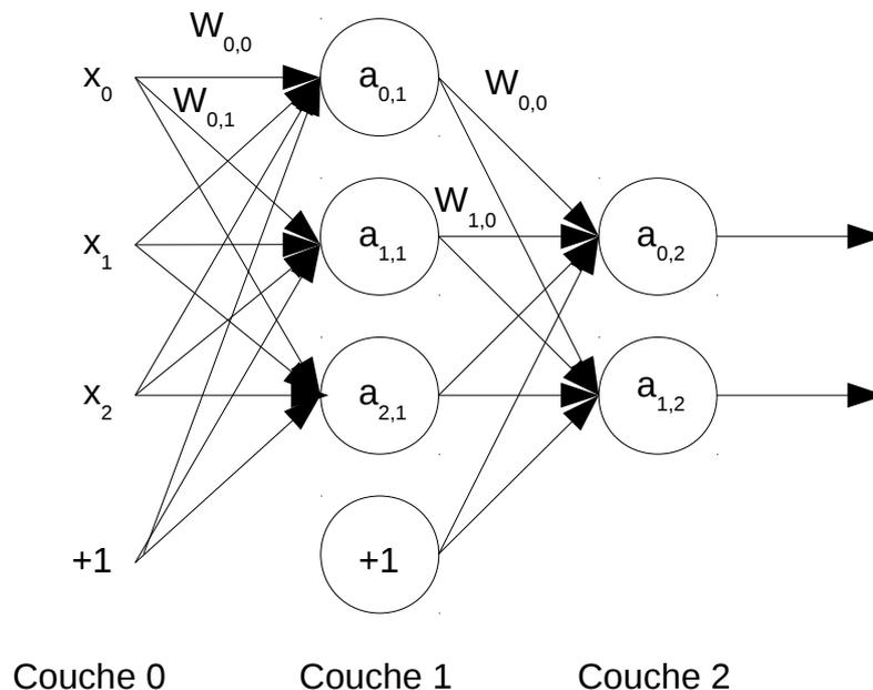
FIGURE 2.7: Illustration d'un réseau de neurones multi-couches
