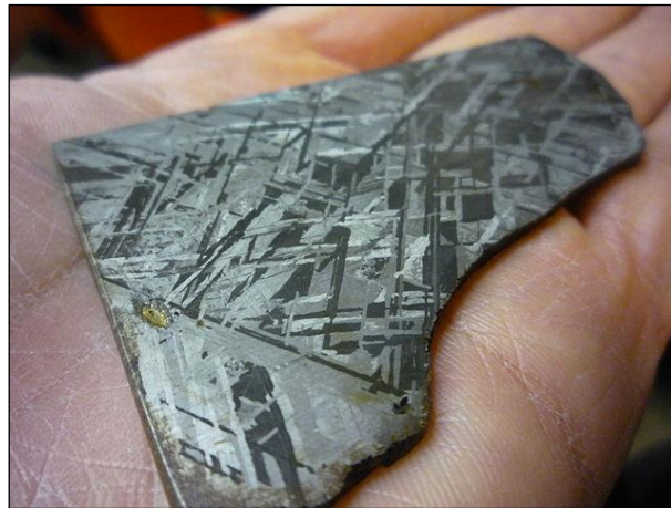
Figure I.22. Coupe transversale d'une météorite qui montre les figures de Widmanstätten.
