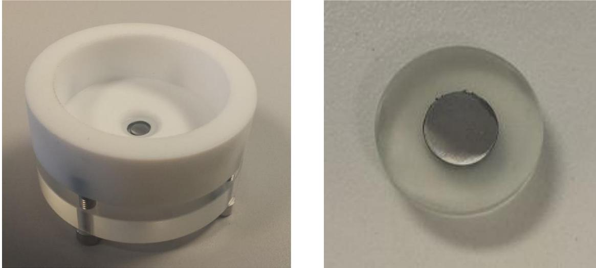
**Figure II.7 :** Cellule électrochimique et électrode de travail utilisées pour les mesures de couplage électrochimie/réflexométrie.
