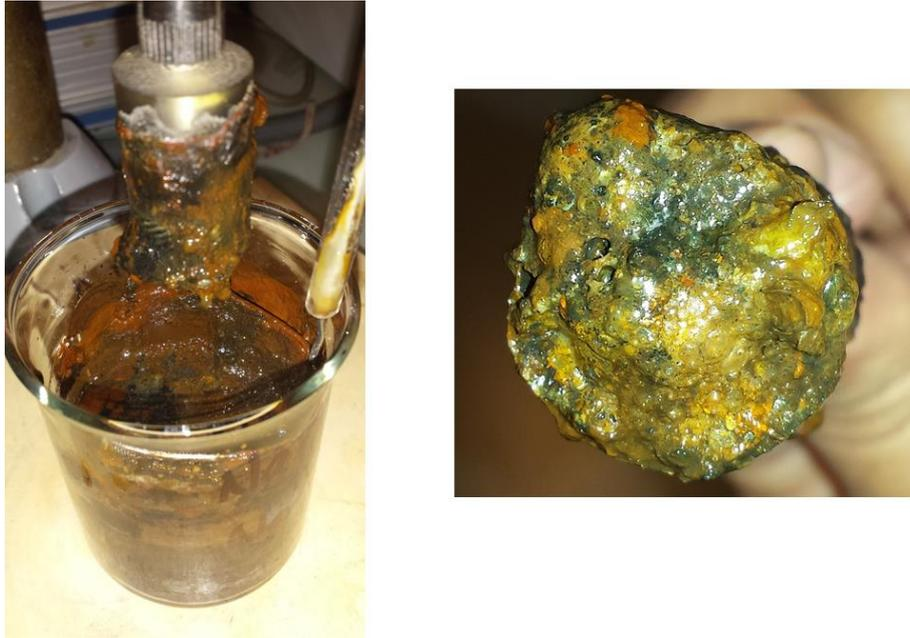
**Figure V.4 :** Photos d'une électrode après le tracé d'une courbe de polarisation anodique dans la solution S4.
