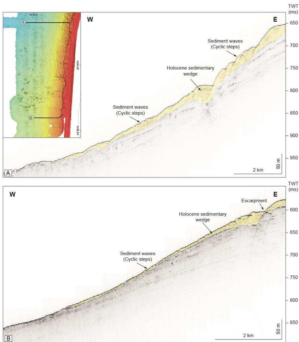
**Figure V-29 :** Profil Chirp illustrant le prisme sédimentaire holocène présent sur le talus moyen à inférieur au niveau de la zone sud. La forte inclinaison du talus du prisme holocène est lié à une migration progressive des *sediment waves* vers le haut du talus en relation avec une accélération des courants de *density cascading* pendant la dernière période interglaciaire (Betzler et al., 2014).
