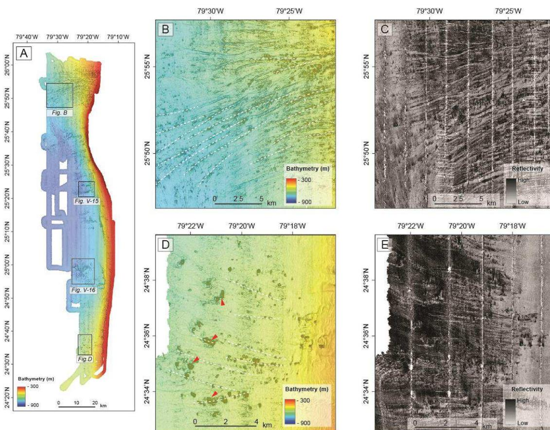
**Figure V-14 :** Physiographie des zones à monts carbonatés présents sur la pente ouest de *Great Bahama Bank*. Les monts carbonatés s'orientent perpendiculairement à la pente, sur les rebords des sillons d'érosion, indiqués par les lignes en pointillées blancs. A) Localisation des différentes zones détaillées; B) Bathymétrie ; C) Imagerie acoustique; D) Bathymétrie ; E) Imagerie acoustique.
