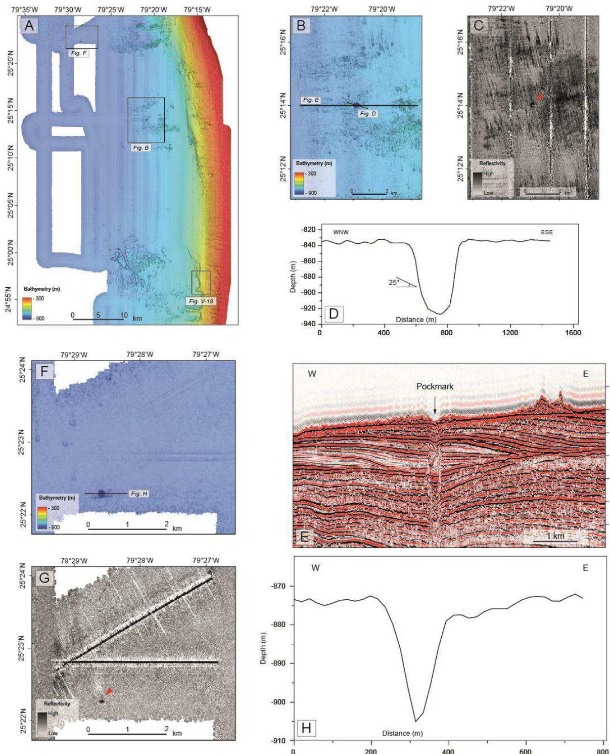
**Figure V-17 (page précédente) : Physiographie des pockmarks isolés.** A) Carte bathymétrique de localisation des différents pockmarks de la zone d'étude ; B) Bathymétrie ; C) Imagerie acoustique ; D) Profil bathymétrique ; E) Profil sismique cross-line (localisation sur la figure B) ; F) Bathymétrie ; G) Imagerie acoustique ; H) Profil bathymétrique.
