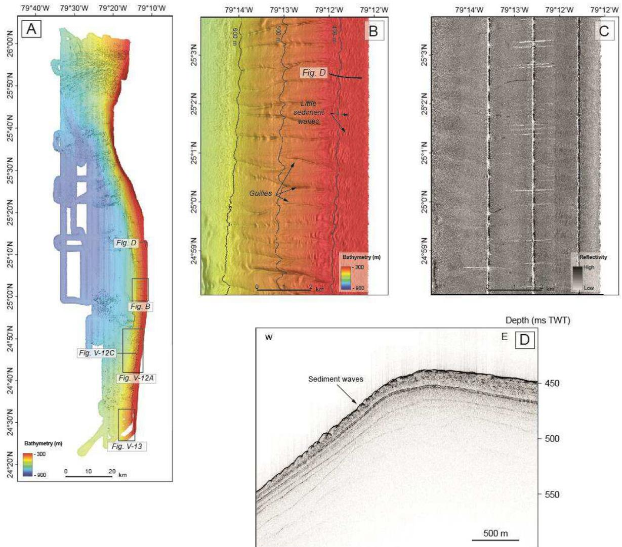
**Figure V-11 :** Physiographie des *sediment waves* dans la partie amont des ravines. A) Carte bathymétrique de localisation des zones de ravines sur le talus moyen ; B) Zoom sur la bathymétrie ; C) Zoom sur l'imagerie acoustique ; D) Profil Chirp (localisation sur la figure A).
