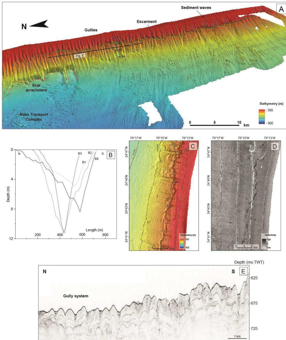
**Figure V-7 :** Physiographie des ravines présentes sur la pente nord-ouest de Great Bahama Bank. A) Carte 3D de la bathymétrie des ravines (page précédente) ; B) Evolution longitudinale des profils bathymétriques transverses d'une ravine (localisation des profils sur la figure A) ; C) Zoom en bathymétrie ; D) Imagerie acoustique ; E) Profil Chirp.
