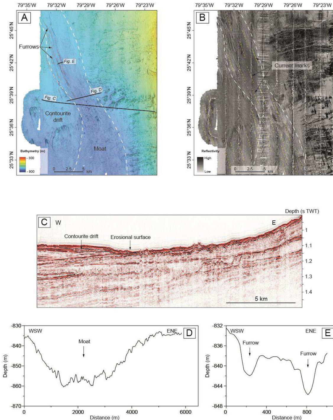
**Figure V-21 :** Physiographie du moat contouritique très marqué dans la partie nord de la zone d'étude. A) Bathymétrie ; B) Imagerie acoustique ; C) Profil SMT en coupe du moat (localisation sur la figure A); D) Profil bathymétrique du moat (localisation sur la figure A); E) Profil bathymétrique des sillons (localisation sur la figure A).
