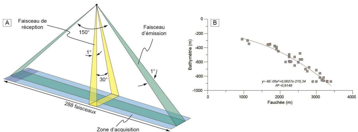
**Figure III-1 :** A) Schéma représentant la technique des faisceaux croisés de l'EM302 (d'après Augustin et al., 1996) ; B) Fauchée en fonction de la profondeur d'eau dans la zone des Bahamas lors de la mission CARAMBAR.
