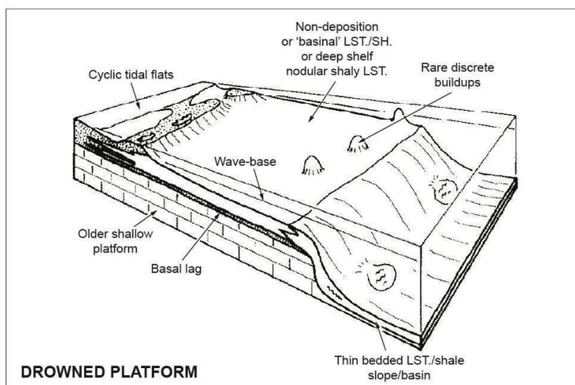
**Figure II-15** : Profil de plate-forme carbonatée ennoyée (Read, 1982).
