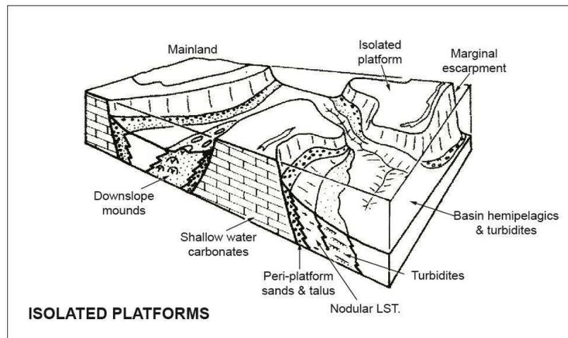
**Figure II-14** : Profil de plate-forme carbonatée isolée (Read, 1982).
