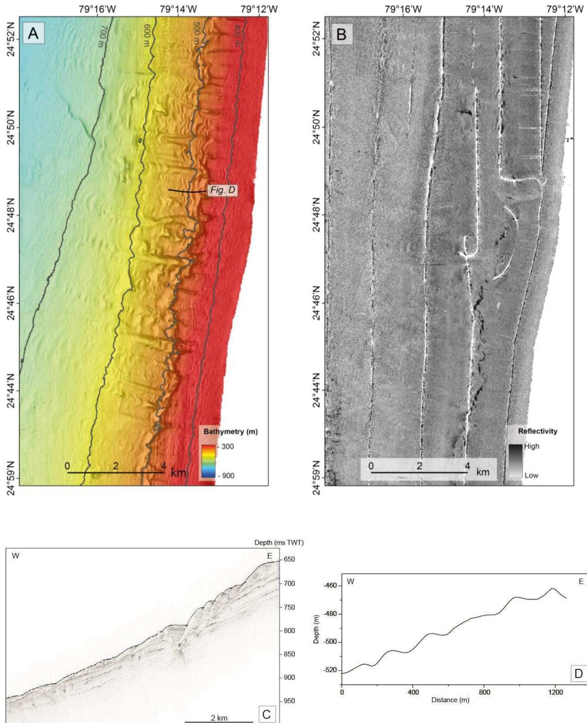
**Figure V-12 :** Physiographie des *sediment waves* en aval de l'escarpement. A) Bathymétrie ; B) Imagerie acoustique ; C) Profil Chirp (localisation sur la figure V-11) ; D) Profil bathymétrique (localisation sur la figure A).
