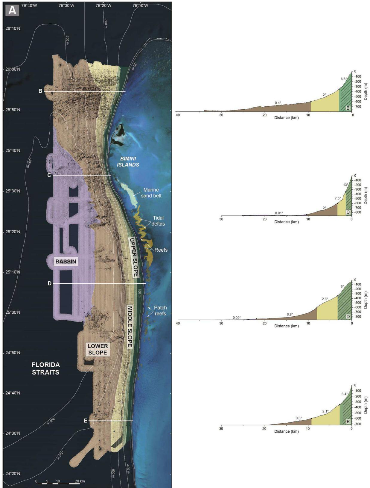
**Figure V-2 :** A) Carte des pentes du talus nord-ouest du Great Bahama Bank indiquant les profils de pente du Nord au Sud; B), C), D) & E) Profils de pente (exagération verticale x12), zone hachurée provenant de données bathymétriques de la NOAA.
