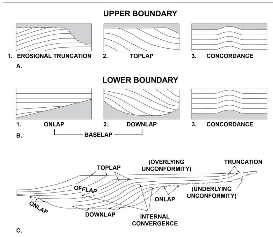
**Figure III-7 (page précédente):** *A) Relations entre les réflexions sismiques et les limites de séquence supérieures ; (B) Relations entre les réflexions sismiques et les limites de séquence inférieures ; (C) Schéma représentant les différentes terminaisons stratigraphiques des réflexions sismiques au sein d'une séquence de dépôt « idéale » (Mitchum et al., 1977).*
