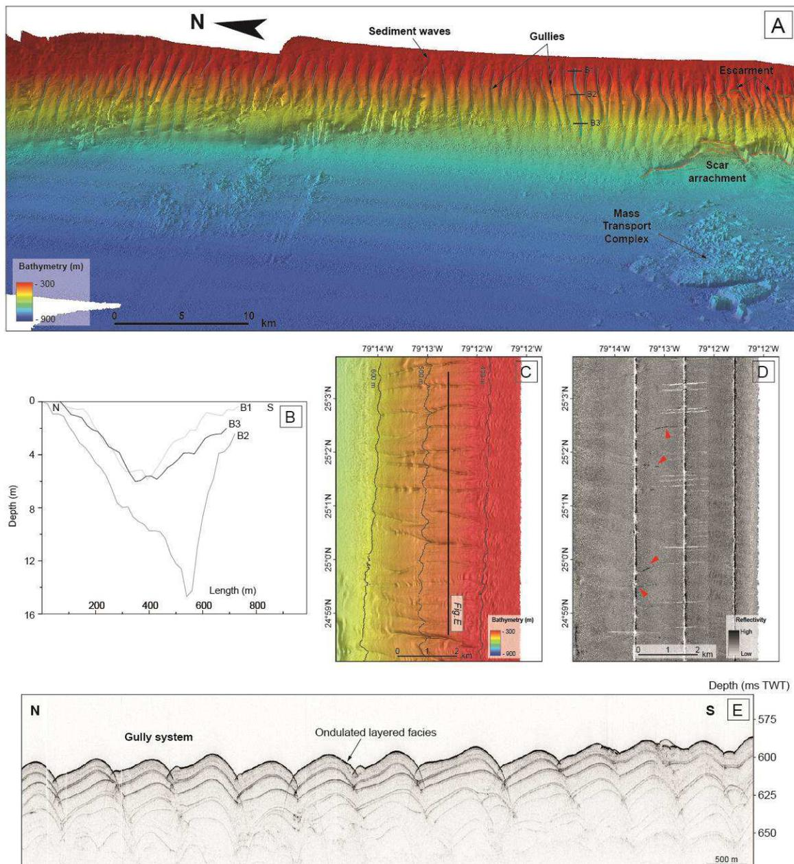
**Figure V-6 :** Physiographie des ravines présentes sur la pente nord-ouest du Great Bahama Bank. A) Carte 3D de la bathymétrie des ravines ; B) Evolution longitudinale des profils bathymétriques transverses d'une ravine (localisation des profils sur la figure A) ; C) Détail bathymétrique ; D) Imagerie acoustique ; E) Profil Chirp.
