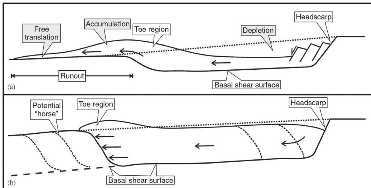
**Figure I-3 :** *Slides émergents frontalement (a) et confinés frontalement (b), (Frey-Martínez et al., 2006).*
