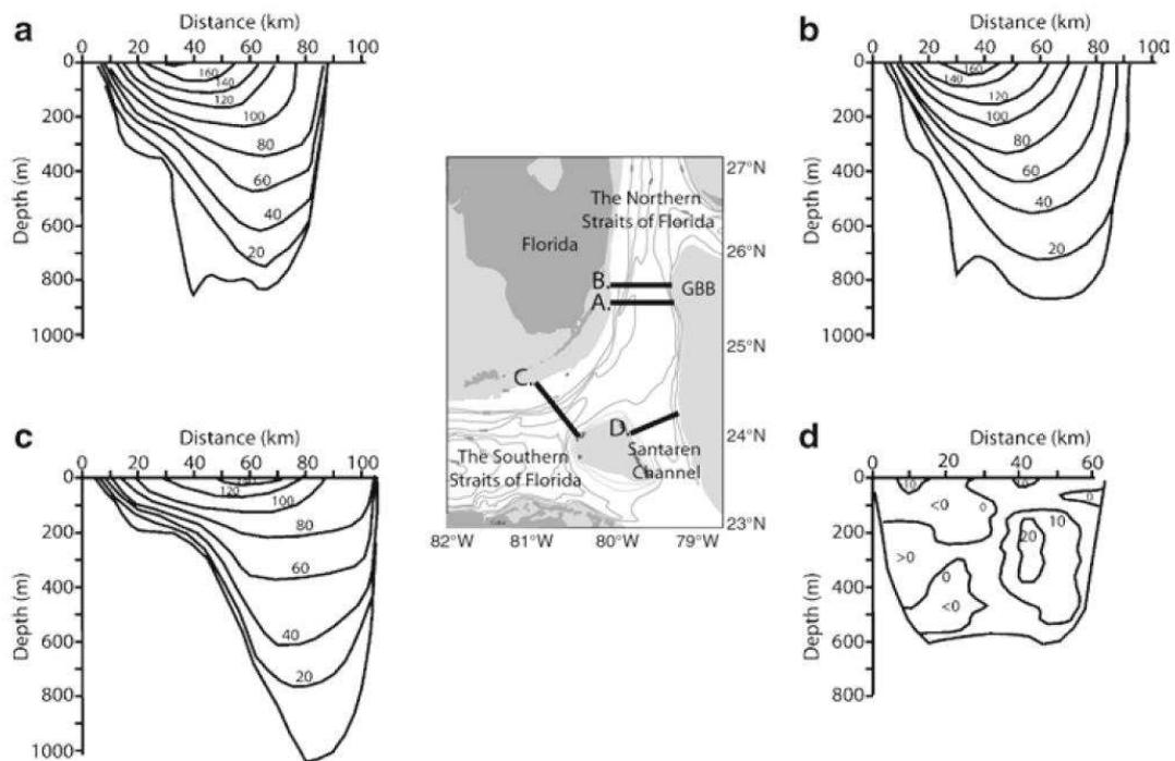
**Figure II-8 :** Coupes transverses du Florida Straits (a-c) et du Santaren Channel (d) indiquant les vitesses de courant en cm/s (Bergman et al. 2010, d'après Richardson et al., 1969).
