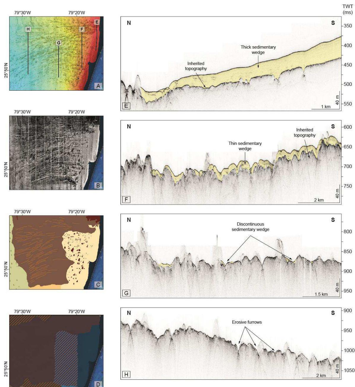
**Figure V-27 :** Carte bathymétrique de la zone nord ; B) Carte de l'imagerie acoustique EM302 ; C) Carte de distribution des faciès d'imagerie acoustique EM302 ; D) Carte de distribution des écho-types E), F), G), H) Profils sismiques Chirp montrant l'évolution d'Est en Ouest du prisme sédimentaire drapant les sillons d'érosion de la zone nord (localisation sur la figure A).
