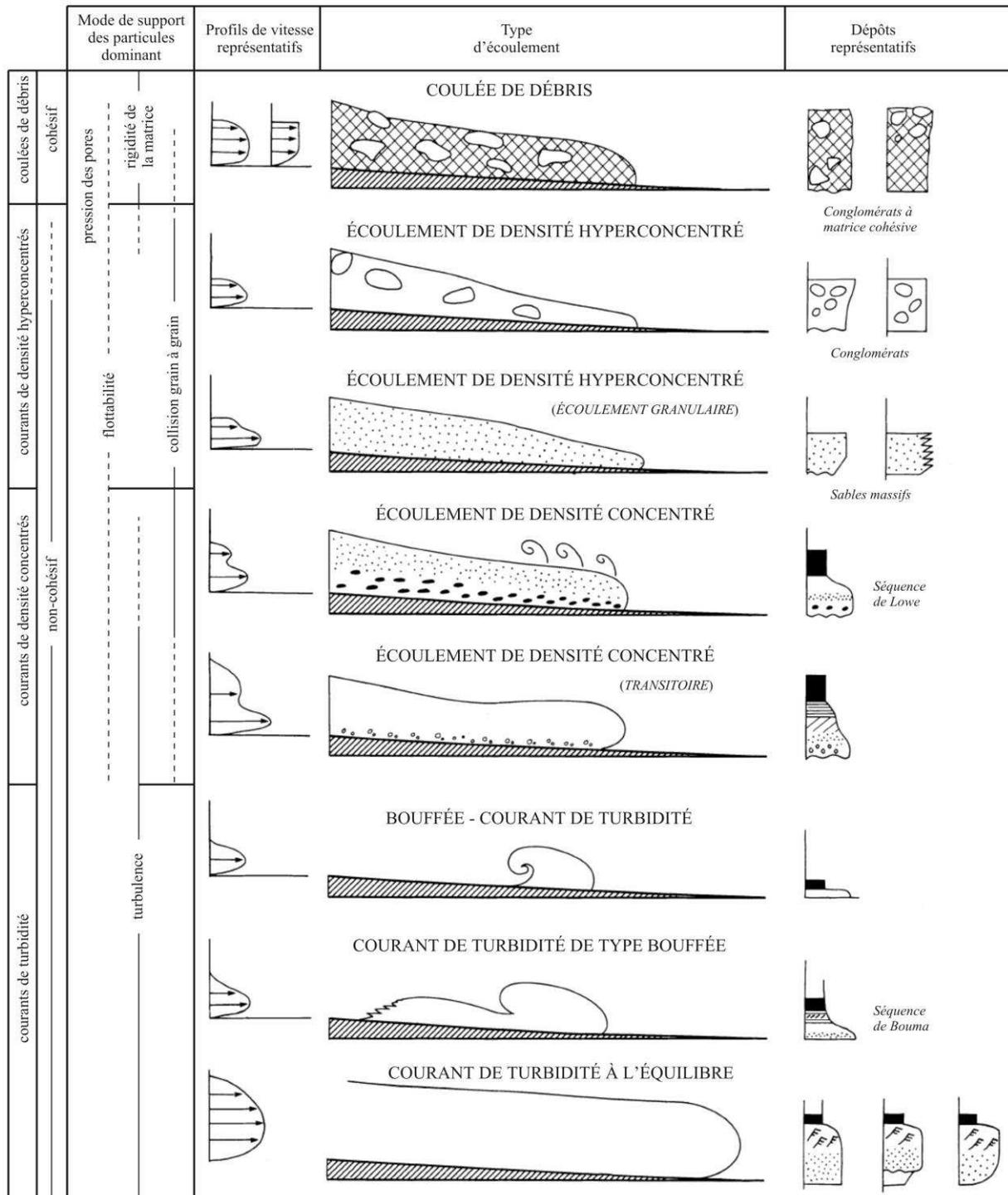
Figure I-4 : Représentation schématique des différents types d'écoulements gravitaires et de leurs dépôts associés (Hanquiez, 2006, d'après Mulder et Alexander, 2001).
