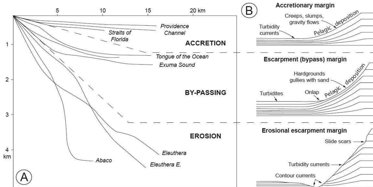
**Figure II-2 :** A. Exemples de profils de pente de talus bahamiens en fonction de leur position géographique par rapport à la mer ouverte (leeward vs. windward) ; B. Coupes schématiques de différentes pentes bahamiennes en accrétion, by-pass et érosion (modifié d'après Schlager et Ginsburg, 1981).
