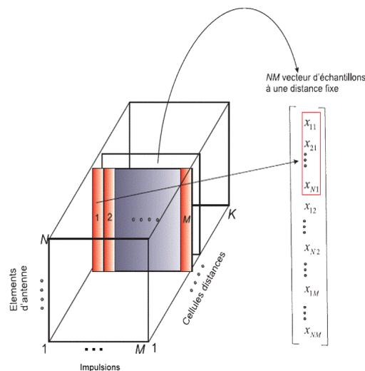
FIGURE 4.3 – Data Cube STAP et arrangement de données.
