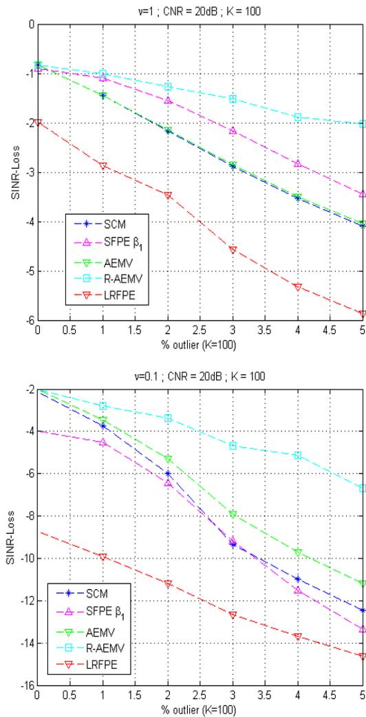
FIGURE 4.16 – SINR-Loss moyen des filtres rang faible construits à partir de différents estimateurs de projecteurs, en fonction du pourcentage de données corrompues  $K = 100$  avec une cible de puissance  $\text{ONR} = 10\text{dB}$  et  $\text{CNR} = 20\text{dB}$ . Haut :  $\nu = 1$ , bas  $\nu = 0.1$ .
