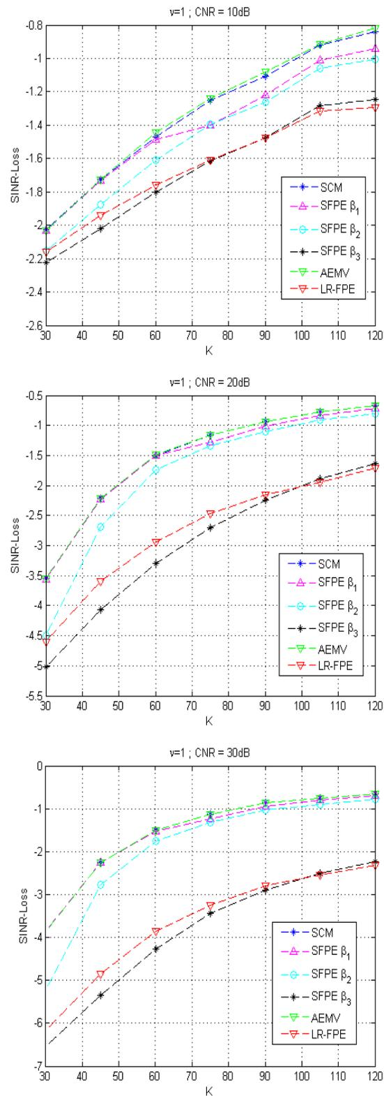
FIGURE 4.14 – SINR-Loss moyen des filtres rang faible construits à partir de différents estimateurs de projecteurs, en fonction de  $K$ . De haut en bas : CNR = 10dB, CNR = 20dB, CNR = 30dB. Fouillis modérément hétérogène  $\nu = 1$ .
