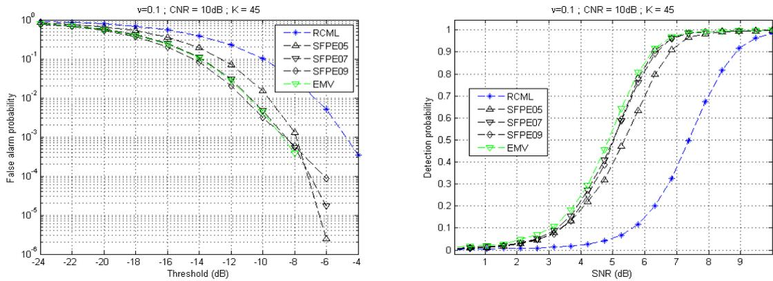
FIGURE 4.9 – Gauche : probabilité de fausse alarme en fonction du seuil. Droite : probabilité de détection en fonction du SNR pour  $\text{PFA}=10^{-3}$ .  $K=3R$ ,  $\nu=0.1$ ,  $\text{CNR}=10\text{dB}$ .
