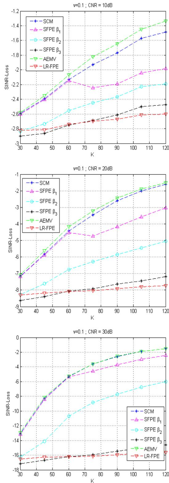
FIGURE 4.15 – SINR-Loss moyen des filtres rang faible construits à partir de différents estimateurs de projecteurs, en fonction de  $K$ . De haut en bas : CNR = 10dB, CNR = 20dB, CNR = 30dB. Fouillis fortement hétérogène  $\nu = 0.1$ .
