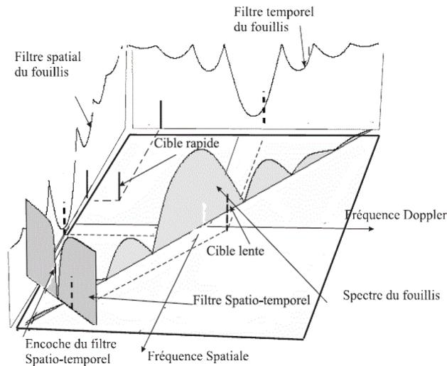
FIGURE 4.1 – Principe et intérêt du filtrage spatio-temporel.
