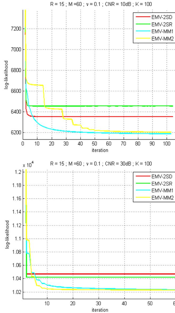
FIGURE 2.1 – Évolution de la vraisemblance négative (valeur opposée de la vraisemblance) en fonction des itérations pour les différents algorithmes "EMV".  $M = 60$ ,  $R = 15$ ,  $K = 100$ ,  $\nu = 1$ . Haut :  $CNR = 10$ , bas :  $CNR = 30dB$ .
