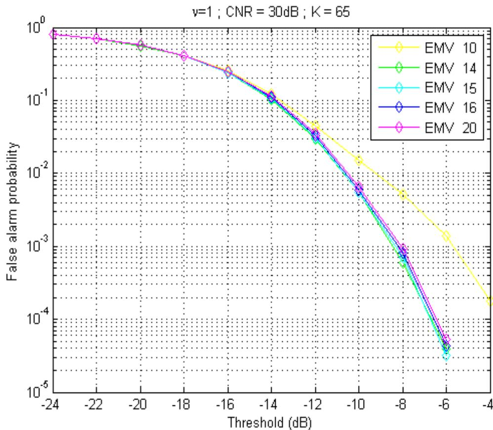
FIGURE 4.10 – Probabilité de fausse alarme en fonction du seuil pour l'estimateur EMV calculé avec différents rangs  $R$  autour de la vraie valeur  $R=15$ .  $K=NM+1$ ,  $\nu=1$ ,  $\text{CNR}=30\text{dB}$ .
