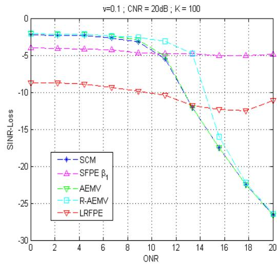
FIGURE 4.17 – SINR-Loss des filtres rang faible construits à partir de différents estimateurs de projecteurs, en fonction de de la puissance de l'outlier pour  $K = 100$ ,  $\nu = 0.1$  et  $\text{CNR} = 20\text{dB}$ .
