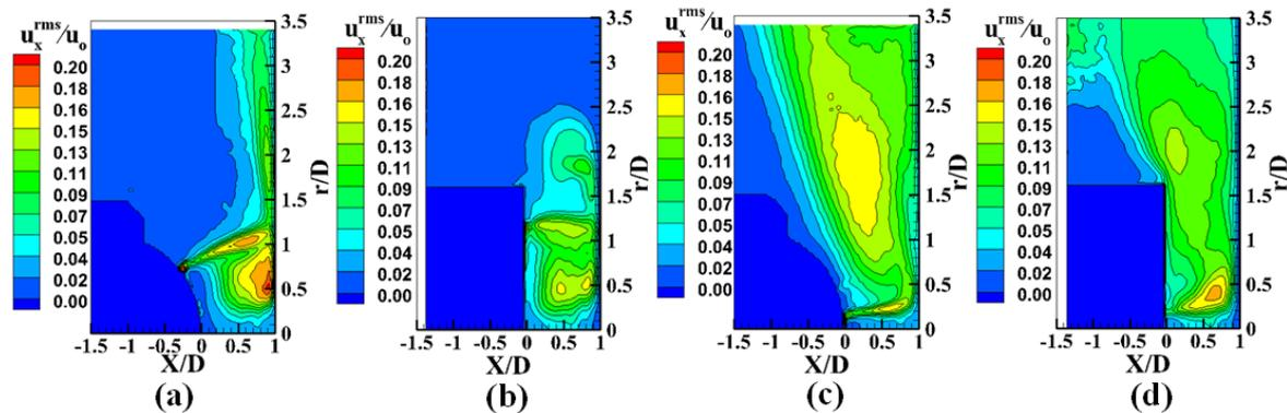
FIGURE 4.45 – Champs de vitesse axiale quadratique de l’injection en croix pour  $H/D = 1$ ,  $Re = 23\,000$  : (a) plan majeur (MP) sur hémisphère, (b) plan majeur (MP) sur plan, (c) plan mineur (mP) sur hémisphère, (d) plan mineur (mP) sur plan
