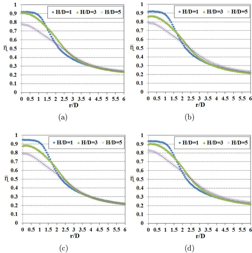
FIGURE B.27 – Distribution radiale de l'efficacité moyenne de l'injection ronde sur hémisphère pour différents nombres de Reynolds : (a)  $Re = 30\,000$ , (b)  $Re = 35\,000$ , (c)  $Re = 40\,000$ , (d)  $Re = 45\,000$
