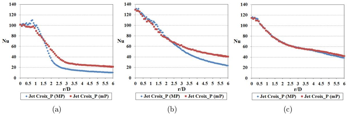
FIGURE 5.12 – Distributions radiales du nombre de Nusselt local de l’injection en croix sur plan pour deux plans majeurs et mineurs avec  $Re = 23\ 000$  : (a)  $H/D = 1$ , (b)  $H/D = 2$ , (c)  $H/D = 5$
