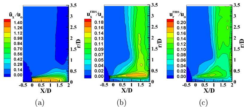
FIGURE B.22 – Champs statistiques de vitesse de l’injection en pétales sur hémisphère pour le plan mineur (mP) avec  $H/D = 2$  : (a) Vitesse moyenne axiale, (b) Vitesse axiale quadratique, (c) Vitesse radiale quadratique
