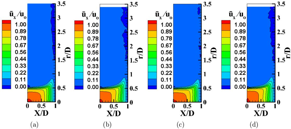
FIGURE 6.1 – Champs de vitesse moyenne axiale de l'injection tubulaire pour  $H/D = 1$  : (a)  $Re = 120\ 000$ ,  $M = 0.76$ , (b)  $Re = 120\ 000$ ,  $M = 0.34$ , (c)  $Re = 150\ 000$ ,  $M = 0.9$ , (d)  $Re = 150\ 000$ ,  $M = 0.42$
