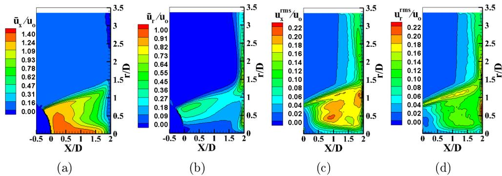
FIGURE B.11 – Champs statistiques de vitesse de l’injection en croix sur hémisphère pour le plan majeur (MP) avec  $H/D = 2$  : (a) Vitesse moyenne axiale, (b) Vitesse moyenne radiale (c) Vitesse axiale quadratique, (d) Vitesse radiale quadratique
