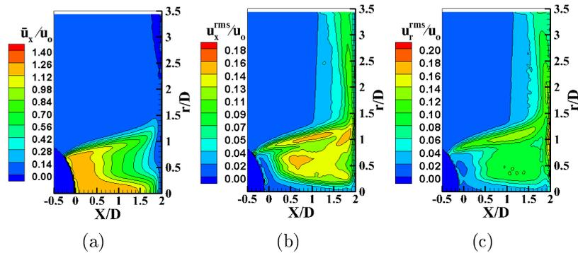
FIGURE B.21 – Champs statistiques de vitesse de l’injection en pétales sur hémisphère pour le plan majeur (MP) avec  $H/D = 2$  : (a) Vitesse moyenne axiale, (b) Vitesse axiale quadratique, (c) Vitesse radiale quadratique
