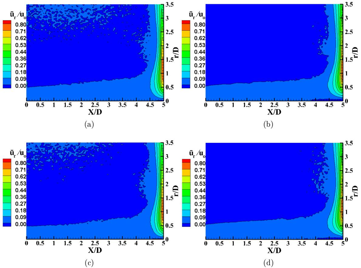
FIGURE 6.7 – Champs de vitesse moyenne radiale de l’injection tubulaire pour  $H/D = 5$  : (a)  $Re = 120\,000$ ,  $M = 0.76$ , (b)  $Re = 120\,000$ ,  $M = 0.34$ , (c)  $Re = 150\,000$ ,  $M = 0.9$ , (d)  $Re = 150\,000$ ,  $M = 0.42$
