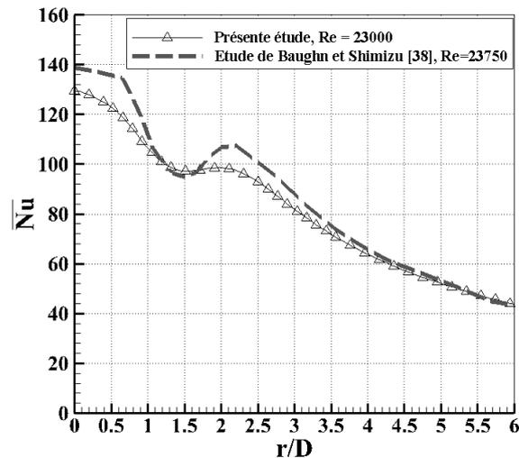
FIGURE 5.10 – Comparaison de la variation du nombre de Nusselt de la présente étude à celle de Baughn et Shimizu [38] pour l'injection ronde sur plan avec  $H/D = 2$
