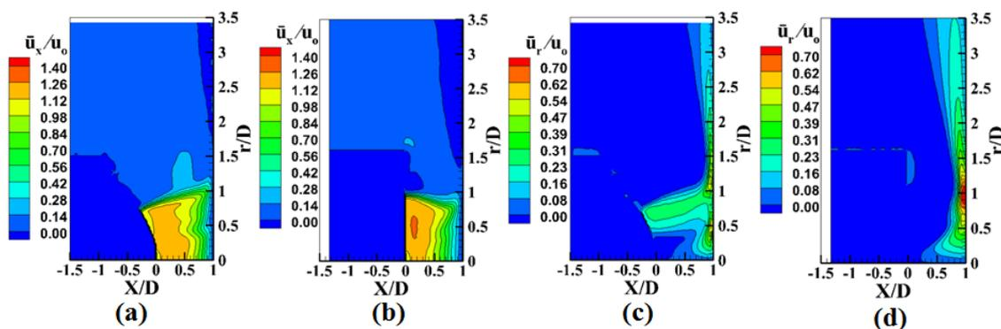
FIGURE 4.50 – Champs de vitesse moyenne de l'injection en pétales au plan majeur pour  $H/D = 1$ ,  $Re = 23\,000$  : (a) vitesse axiale sur hémisphère, (b) vitesse axiale sur plan, (c) vitesse radiale sur hémisphère, (d) vitesse radiale sur plan
