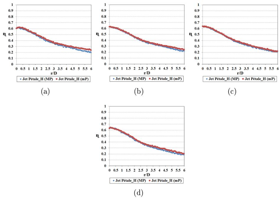
FIGURE B.39 – Distribution radiale de l'efficacité de l'injection en pétales sur hémisphère pour  $H/D = 5$  avec deux plans majeur et mineur : (a)  $Re = 30\ 000$ , (b)  $Re = 35\ 000$ , (c)  $Re = 40\ 000$ , (d)  $Re = 45\ 000$
