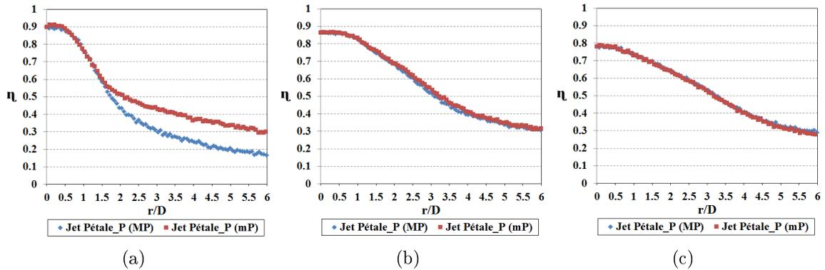
FIGURE 5.23 – Distributions radiales de l'efficacité locale de l'injection en pétales sur plan pour deux plans majeurs et mineurs avec  $Re = 23\ 000$  : (a)  $H/D = 1$ , (b)  $H/D = 2$ , (c)  $H/D = 5$
