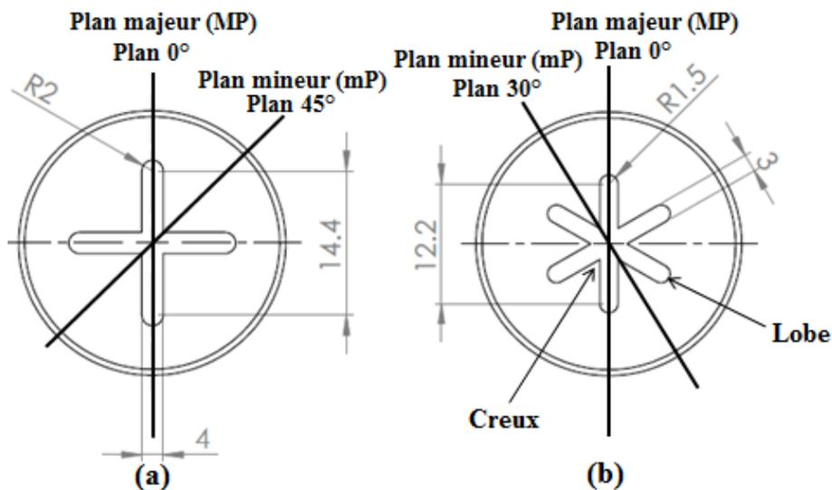
FIGURE 4.6 – Différents plans de l'injection sur plan : (a) Injection en «croix», (b) Injection en «pétales»
