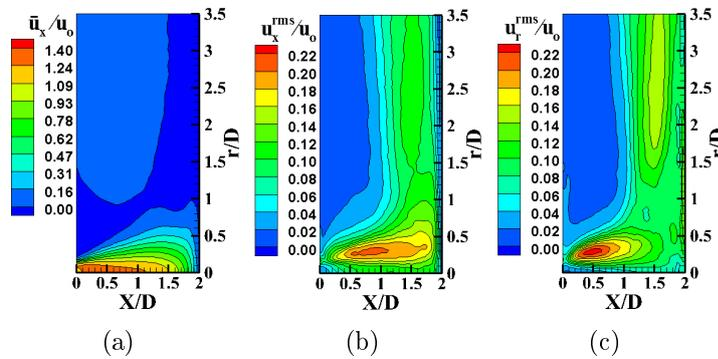
FIGURE B.7 – Champs statistiques de vitesse de l’injection en croix sur plan pour le plan mineur (mP) avec  $H/D = 2$  : (a) Vitesse moyenne axiale, (b) Vitesse axiale quadratique, (c) Vitesse radiale quadratique
