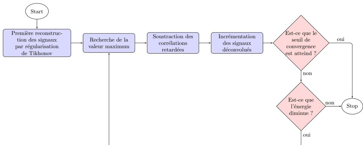
FIGURE 2.40 – Diagramme de l'algorithme itératif de déconvolution.
