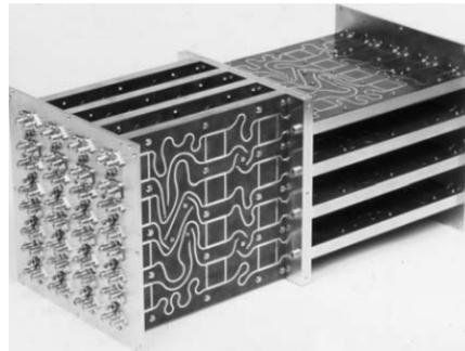
(b) Association de matrices de Butler à 64 ports de sortie permettant un balayage en azimut et en élévation [21].
