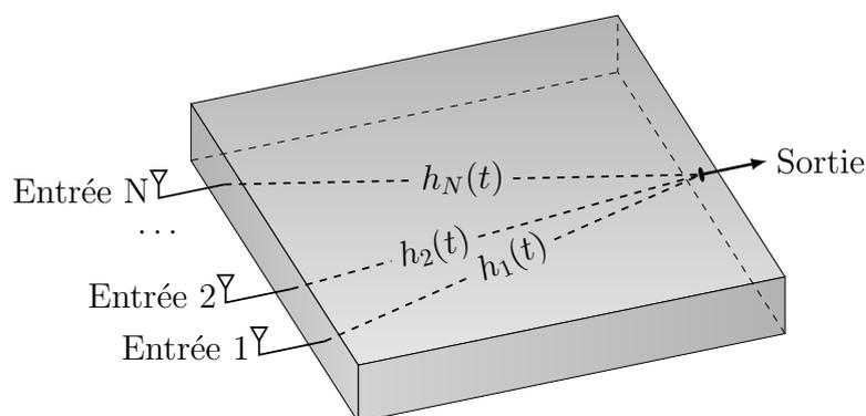
FIGURE 3.1 – Schéma équivalent du composant compressif étudié
