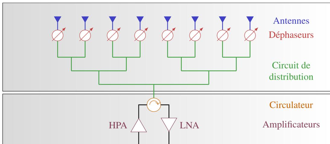
FIGURE 1.10 – Architecture distribuée de commande d'antennes : on distingue la partie du bas assurant génération et réception des ondes de celle du haut permettant la formation de faisceaux.
