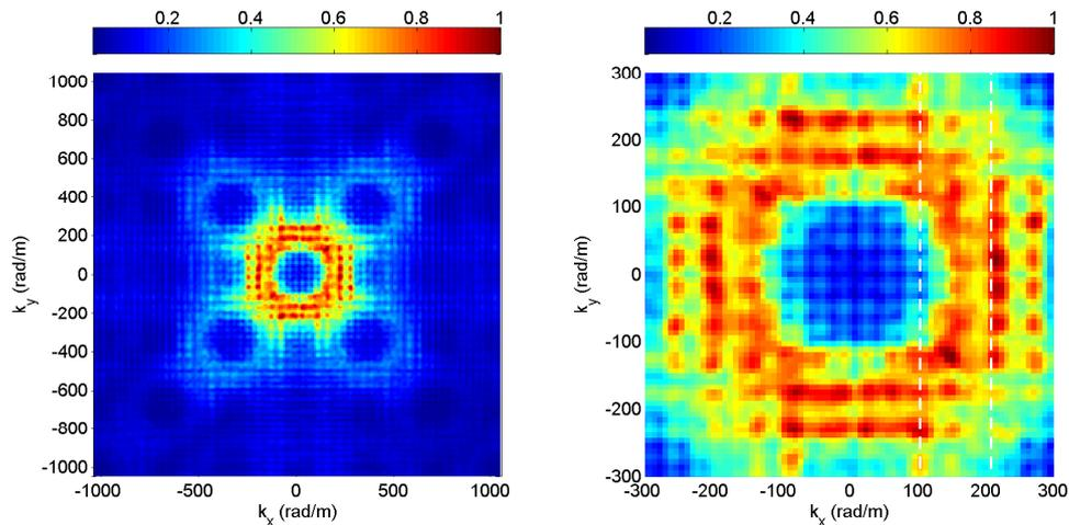
FIGURE 2.18 – Somme fréquentielle des modes établis dans la cavité et zoom sur la zone de plus forte intensité. Les traits pointillés représentent les nombres d'onde  $k_{min}$  et  $k_{max}$  théoriques.
