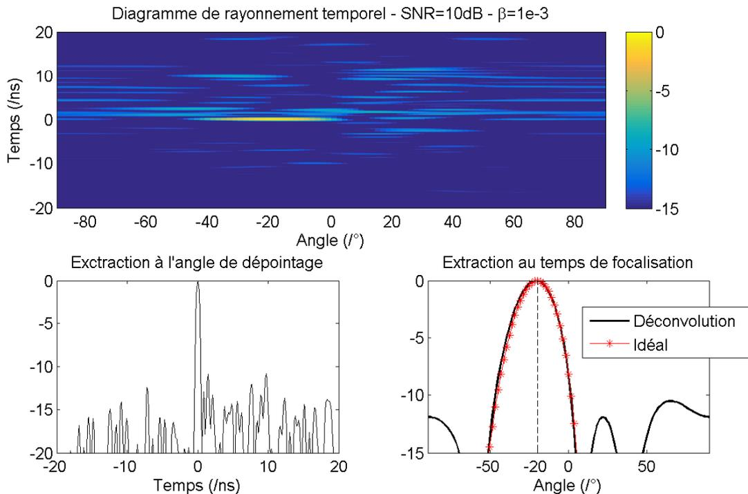
FIGURE 2.28 – Formation de faisceaux réalisée dans la direction  $\theta = -20^\circ$ , pour un  $SNR = -10dB$  et un paramètre de régularisation  $\beta = 10^{-3}$ . Le diagramme extrait au temps de focalisation est comparé avec celui d'un cas équivalent idéal sans compression.
