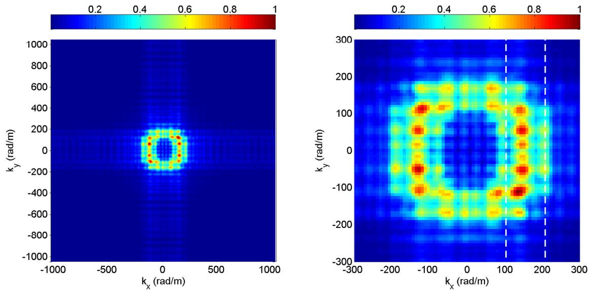
FIGURE 2.9 – Somme fréquentielle des modes établis dans la cavité et zoom sur la zone de plus forte intensité. Les traits pointillés représentent les nombres d’onde  $k_{min}$  et  $k_{max}$  théoriques.
