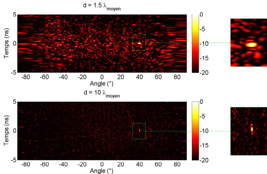
FIGURE B.8 – Illustration de l'impact de l'espacement entre éléments rayonnants sur le niveau moyen des lobes de réseau pour un pointage de  $40^\circ$  du faisceau formé.
