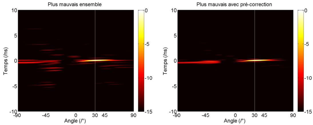
FIGURE 2.68 – Formation de faisceau réalisée dans la direction  $30^\circ$  à partir de signaux compressés par le moins bon ensemble de canaux, sans et avec la méthode de correction de la matrice de corrélation.
