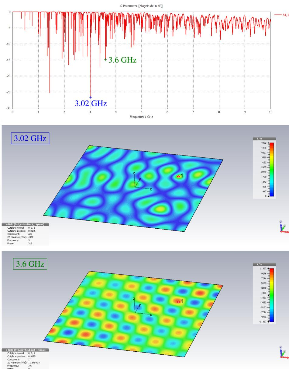
FIGURE 2.7 – Cavité régulière 2D simulée sous CST. La puissance du signal réfléchi à l'entrée du composant  $S_{11}(f)$  permet de déterminer les modes excités en fonction de la fréquence. La flèche rouge correspond au port discret réalisant l'excitation.
