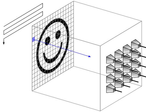
FIGURE 1.23 – Mesure de la réflexion d’une cible par un réseau d’antennes pour le calcul d’image radar. Une approche conventionnelle basée sur l’algorithme *Delay-and-sum* consiste à reconstruire l’image voxel par voxel en re-propageant le champ.
