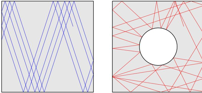
FIGURE 2.50 – Comparaison de la propagation d’un rayon dans une cavité régulière et dans une cavité chaotique, partant du même état initial.
