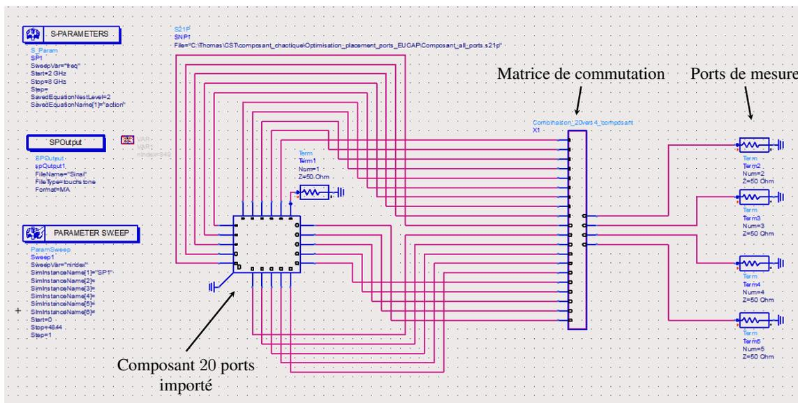
FIGURE 2.60 – Simulation réalisée avec ADS permettant d’extraire les paramètres S de chaque combinaison de 4 ports du composant.
