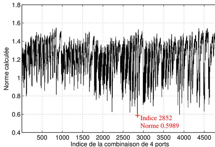
FIGURE 2.62 – Valeur de la norme calculée pour l'ensemble des combinaisons possibles de 4 ports connectés au composant.
