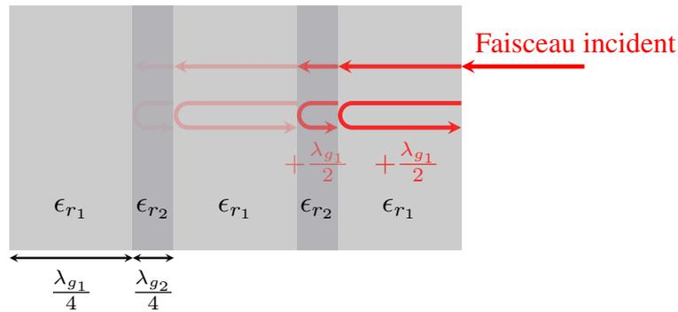
FIGURE 2.14 – Structure périodique 1D dimensionnée de façon à créer une bande interdite à la fréquence d’étude.
