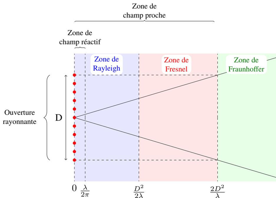
FIGURE 1.5 – Définition des zones de champ électromagnétique en fonction de la taille de l'ouverture et de la distance au plan rayonnant.
