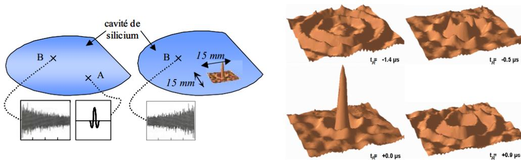
FIGURE 2.48 – Caractérisation de la réponse impulsionnelle acoustique entre deux points d'une cavité chaotique 2D en silicium et focalisation par émission de la réponse enregistrée retournée temporellement. [62]
