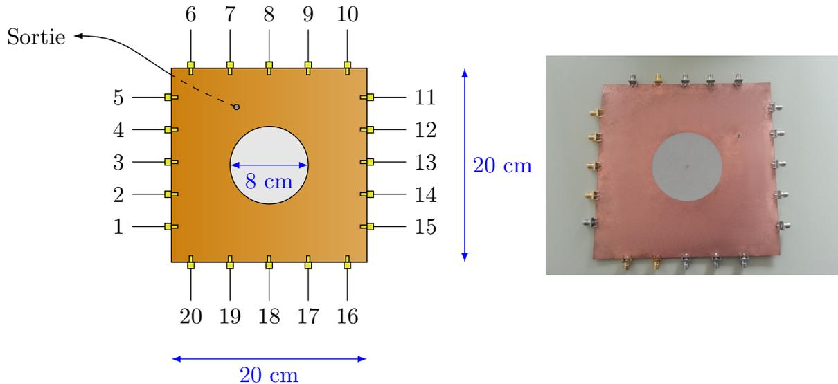
FIGURE B.1 – Composant chaotique 2D à 20 accès et une sortie commune.
