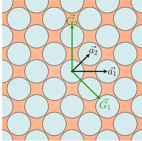
FIGURE 2.12 – Motif cubique face centrée gravé sur le composant compressif. Les vecteurs de translation du motif ( $\vec{a}_1, \vec{a}_2$ ) et ceux du réseau réciproque ( $\vec{G}_1, \vec{G}_2$ ) sont représentés. Les parties grises correspondent aux zones dé-métallisées, créant des ruptures d'impédance périodiques dans la propagation.
