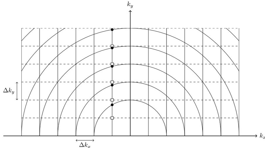
FIGURE 1.9 – Interpolation de Stolt dans le plan  $(k_x, k_y)$  permettant de réduire la quantité d'opérations nécessaires à l'obtention d'une image radar. Les disques noirs représentent les valeurs initiales et les carrés blancs, les valeurs interpolées.
