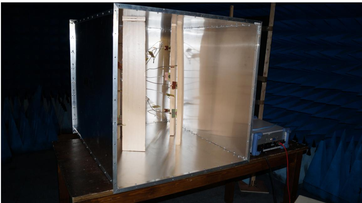
FIGURE 4.26 – Nouveau prototype relié à des sondes ultra large bande.
