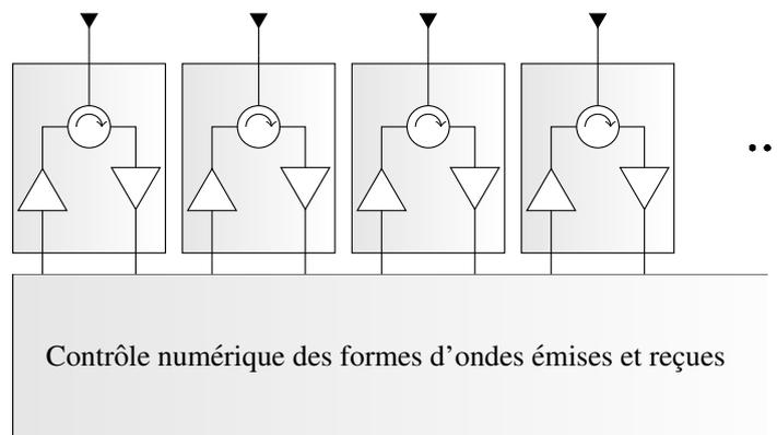
FIGURE 1.19 – Architecture à multiples émetteurs-récepteurs contrôlés numériquement.
