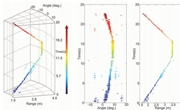
FIGURE 1.37 – Reconstruction de la position d’une cible à surface équivalente radar isotrope en temps réel [43].
