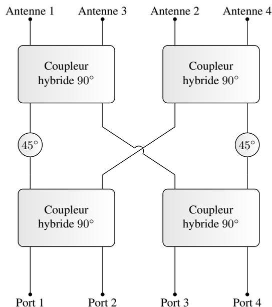
FIGURE 1.17 – Schéma équivalent d'une matrice de Butler.
