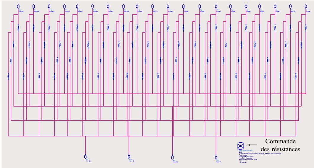
FIGURE 2.61 – Matrice de commutation reliant les 20 ports du composant compressif à 4 ports de mesure  $50 \Omega$ . Les valeurs des résistances sont commandées de façon à sélectionner un ensemble différent à chaque itération du programme.
