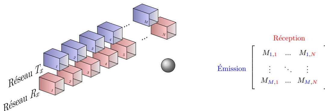
FIGURE 4.1 – Système bistatique linéaire et matrice d'interaction équivalente
