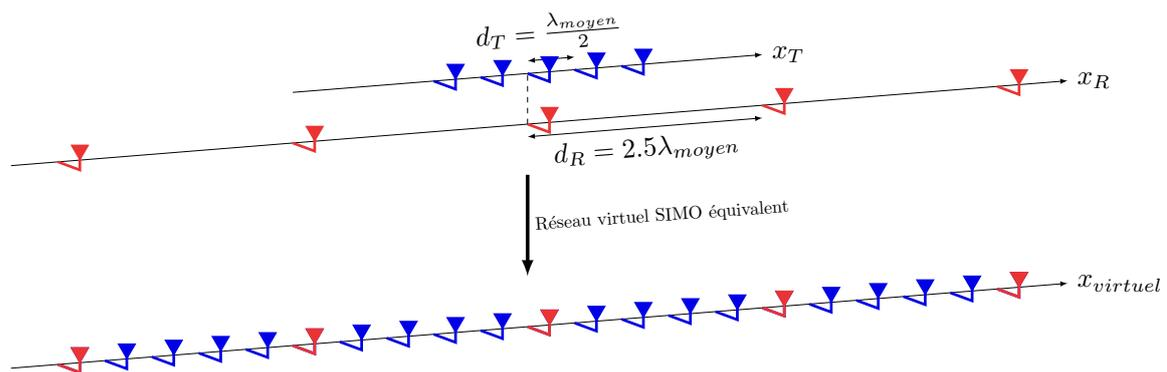
FIGURE 4.3 – Réseau bistatique d'antennes isotropes simulé avec Matlab
