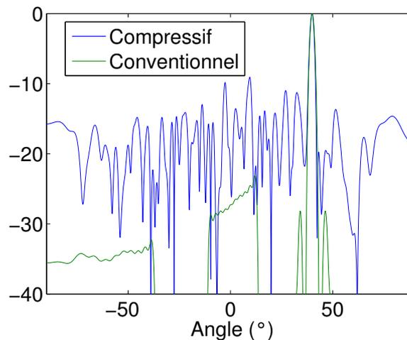
FIGURE B.7 – Comparaison des diagrammes de rayonnement extraits aux instants de focalisation dans les cas conventionnel et compressif étudiés.
