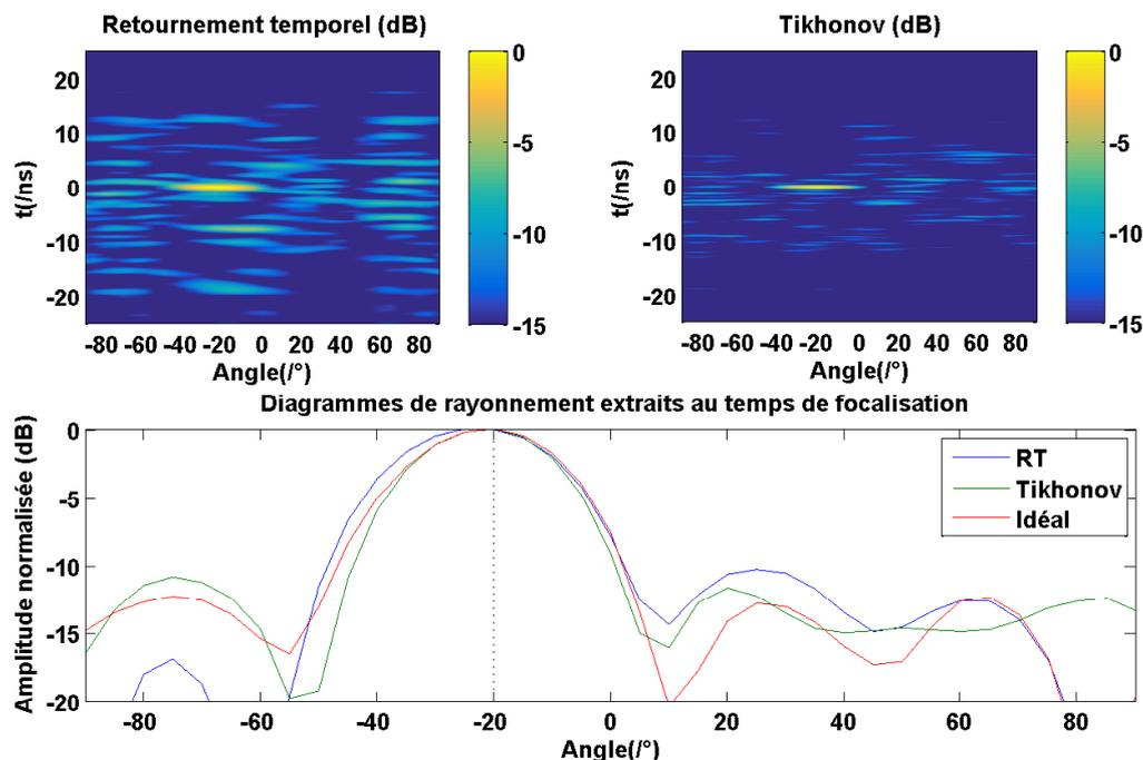
FIGURE 2.32 – Comparaison de diagrammes de rayonnement mesurés pour un pointage dans la direction  $\theta = -20^\circ$ , calculés à l'aide de signaux reconstruits par retournement temporel et par régularisation de Tikhonov. Les diagrammes de rayonnement extraits au temps de focalisation sont comparés à celui mesuré en branchant directement les 4 antennes de réception aux entrées de l'oscilloscope.
