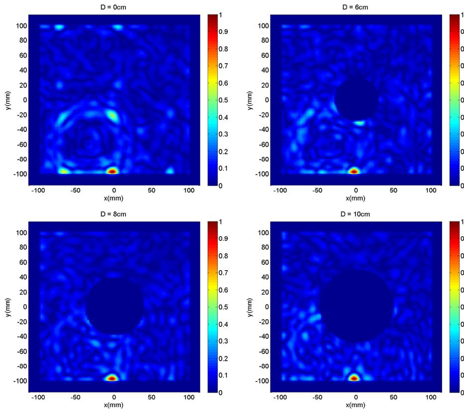
FIGURE 2.54 – Répartition spatiale du champ lors d’une focalisation en fonction du diamètre de la discontinuité introduite dans la cavité 2D.
