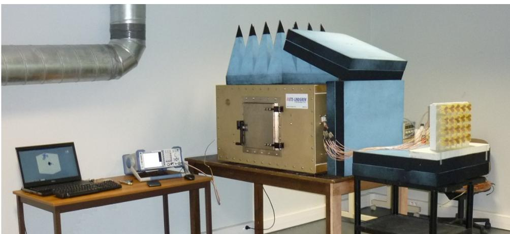
FIGURE 4.18 – Montage expérimental développé pour la première validation d'imagerie MIMO compressive.
