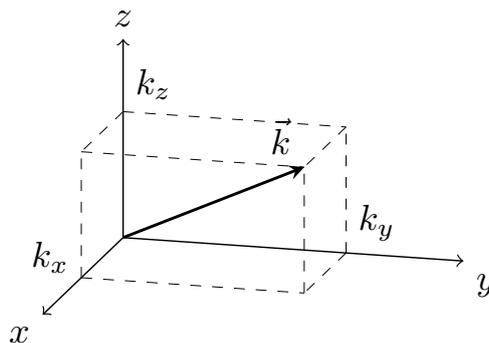
FIGURE 1.8 – Projections cartésiennes du vecteur d'onde  $\vec{k}$  portant une onde plane. La première étape de la décomposition spectrale consiste à exprimer les ondes reçues selon les composantes transverses  $k_x$  et  $k_z$ .
