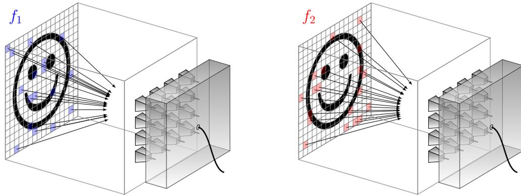
FIGURE 1.26 – Impact d'un composant générique sur le rayonnement du réseau d'antennes : les contributions spatiales issues de la cible sont sélectionnées en fonction de la réponse du composant à chaque fréquence et sommées en un signal unique. La clé de cette technique de compression réside dans l'impact du composant sur le diagramme de rayonnement du système de façon à diversifier les échantillons mesurés à chaque fréquence.
