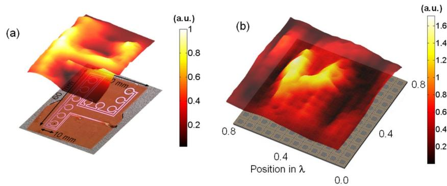
FIGURE 1.35 – Reconstruction d’une source magnétique par l’utilisation d’une structure sélective en fréquence : (a) Champ proche mesuré d’une source magnétique distribuée, (b) Reconstruction de la forme de la source couplée à une structure résonante éclairée en champ lointain par un cornet.
