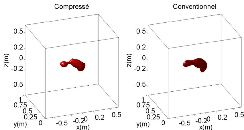
FIGURE 4.16 – Reconstruction en 3D de l'arme à feu par approches compressive et conventionnelle.
