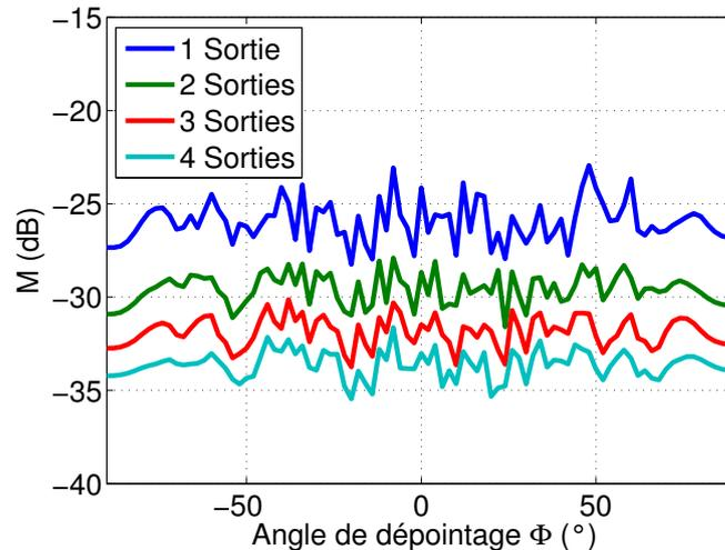
FIGURE 2.83 – Erreur quadratique moyenne évaluée en fonction de l'angle de pointage et du nombre de récepteurs utilisés.
