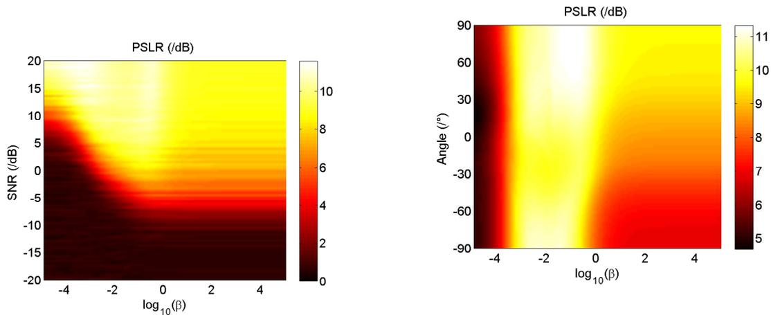
(a) Évolution du PSLR en fonction du rapport signal sur bruit et de la valeur du paramètre de régularisation, pour un angle de pointage  $\theta = 0^\circ$ .
