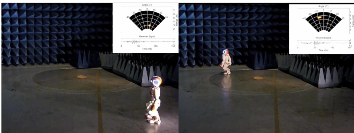
FIGURE 2.36 – Images issues de la vidéo de reconstruction en temps réel de la position d’un robot humanoïde se déplaçant dans la chambre anéchoïque. [55, 56, 57]
