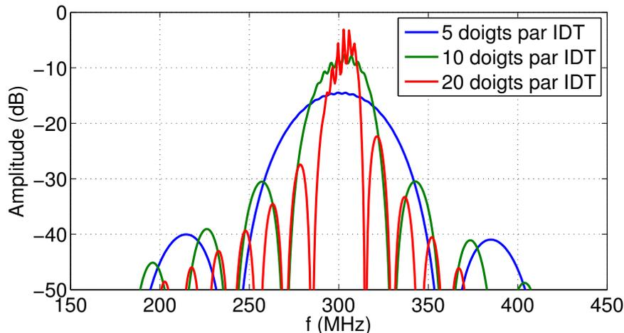
FIGURE 3.10 – Fonctions de transfert simulées pour des filtres SAW résonants à 300 MHz, exprimées en décibel.
