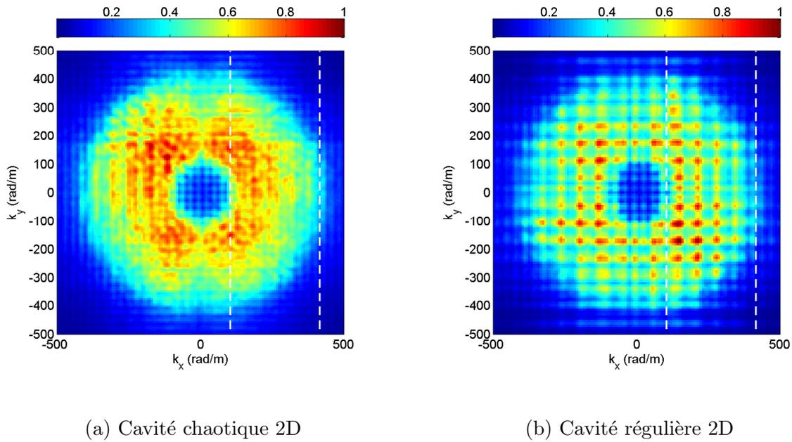
FIGURE 2.58 – Comparaison de la somme des modes présents sur la bande  $2-8GHz$  dans la cavité chaotique 2D présentée, comparée à une cavité régulière de mêmes dimensions. Les pointillés représentent les valeurs des nombres d’onde minimum et maximum théorique dans cette bande.
