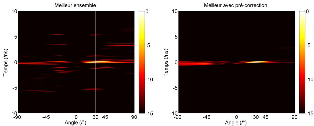
FIGURE 2.67 – Formations de faisceaux réalisées dans la direction  $30^\circ$  à partir de signaux compressés par le meilleur ensemble de canaux, sans et avec la méthode de correction de la matrice de corrélation.
