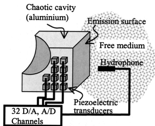
FIGURE 1.28 – Schéma du montage utilisé dans [33]
