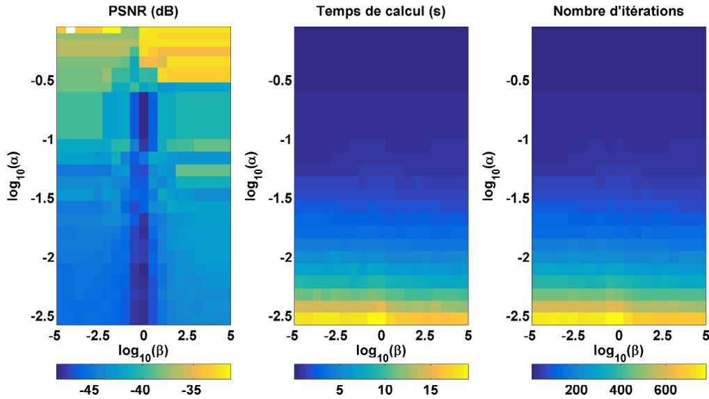
FIGURE 2.42 – Performances de l’algorithme itératif en fonction du paramètre de régularisation  $\beta$  et du gain de boucle  $\alpha$ .
