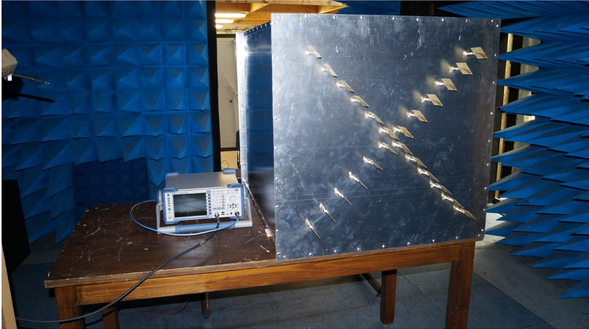
FIGURE 4.25 – Nouveau composant relié à un réseau de 24 antennes en croix.
