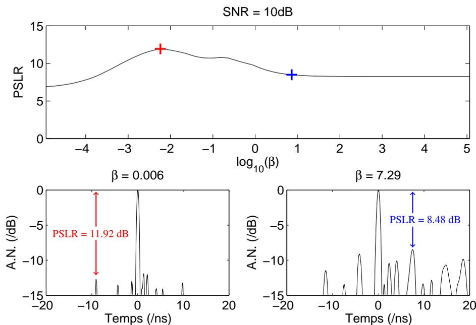
FIGURE 2.29 – Détermination du PSLR pour un  $SNR = 10$  dB et un pointage dans la direction  $\theta = -20^\circ$ . Le calcul est effectué pour un ensemble de valeurs de  $\beta$  régulièrement espacées dans la plage de variation  $[10^{-5}, 10^5]$ . La figure supérieure présente la variation du PSLR en fonction de  $\beta$ . Deux exemples de mesures sont extraits pour des valeurs différentes de paramètre de régularisation.
