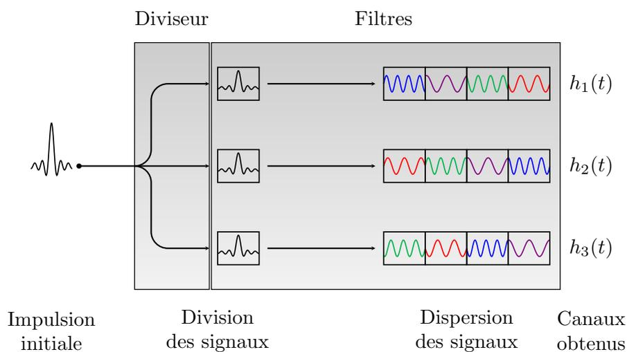
FIGURE 3.2 – Composant compressif basé sur l'utilisation de filtres dispersifs orthogonaux.
