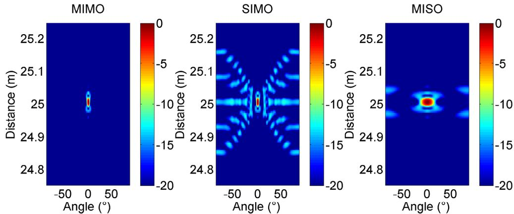
FIGURE 4.4 – Comparaison des images radar réalisées par formation de faisceaux à partir des signaux réfléchis sur une cible placée en champ lointain en face des réseaux.
