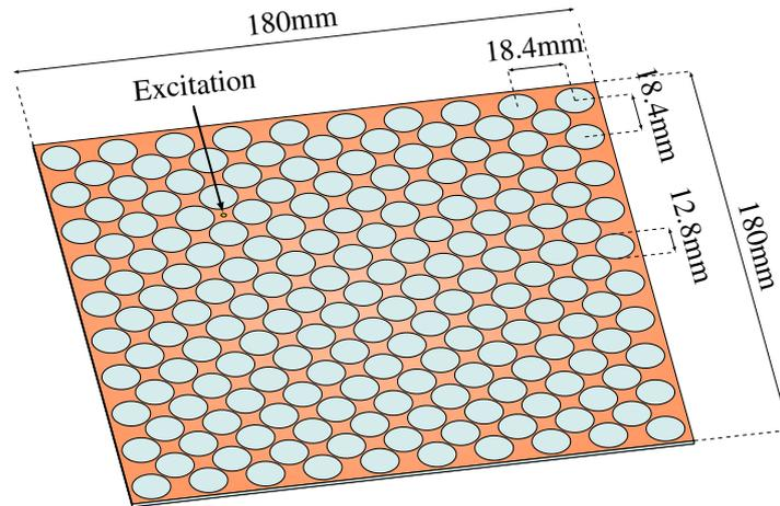
FIGURE 2.15 – Structure simulée pour l’étude de l’effet d’une rupture périodique d’impédance affectant la propagation. Les cotes présentées sont les dimensions finales permettant d’obtenir une bande interdite au-dessus de la bande utile.
