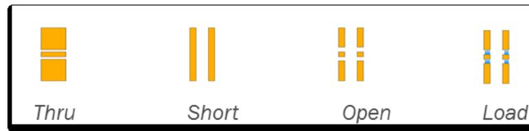
Figure 28 : Vue rapprochée des standards utilisés lors du calibrage SOLT
