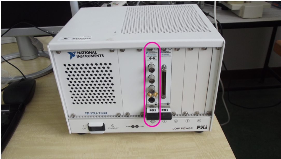
(a) Photographie du châssis PXI contenant la carte d'acquisition 5922
