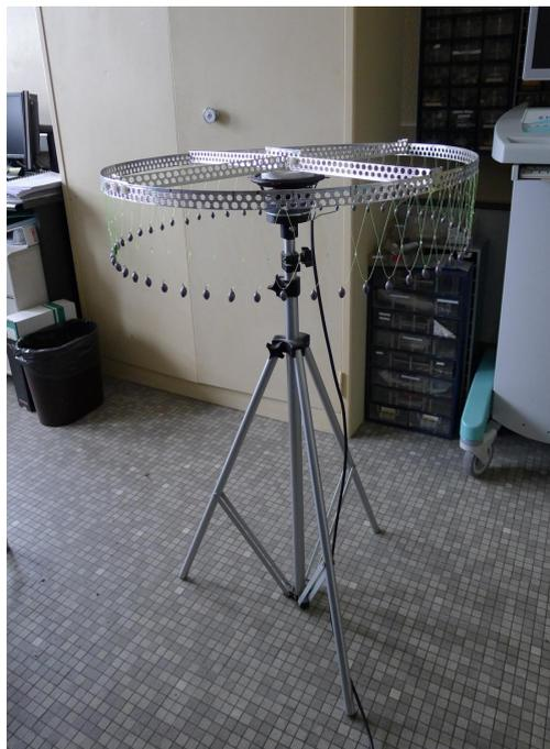
FIGURE 5.3 – *Système expérimental avec le couplage en forme de "V"*;  $a = 3,5 \text{ cm}$ ;  $d = 5 \text{ cm}$ ;  $L = 10 \text{ cm}$ ;  $R_0 = 31 \text{ cm}$ .
