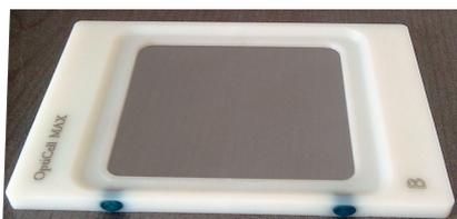
FIGURE 4.3 – Opticell utilisée dans les expériences sur les bulles. L'agent de contraste ultrasonore est injecté à l'intérieur de la chambre.
