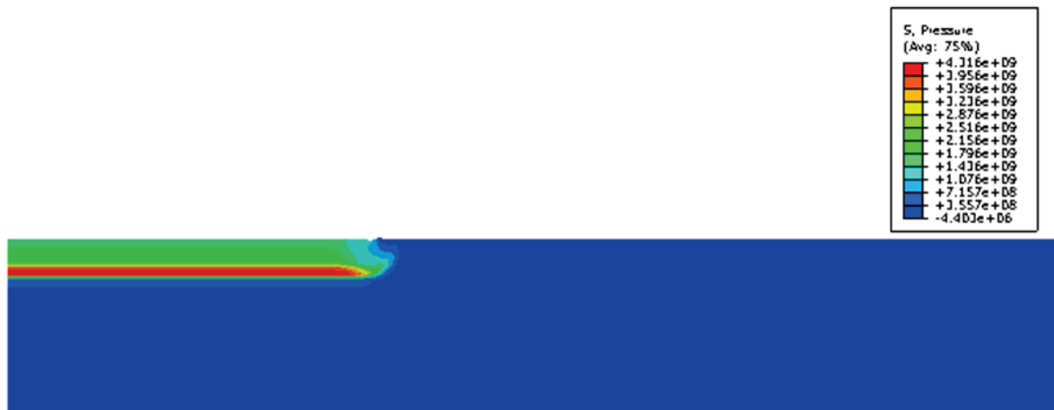
FIGURE IV.28: Profil de pression calculé par simulation numérique dans l'éprouvette d'acier galvanisé 48 ns après le choc laser, pour une densité de puissance laser de 5 GW/cm 2
