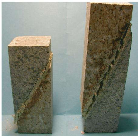
(a) Rupture à l'interface (b) Rupture dans le mortier
