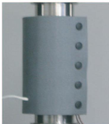
FIGURE 2.10 – Collier chauffant autour du cylindre en acier.
