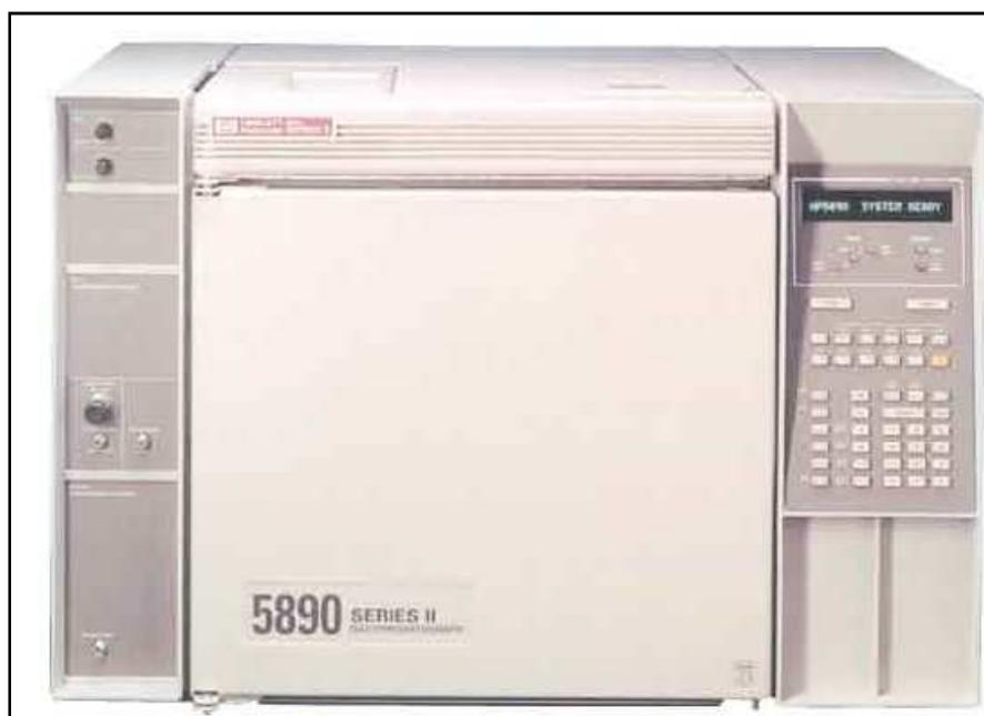
**Fig.16. Chromatographe de type « HP 5890 séries II »**
