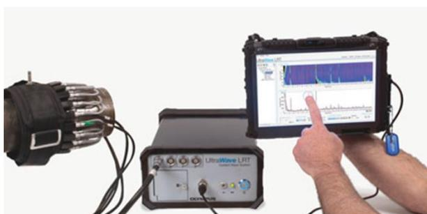
**Figure I-15:** Photo du système de génération d'ondes guidées « Ultrawave » d'« Olympus » [48]
