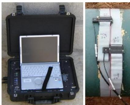
**Figure I-14:** Photo du système magnétostrictif (MsS) de génération d'ondes guidées GWA [46]
