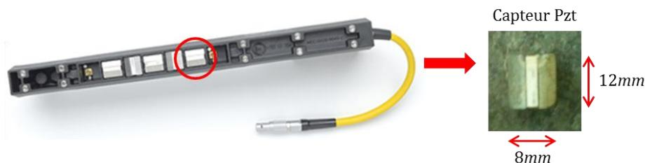
**Figure IV-18 :** Capteur piézoélectrique (Pzt) instrumenté pour la mesure du déplacement orthoradial
