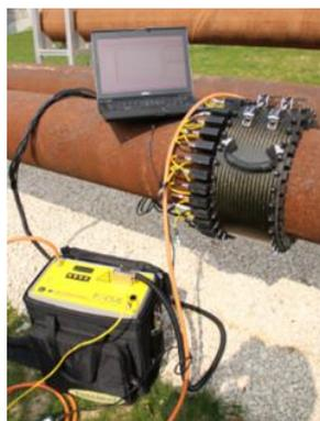
**Figure I-12:** Photo du système de génération d'ondes guidées « Teletest » de Pi [46]
