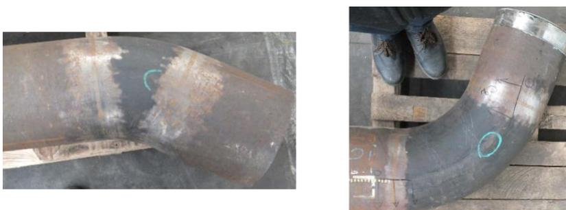
**Figure IV-15 :** Canalisations 10'' comportant des coudes de 30° (droite) et de 70° (gauche) dont les bourrelets de soudures ont été arasés
