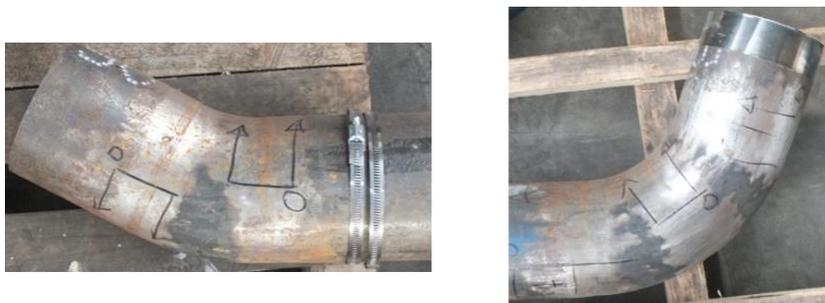
**Figure IV-14 :** Canalisations 6'' comportant des coudes de 30° (droite) et de 70° (gauche) dont les bourrelets de soudures ont été arasés
