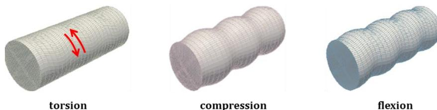
**Figure I-5 :** illustration des déformées des modes de Pochhammer-Chree dans un guide cylindrique d'après [30]
