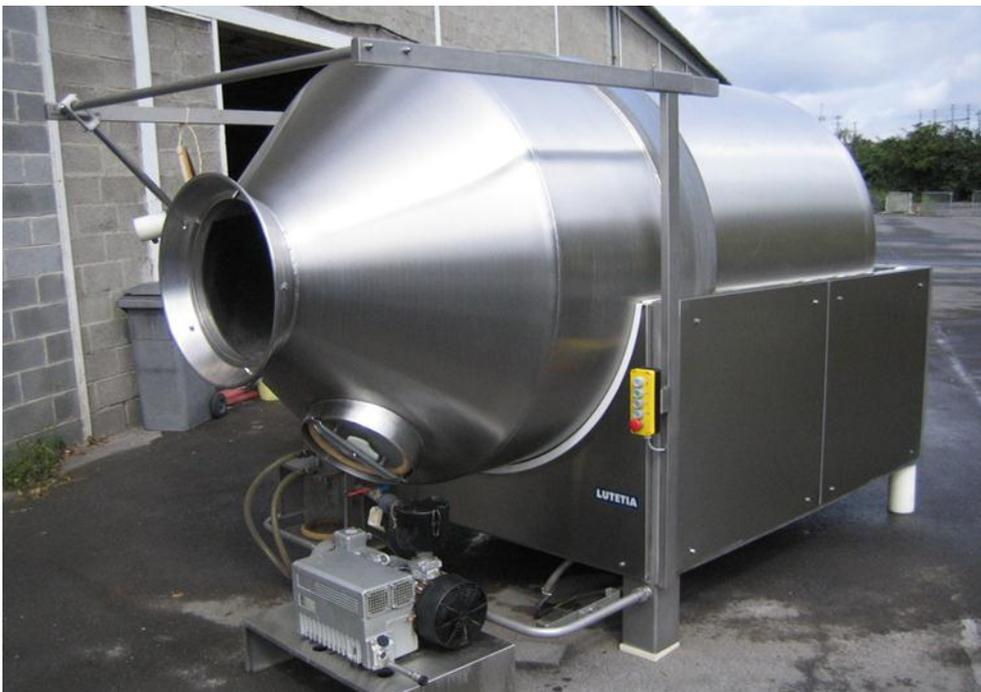
Figure 24 : Exemple d'une baratte industrielle 0,8 x 1,2 x 1 m et charge maximum 2800 litres.
