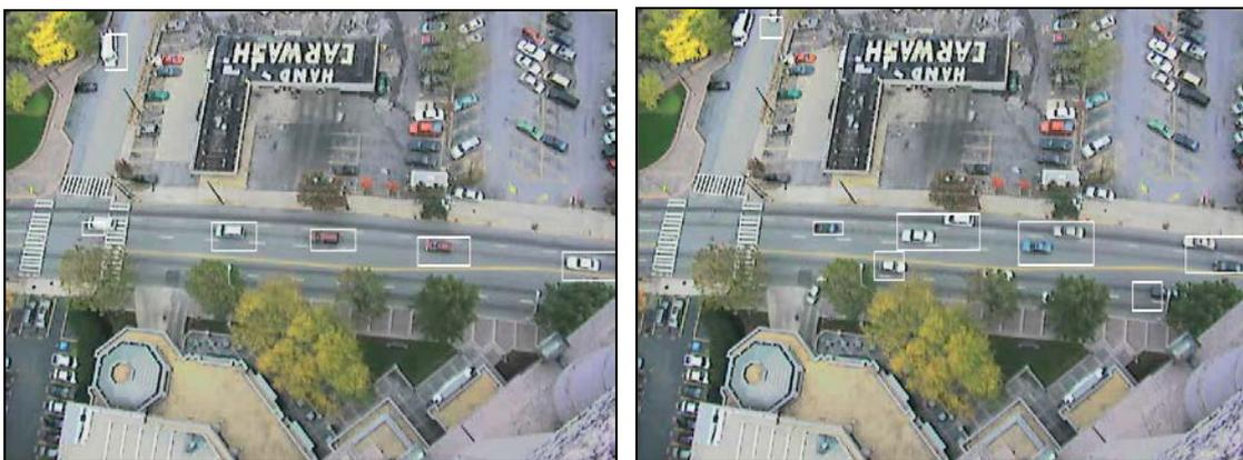
**Figure 70 –Détection de véhicules (contours obtenus après détection de boîtes englobantes) – MPEG-4 Part 2**
