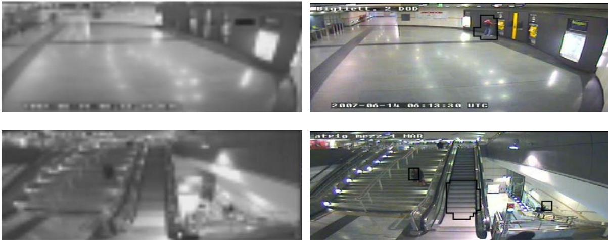
Figure 61 –Reconstruction du fond et détection de piétons
