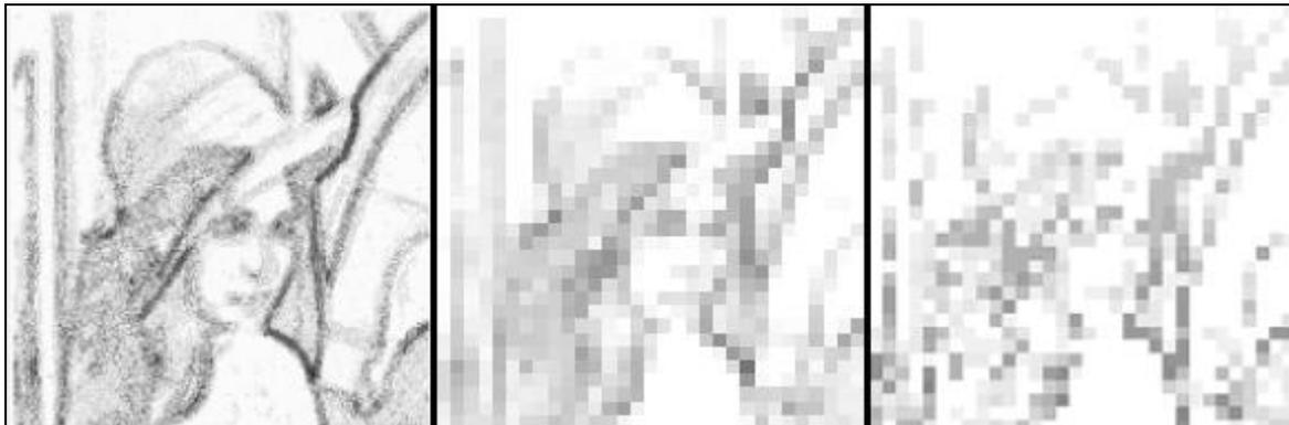
Figure 18 - Carte de gradient et approximation de contours dans le domaine compressé
