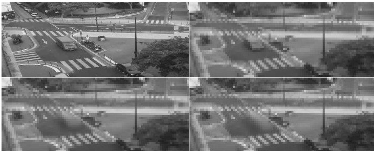
**Figure 32 – Effet de flou après reconstruction par le LRD : Première image du GoP décompressé, puis image basse-résolution 1 (intra), 10 et 20 (prédite) – Source : corpus Infom@gic**
