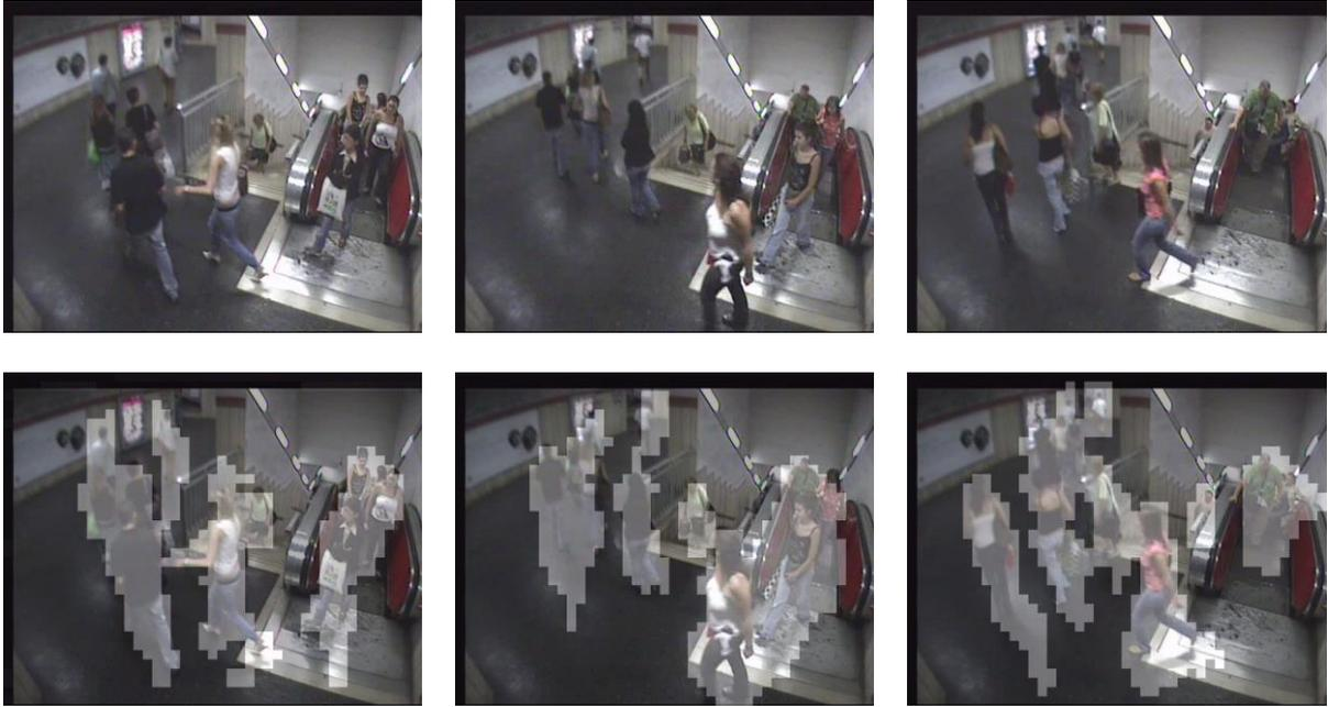
**Figure 69 –Détection de piétons groupés (contours directement obtenus après segmentation) – MPEG-4 Part 2**
