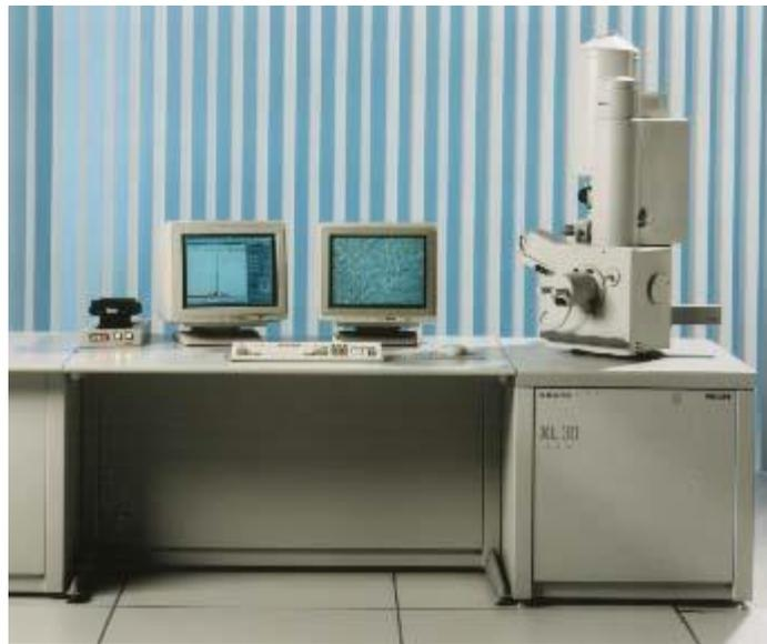
*Figure A.ME.1 Microscope électronique à balayage Philips XL30*
