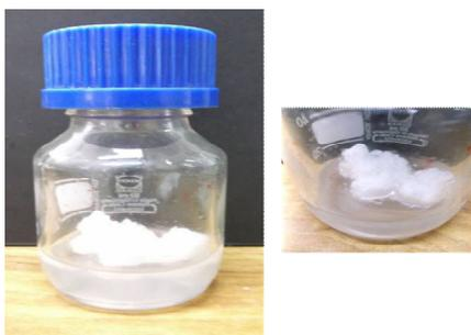
*Figure II.3.1 : Images prises à l'aide d'un appareil photographique numérique : dispersion préparée en absence de NCA et MPEG montrant la formation d'un seul gros agrégat*
