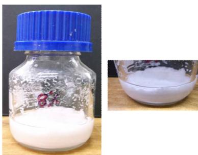
*Figure II.3.2 : Images prises à l'aide d'un appareil photographique numérique : dispersion de nanocomposites à 8% en poids de NCA et en absence de MPEG montrant la formation des particules de polymères agglomérées*
