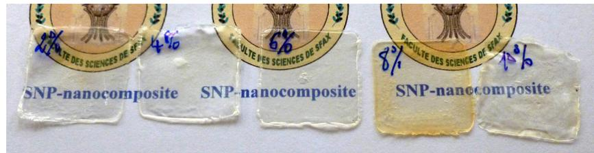
Figure IV.1 : photo numérique des films nanocomposites des dispersions de polymère préparées par polymérisation en émulsion à différents taux des NPA
