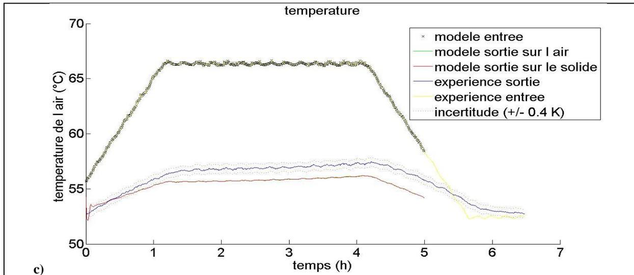
**Figure 121 : Comparaison des résultats expérimentaux et numériques de la déshydratation effectuée en régime dynamique : a) avancement de la réaction ; b) consommation de vapeur d'eau ; c) température de l'air et du solide (cas numéro 17).**
