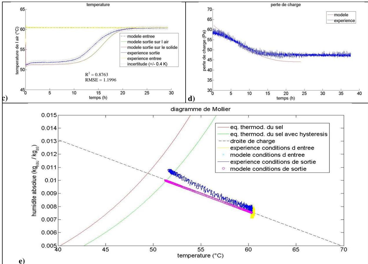
**Figure 105 : Comparaison des résultats expérimentaux et numériques pour la validation des déshydratations de référence (cas numéro 2) : a) avancement de la réaction ; b) consommation de vapeur d'eau ; c) température de l'air et du solide ; d) perte de charge ; e) représentation sur le diagramme de Mollier.**
