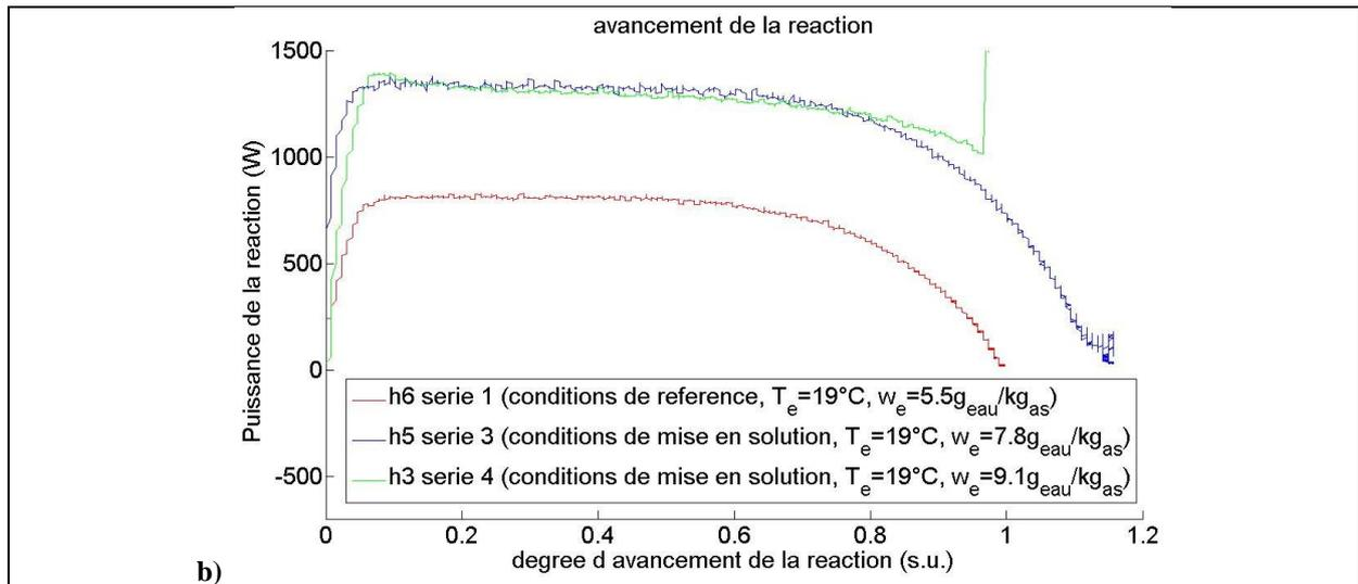
**Figure 100 : Comparaison entre un essai de référence et les essais dont les conditions se situent à l'intérieur de la zone de mise en solution pour : a) l'élévation de température du flux d'air ; b) la puissance dégagée.**
