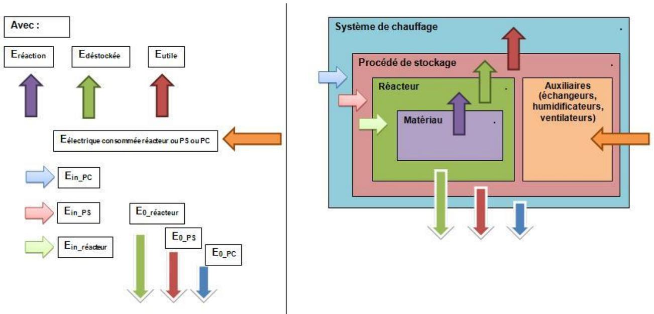
Figure 30 : Schéma-aide à la compréhension des définitions des critères présentés au [Tableau 13].
