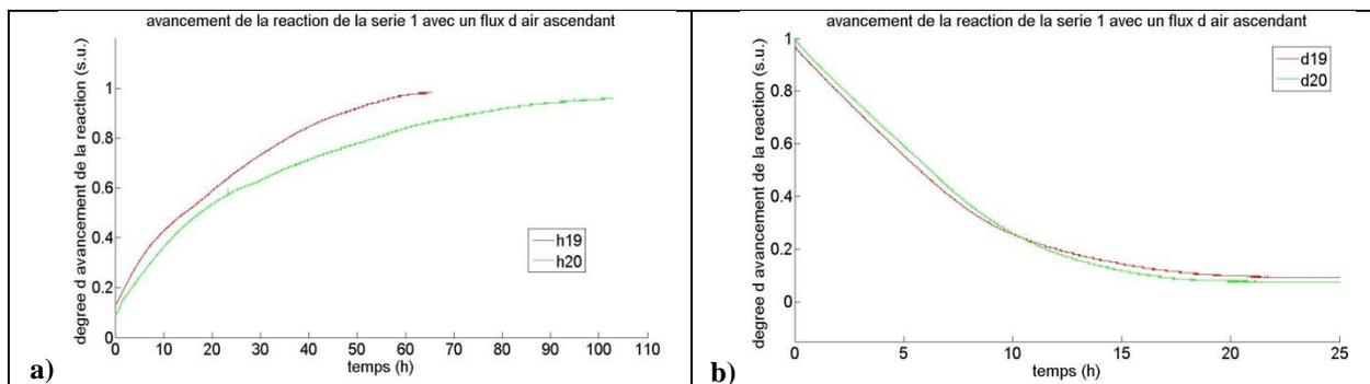
**Figure 57 : Avancement de la réaction pour la première série de tests pour les essais effectués avec un flux d'air ascendant : a) pour la réaction d'hydratation ; b) pour la réaction de déshydratation.**
