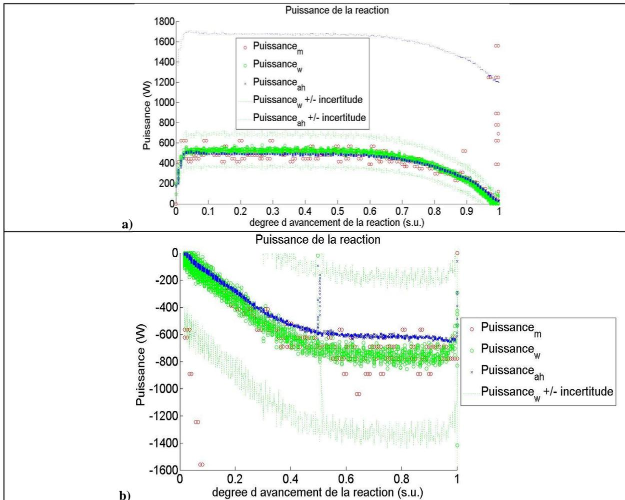
**Figure 92 : Calcul de la puissance avec les trois méthodes et des incertitudes pour chaque méthode : a) pour la première hydratation de la première série d'essai ; b) pour la sixième déshydratation de la première série de tests.**
