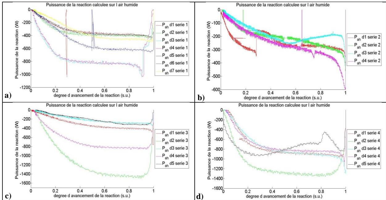
**Figure 94 : Puissance de la réaction en déshydratation calculée avec un bilan enthalpique sur l'air humide pour les séries des tests : a) pour la première série ; b) pour la deuxième série ; c) pour la troisième série ; d) pour la quatrième série.**
