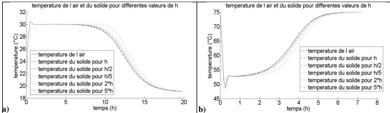
**Figure 45 : Influence des modes de transfert thermique ( $h=237 \text{ W/K}\cdot\text{m}^2$ ) pour : a) une réaction d'hydratation ; b) une réaction de déshydratation.**
