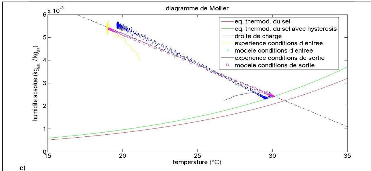
**Figure 104 : Comparaison finale des résultats expérimentaux et numériques pour la validation des hydratations de référence (cas numéro 1) : a) avancement de la réaction ; b) consommation de vapeur d'eau ; c) température de l'air et du solide ; d) perte de charge ; e) représentation sur le diagramme de Mollier.**
