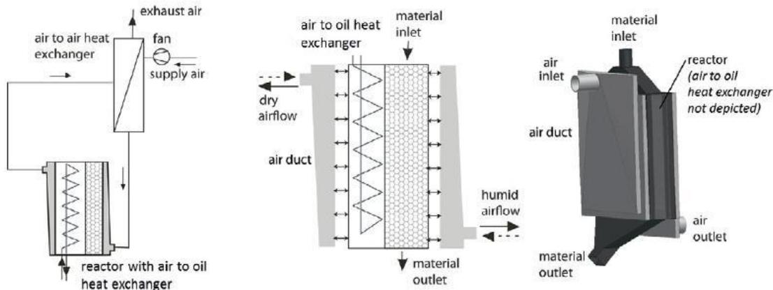
Figure 22 : Le réacteur séparé construit par ITW [Kerskes 2012].
