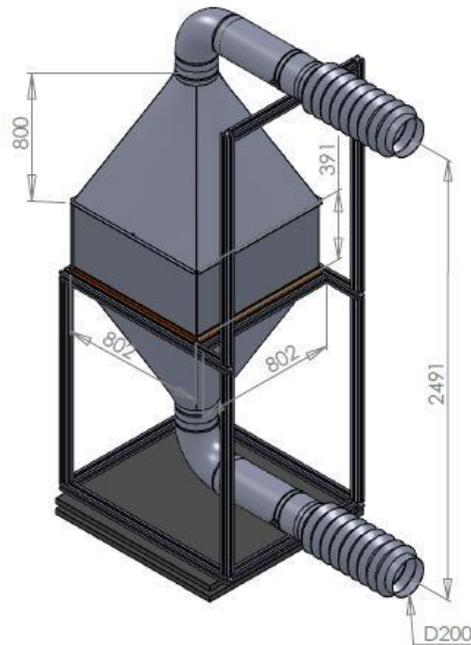
Figure 47 : Représentation schématique du réacteur (côtes en mm).
