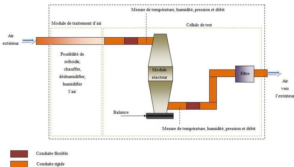
Figure 53 : Schéma de principe du banc aéraulique MATHER.
