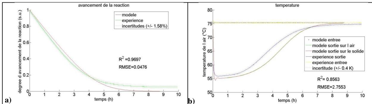
**Figure 114 : Comparaison des résultats expérimentaux et numériques pour la validation du cas numéro 10 de la déshydratation effectuée pour d'autres conditions opératoires en régime stationnaire : a) avancement de la réaction ; b) température de l'air et du solide.**
