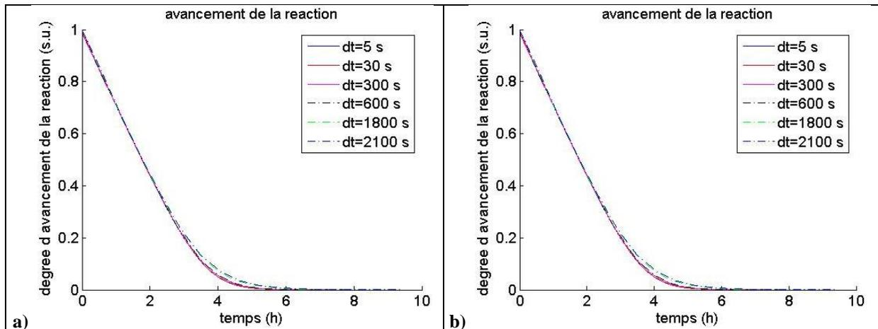
Figure 40 : Influence du pas de temps sur l'avancement de la réaction d'une déshydratation avec un nombre d'élément de discrétisation dans l'espace,  $m=60$  : a) version du modèle sans la prise en compte de la variation du volume ; b) version du modèle avec la prise en compte de la variation du volume.
