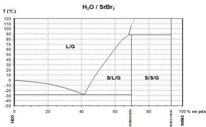
Figure 69 : Diagramme de phase  $\text{SrBr}_2\text{-H}_2\text{O}$  [Pascal 1958], [Lahmidi 2005].
