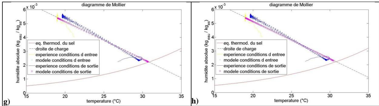
**Figure 103 :** Comparaison des résultats expérimentaux et numériques pour 2 valeurs de la constante cinétique : a et b) avancement de la réaction ; c et d) consommation de vapeur d'eau ; e et f) température de l'air et du solide ; g et h) représentation sur le diagramme de Mollier.
