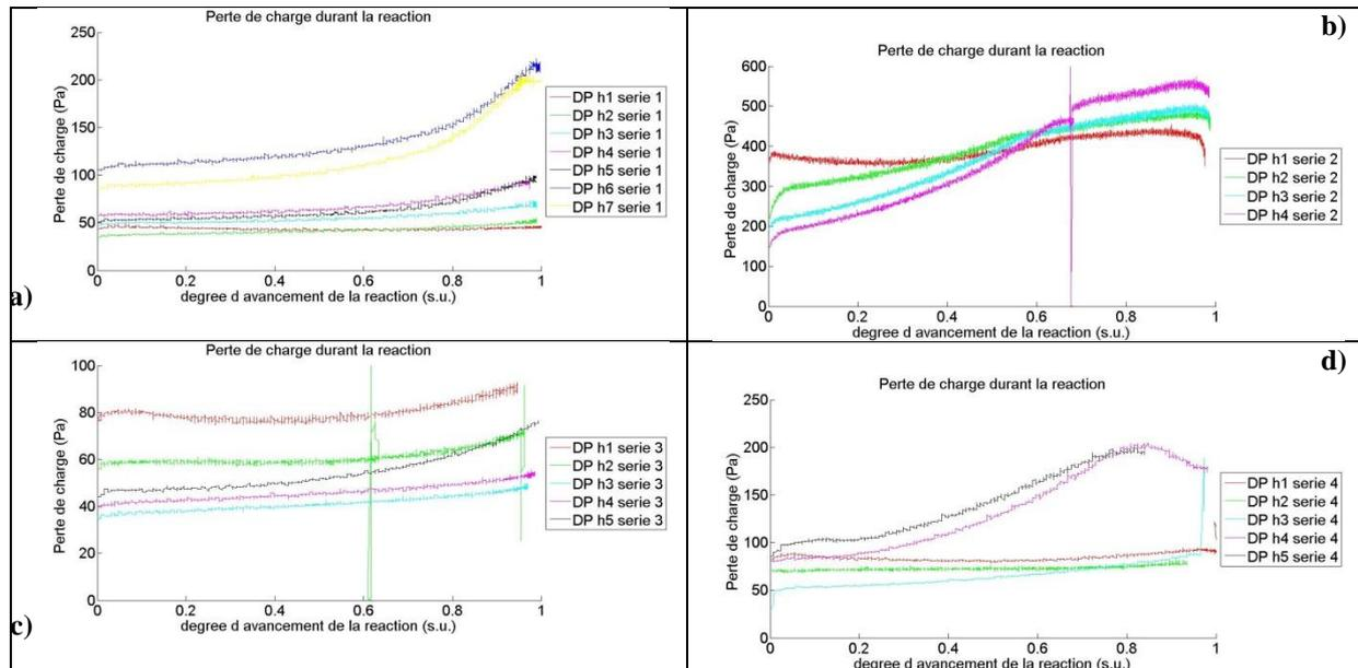
**Figure 97 : Evolution de la perte de charge durant la réaction d'hydratation pour les séries des tests : a) pour la première série ; b) pour la deuxième série ; c) pour la troisième série ; d) pour la quatrième série.**
