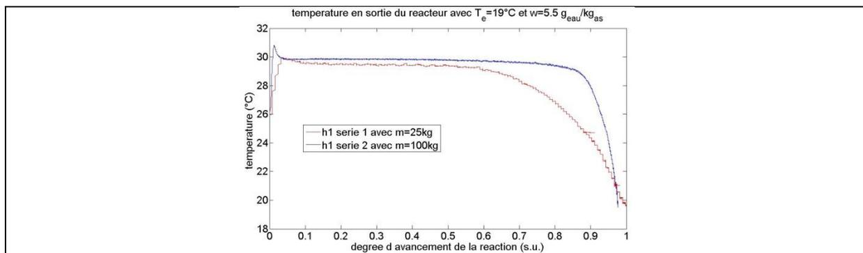
Figure 83 : Influence de l'épaisseur du lit réactif sur l'évolution de la température.
