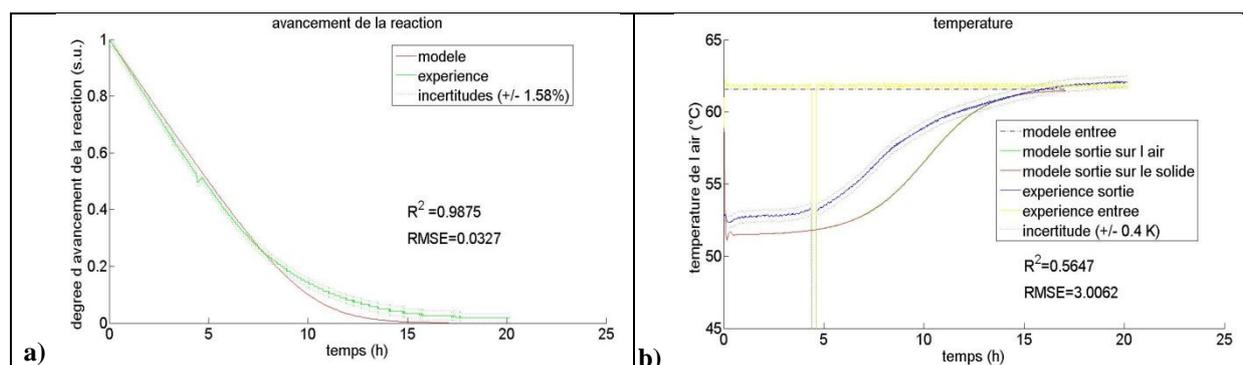
**Figure 107 : Comparaison des résultats expérimentaux et numériques pour la validation des déshydratations pour un débit d'air différent (cas numéro 4) : a) avancement de la réaction ; b) température de l'air et du solide.**
