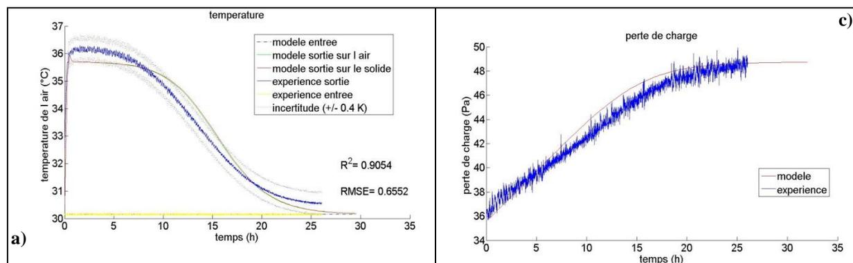
**Figure 111 : Comparaison des résultats expérimentaux et numériques pour la validation du cas numéro 7 de l'hydratation effectuée pour d'autres conditions opératoires en régime stationnaire : a) température de l'air et du solide ; b) perte de charge.**
