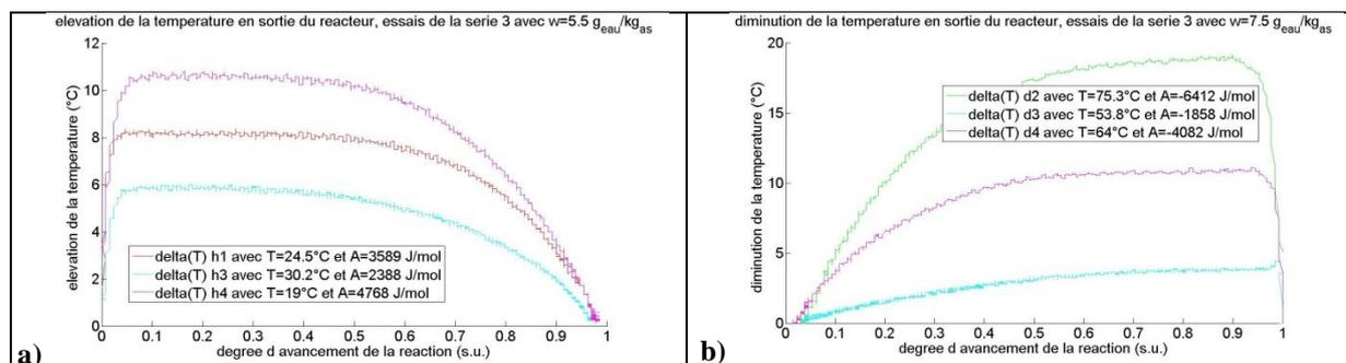
**Figure 84 : Influence de la température en entrée du réacteur sur : a) l'élévation de la température enregistrée en sortie de réacteur en hydratation ; b) la diminution de la température enregistrée en sortie de réacteur en hydratation en déshydratation.**
