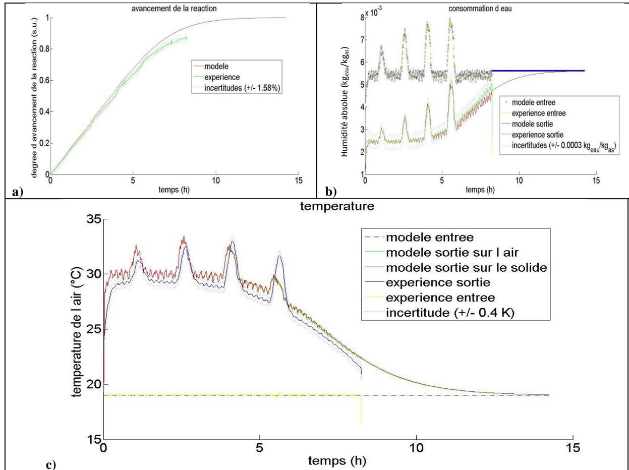
**Figure 120 : Comparaison des résultats expérimentaux et numériques de l'hydratation effectuée en régime dynamique : a) avancement de la réaction ; b) consommation de vapeur d'eau ; c) température de l'air et du solide (cas numéro 16).**
