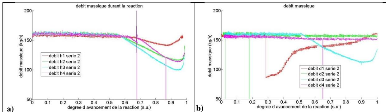
**Figure 70 : Evolution du débit massique pour la deuxième série d'essais: a) en hydratation ; b) en déshydratation.**
