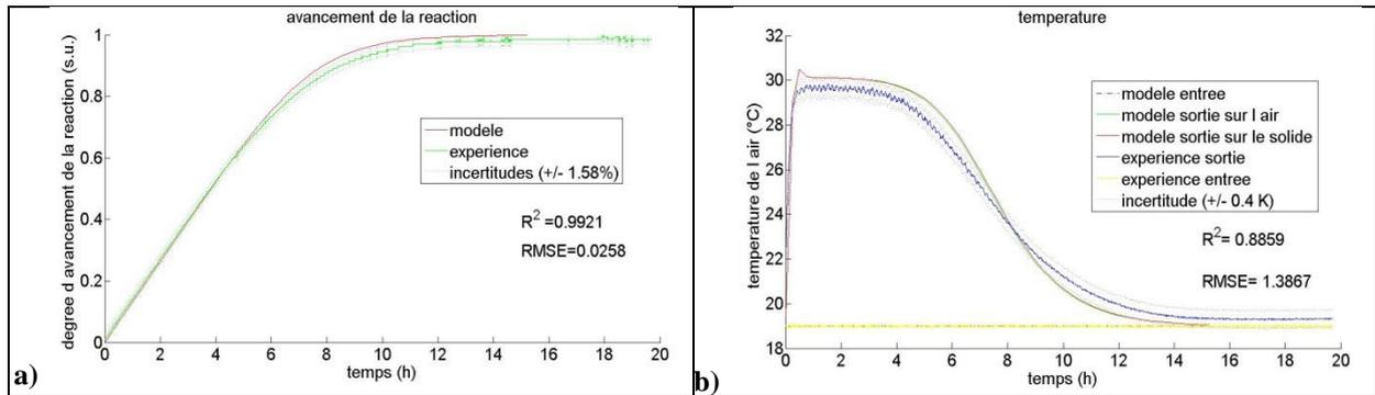
**Figure 106 : Comparaison des résultats expérimentaux et numériques pour la validation des hydratations pour un débit d'air différent (cas numéro 3) : a) avancement de la réaction ; b) température de l'air et du solide.**
