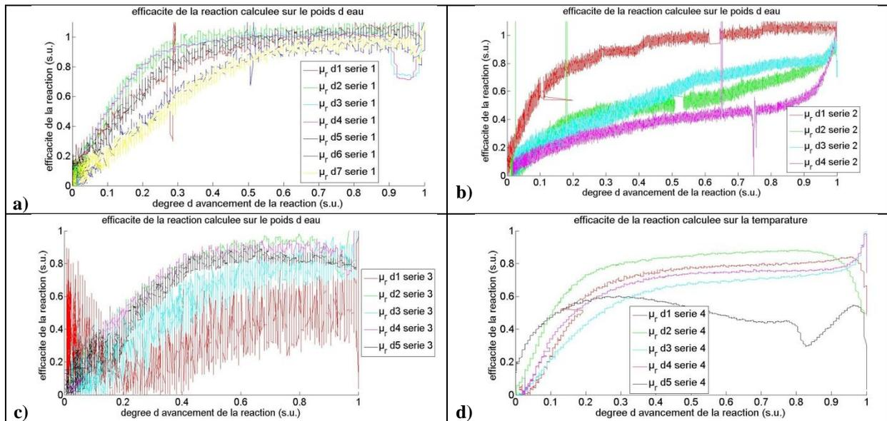
**Figure 127 : Efficacité de la réaction en déshydratation calculée sur l'humidité absolue pour les séries des tests (Annexe) : a) pour la première série ; b) pour la deuxième série ; c) pour la troisième série ; d) pour la quatrième série (Annexe).**
