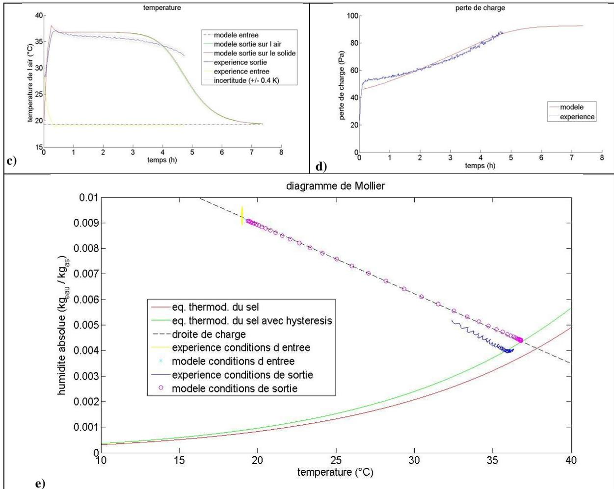
**Figure 113 : Comparaison des résultats expérimentaux et numériques pour la validation du cas numéro 8 de l'hydratation effectuée pour d'autres conditions opératoires en régime stationnaire : a) avancement de la réaction ; b) consommation de vapeur d'eau ; c) température de l'air et du solide ; d) perte de charge ; e) représentation sur le diagramme de Mollier.**
