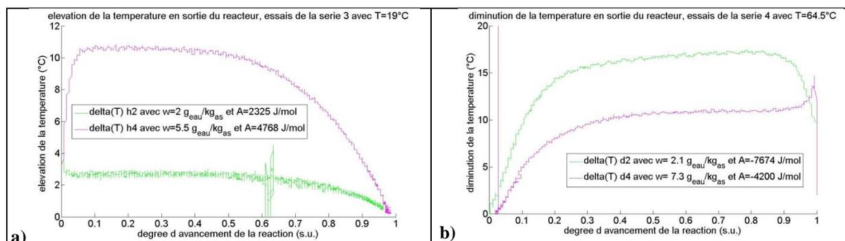
**Figure 85 : Influence de l'humidité absolue en entrée du réacteur sur : a) l'élévation de la température enregistrée en sortie de réacteur en hydratation ; b) la diminution de la température enregistrée en sortie de réacteur en hydratation en déshydratation.**
