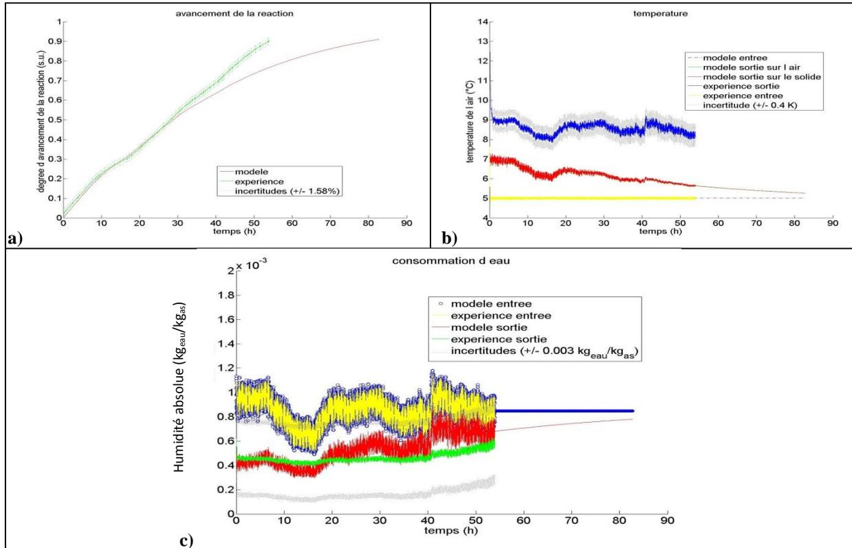
**Figure 112 : Comparaison des résultats expérimentaux et numériques pour la validation du cas numéro 9 de l'hydratation effectuée pour d'autres conditions opératoires en régime stationnaire : a) avancement de la réaction ; b) température de l'air et du solide ; c) consommation de vapeur d'eau.**
