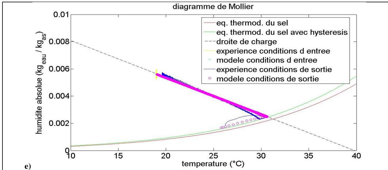
**Figure 122 :** Comparaison des résultats expérimentaux et numériques de l'hydratation effectuée pour une quantité de réactif plus importante (cas numéro 18) : a) avancement de la réaction ; b) température de l'air et du solide ; c) perte de charge ; d) représentation sur le diagramme de Mollier ; e) débit d'air en sortie de réacteur.
