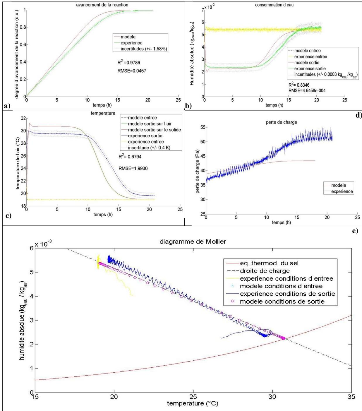
**Figure 102 : Comparaison initiale des résultats expérimentaux et numériques pour la validation des hydratations de référence (cas numéro 1) : a) avancement de la réaction ; b) consommation de vapeur d'eau ; c) température de l'air et du solide ; d) perte de charge ; e) représentation sur le diagramme de Mollier.**
