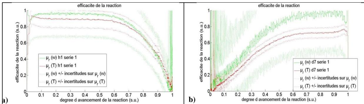
**Figure 87 : Comparaison de l'efficacité de la réaction calculée avec la température et avec l'humidité absolue en tenant compte des incertitudes respectives : a) pour une hydratation ; b) pour une déshydratation.**
