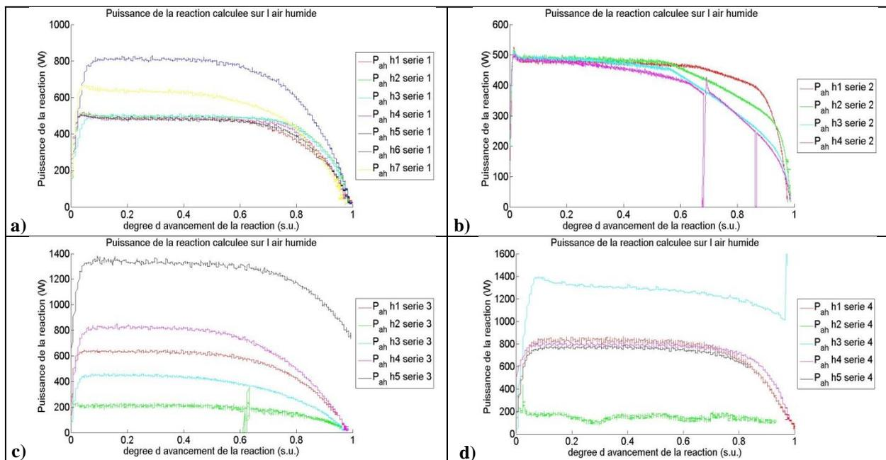
**Figure 93 : Puissance de la réaction en hydratation calculée avec un bilan enthalpique sur l'air humide pour les séries des tests : a) pour la première série ; b) pour la deuxième série ; c) pour la troisième série ; d) pour la quatrième série.**
