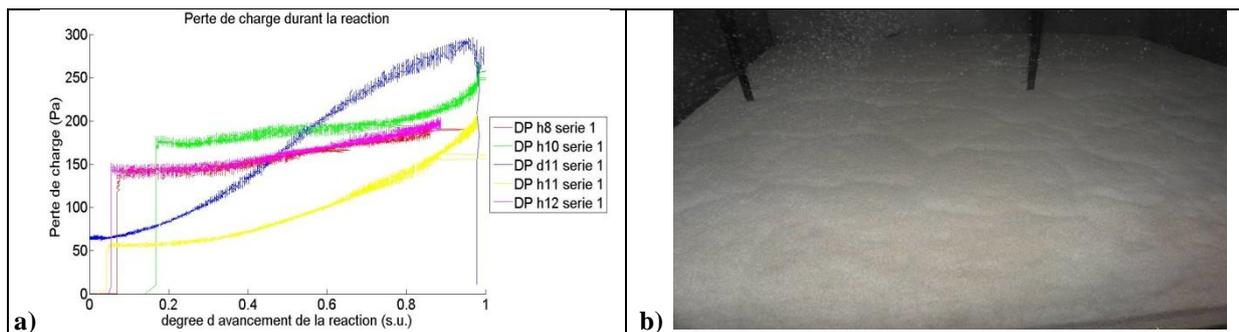
**Figure 67 :** Observation concernant le phénomène de mise en solution : a) évolution de la perte de charge pour certains cycles ; b) observation visuel de la formation d'une couche superficiel plus imperméable.
