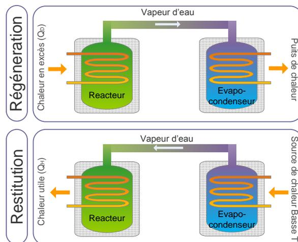
Figure 10 : Fonctionnement d'un système basse pression.
