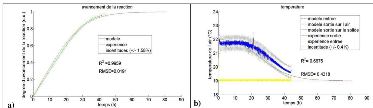
**Figure 110 : Comparaison des résultats expérimentaux et numériques pour la validation du cas numéro 6 de l'hydratation effectuée pour d'autres conditions opératoires en régime stationnaire : a) avancement de la réaction ; b) température de l'air et du solide ; c) perte de charge.**
