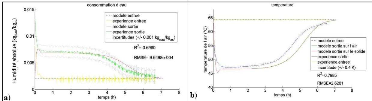
**Figure 116 : Comparaison des résultats expérimentaux et numériques pour la validation du cas numéro 12 de la déshydratation effectuée pour d'autres conditions opératoires en régime stationnaire : a) l'humidité absolue ; b) la température de l'air et du solide.**
