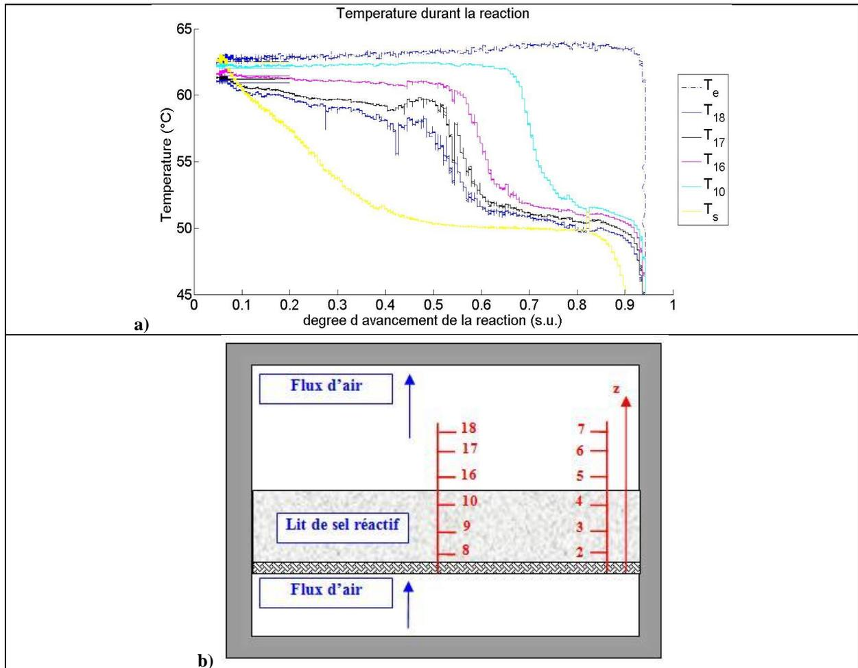
**Figure 60 : Evolution des températures pour un essai effectué avec un flux d'air ascendant pour les réactions : a) de déshydratation ; b) rappel de l'emplacement des thermocouples au sein du réacteur.**
