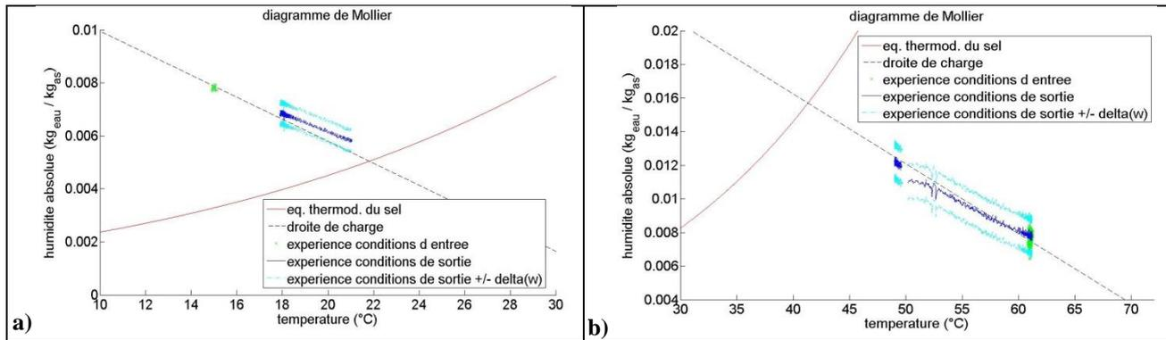
**Figure 62 : Démonstration expérimental de la droite de charge pour : a) une hydratation ; b) une déshydratation.**
