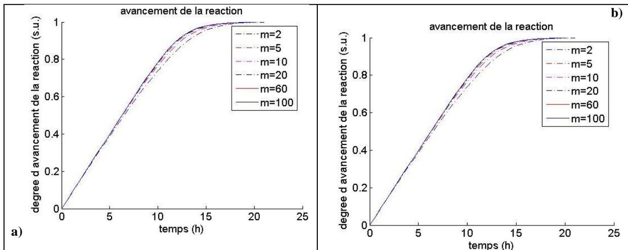
**Figure 39 :** Influence du pas d'espace sur l'avancement de la réaction d'une hydratation avec un pas de temps,  $dt=30$  s, qui est égal au pas d'enregistrement des données expérimentales : a) version du modèle sans la prise en compte de la variation du volume ; b) version du modèle avec la prise en compte de la variation du volume.
