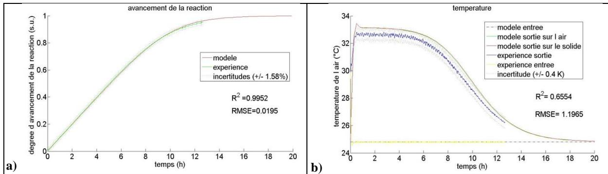
**Figure 109 : Comparaison des résultats expérimentaux et numériques pour la validation du cas numéro 5 de l'hydratation effectuée pour d'autres conditions opératoires en régime stationnaire : a) avancement de la réaction ; b) température de l'air et du solide.**
