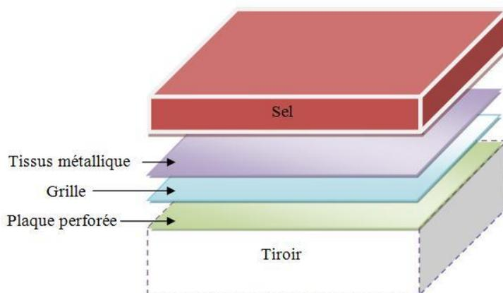
Figure 48 : Vue schématique à l'intérieur du tiroir.
