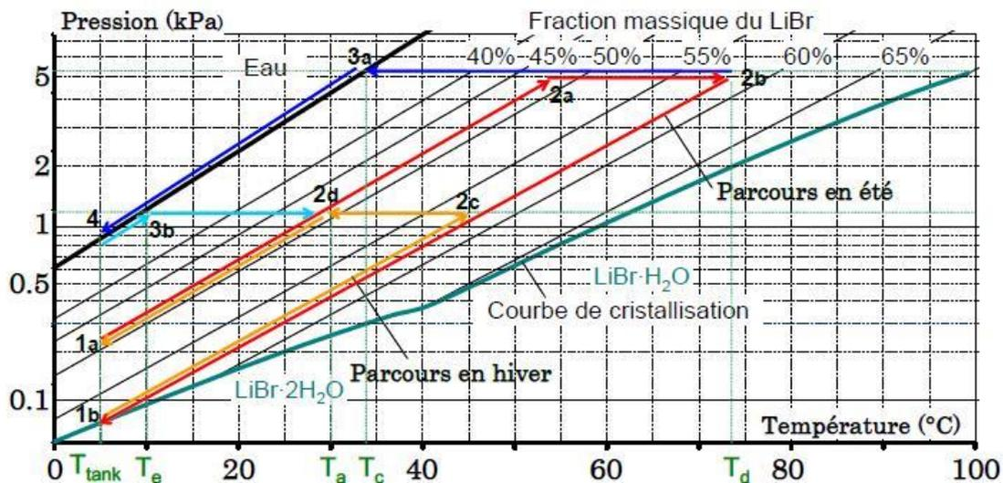
Figure 8 : Cycle thermodynamique du procédé de stockage par absorption sur le diagramme de Dühring de la solution LiBr-eau [N'Tsoukpoe 2012].
