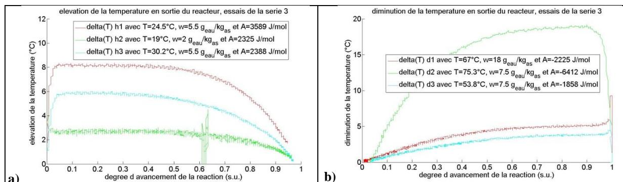
**Figure 86 : Influence combiné de l'humidité absolue et de la température en entrée du réacteur sur : a) l'élévation de la température enregistrée en sortie de réacteur en hydratation ; b) la diminution de la température enregistrée en sortie de réacteur en hydratation en déshydratation.**
