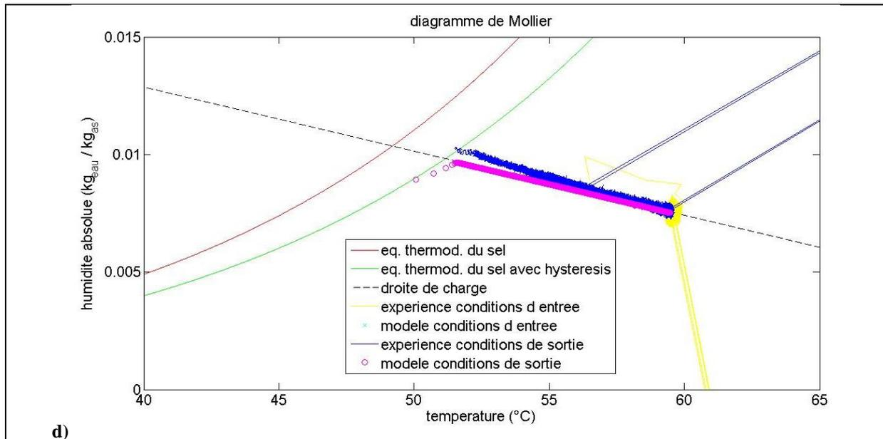
**Figure 123 : Comparaison des résultats expérimentaux et numériques de la déshydratation effectuée pour une quantité de réactif plus importante (cas numéro 19) : a) avancement de la réaction ; b) température de l'air et du solide ; c) perte de charge ; d) représentation sur le diagramme de Mollier.**
