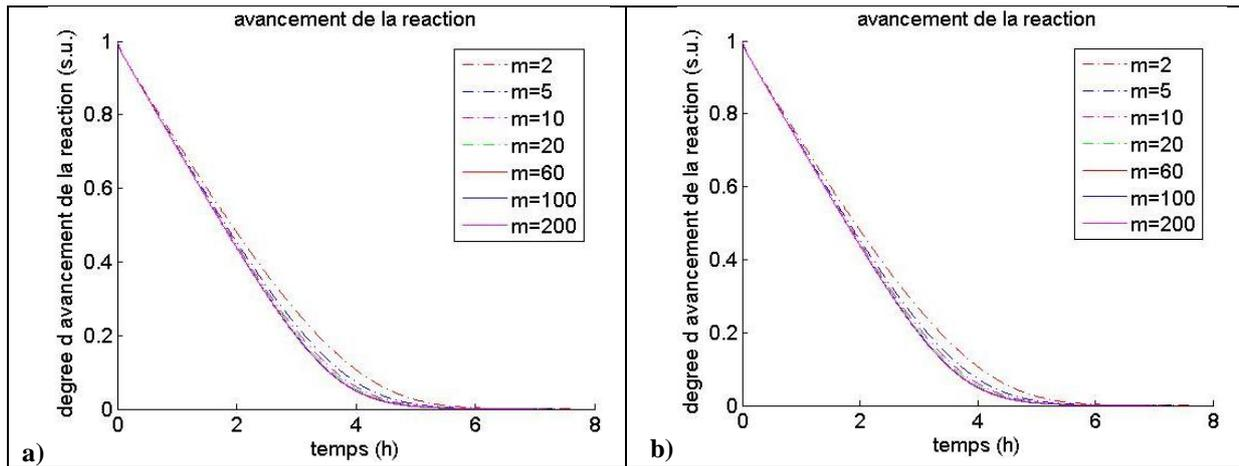
**Figure 38 :** Influence du pas d'espace sur l'avancement de la réaction d'une déshydratation avec un pas de temps,  $dt=30$  s, qui est égal au pas d'enregistrement des données expérimentales : a) version du modèle sans la prise en compte de la variation du volume ; b) version du modèle avec la prise en compte de la variation du volume.
