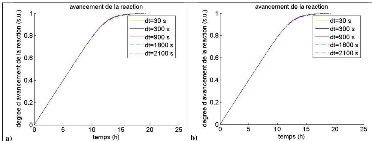
Figure 41 : Influence du pas de temps sur l'avancement de la réaction d'une hydratation avec un nombre d'élément de discrétisation dans l'espace,  $m=60$  : a) version du modèle sans la prise en compte de la variation du volume ; b) version du modèle avec la prise en compte de la variation du volume.
