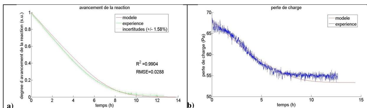
**Figure 115 : Comparaison des résultats expérimentaux et numériques pour la validation du cas numéro 11 de la déshydratation effectuée pour d'autres conditions opératoires en régime stationnaire : a) avancement de la réaction ; b) perte de charge.**
