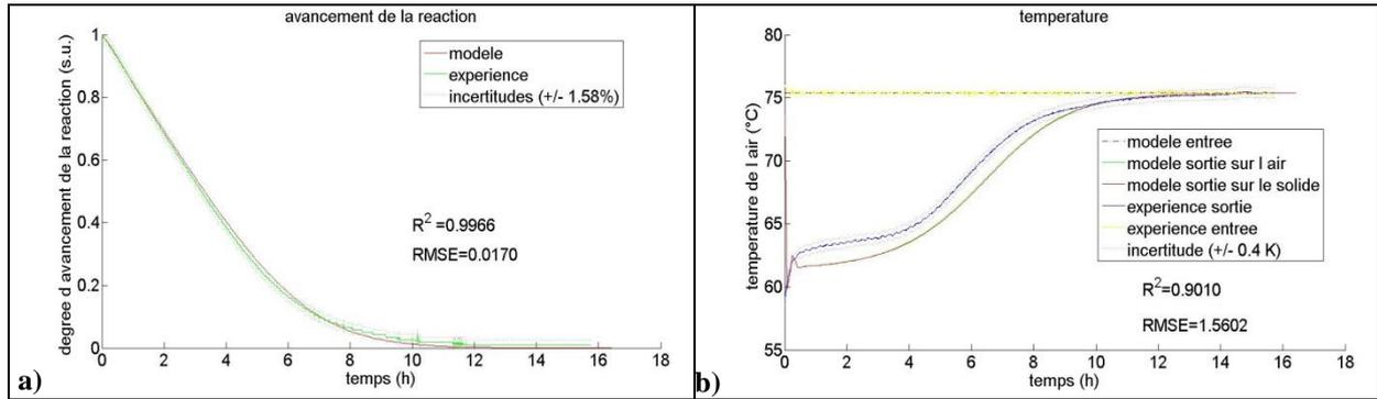
**Figure 117 : Comparaison des résultats expérimentaux et numériques pour la validation du cas numéro 13 de la déshydratation effectuée pour d'autres conditions opératoires en régime stationnaire : a) avancement de la réaction ; b) température de l'air et du solide ; b) température de l'air et du solide.**
