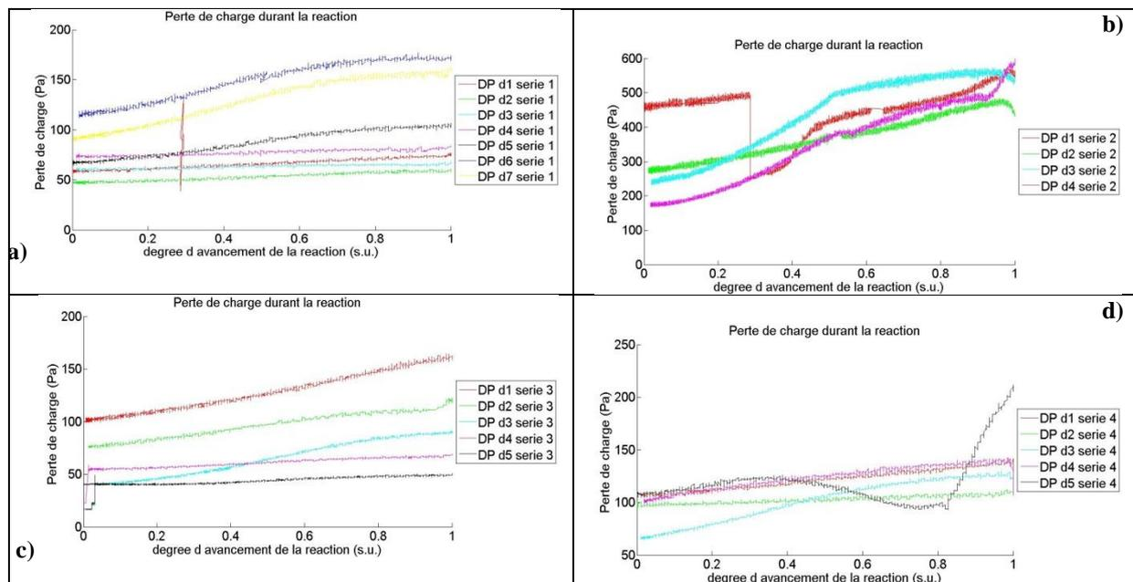
**Figure 98 : Evolution de la perte de charge durant la réaction de déshydratation pour les séries des tests : a) pour la première série ; b) pour la deuxième série ; c) pour la troisième série ; d) pour la quatrième série.**
