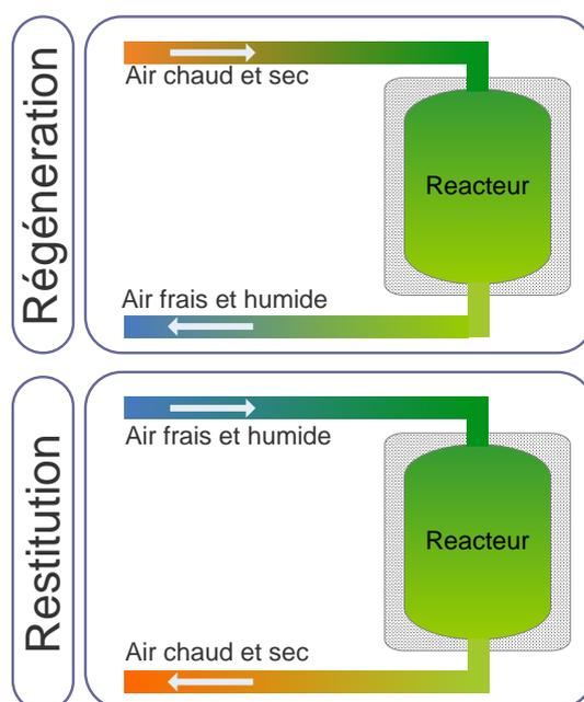
Figure 15 : Système en fonctionnement en air humide.
