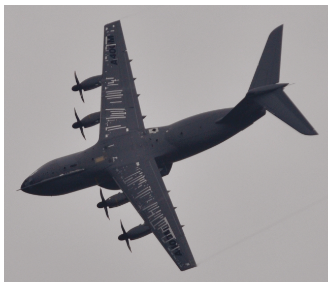
FIGURE 1.3 – Airbus A400M dont les ailes sont recouvertes par des capteurs
