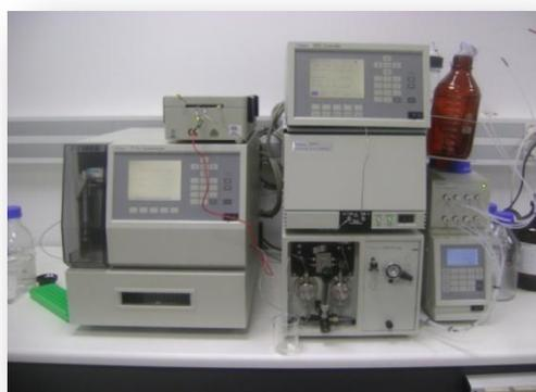
**Photo 2.10.** HPLC (High Performance Liquid Chromatography) utilisée pour les analyses des poly phénols-Laboratoire de Physiologie Fruits et Légumes (EA 42 79)
