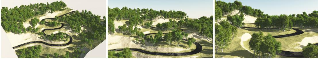
FIGURE 87 : Exemple de route serpentant à travers la montagne. L'artiste a esquissé la scène en mélangeant une centaine de primitives disques pour définir le relief. La trajectoire de la route a été définie à l'aide d'une vingtaine de courbes quadriques et l'opérateur de remplacement a effectué le terrassement. La couche d'asphalte de la route est modélisée avec un arbre de construction et le bord du domaine est découpé proprement avec l'algorithme de raffinage de triangles.
