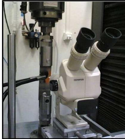
Figure II-20 : Dispositif de suivi optique
