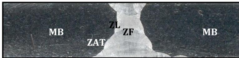
Figure I-2 :: Différentes parties d'un joint soudé (procédé SMAW)
