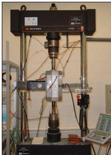
Figure II-17 : Machines électromécaniques de fatigue INSTRON
