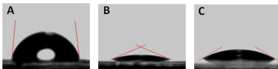
**Figure 64 : Angles de contact d'une goutte d'eau ultra pure mesurée sur substrat d'or nu (A) et fonctionnalisé 3% 16-MHA (B) et 10 % 16-MHA (C).**
