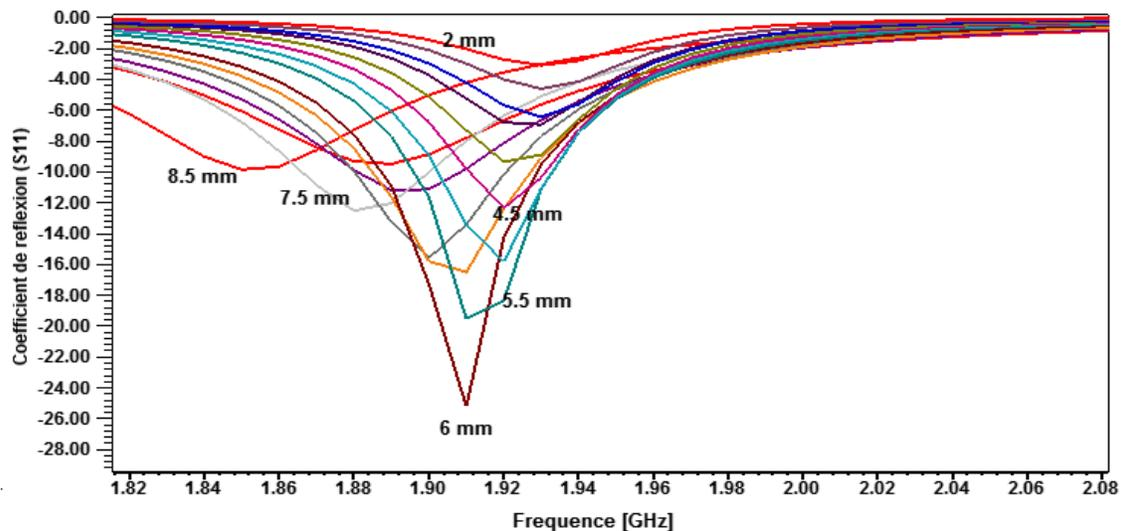
Figure III. 6 : Coefficient de réflexion en fonction de  $h_s$
