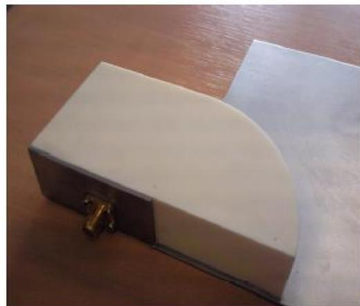
Figure II. 26 : Prototype réalisé de l'antenne, Réf. [78]
