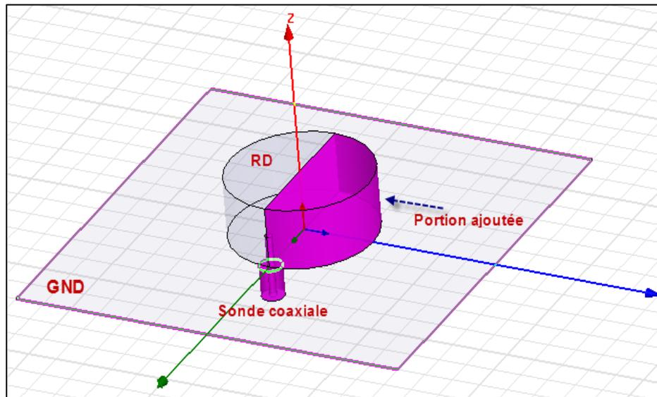
Figure III. 27 : Structure de l'antenne sous HFSS (Alpha=180°)
