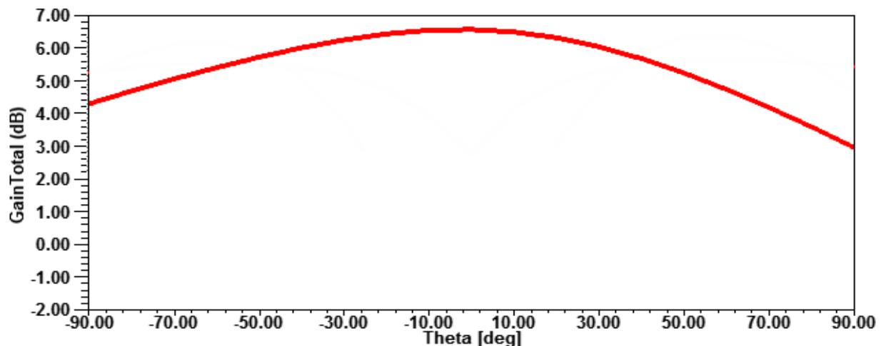
Figure IV. 11 : Gain total de l'antenne pour  $H_2=6.5\text{mm}$ ,  $\epsilon_{r2}=50$
