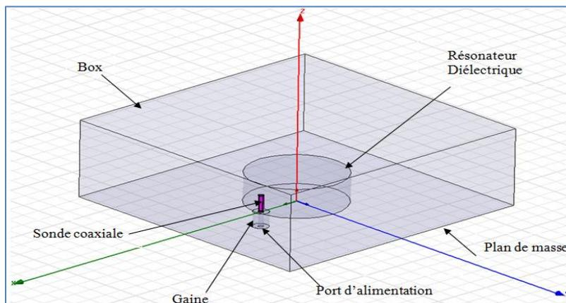
Figure II. 22 : Excitation du mode  $HE_{11\delta}$  avec une sonde coaxiale
