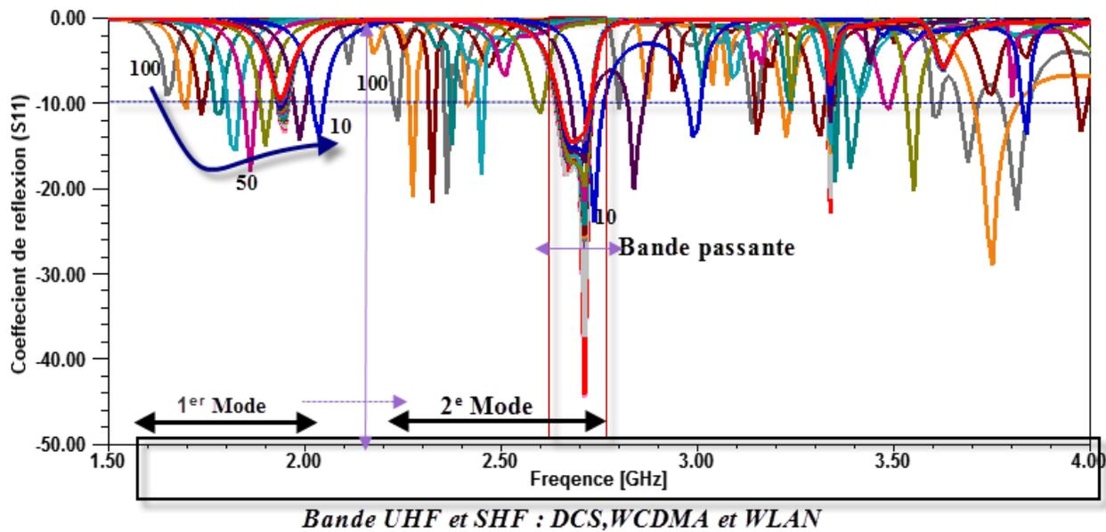
Figure III. 26 : Coefficient de réflexion  $S_{11}$  de l'antenne (Alpha=120°)
