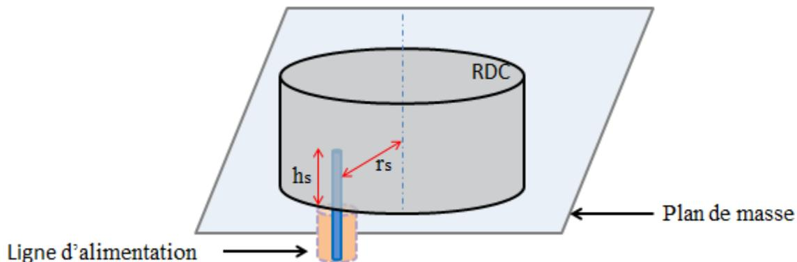
Figure II. 12 : Géométrie de l'alimentation avec sonde coaxiale
