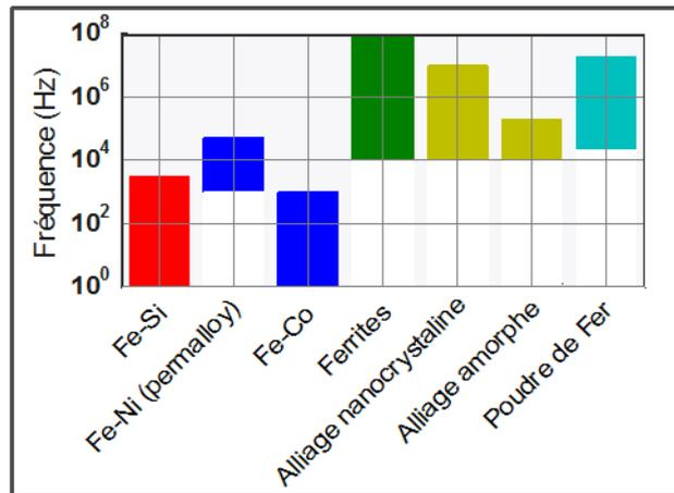
Figure 5.5 – Bandes d'utilisation typique des matériaux ferromagnétiques
