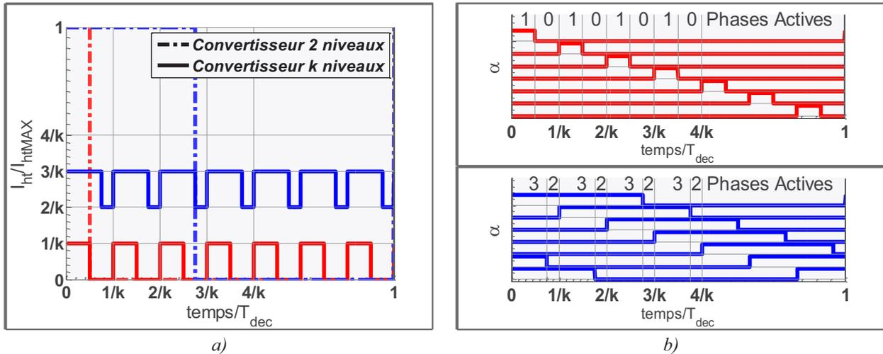
Figure 2.9 – Formes d’ondes d’un convertisseur multicellulaire parallèle
