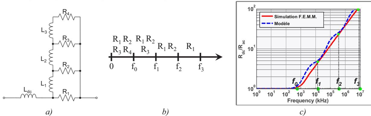
Fig. 1 – Modèle de conducteur avec l'effet de peau
