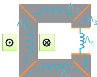
1. On définit les tubes d'induction et on associe une perméance à chaque tube.
