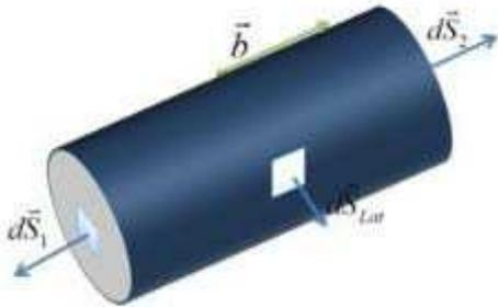
$$\oint_{S_e} \vec{b} \cdot d\vec{S} = \iint_{S1} \vec{b} \cdot d\vec{S} + \iint_{S2} \vec{b} \cdot d\vec{S} + \iint_{SLat} \vec{b} \cdot d\vec{S} = 0$$
