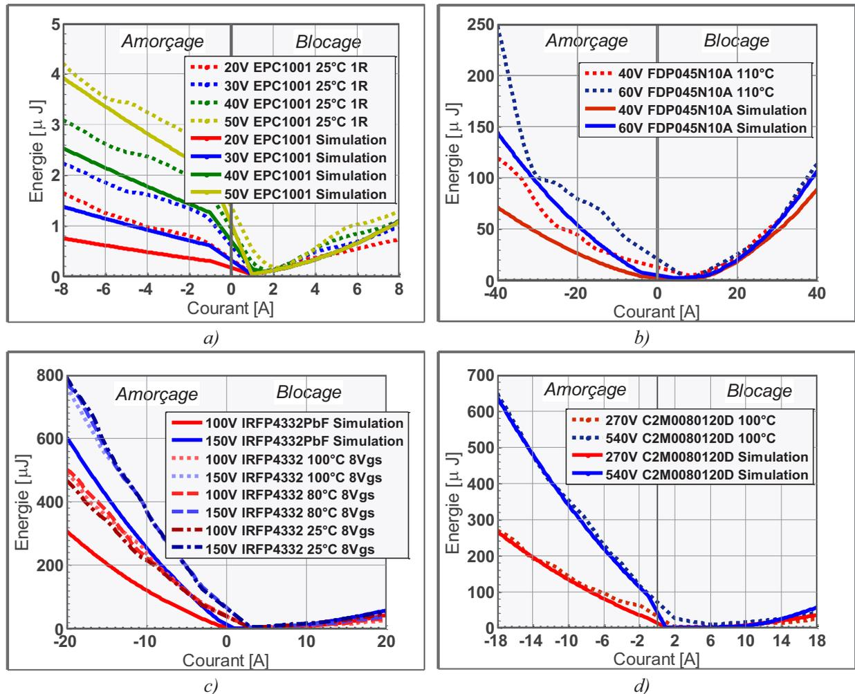
Figure 4.21 –Energies de commutation Mesures et Simulés en fonction du courant commuté et de la tension pour des : a) Composants HEMT GaN 100V / EPC1001 avec  $R_g=1\Omega$  b) Composants MOSFET Si 100V / FDP045N10A avec  $R_g=20\Omega$  c) Composant MOSFET Si 250V / IRFP4332 avec  $R_g=2\Omega$  d) Composants MOSFET SiC 1200V / C2M0080120D avec  $R_g=20\Omega$
