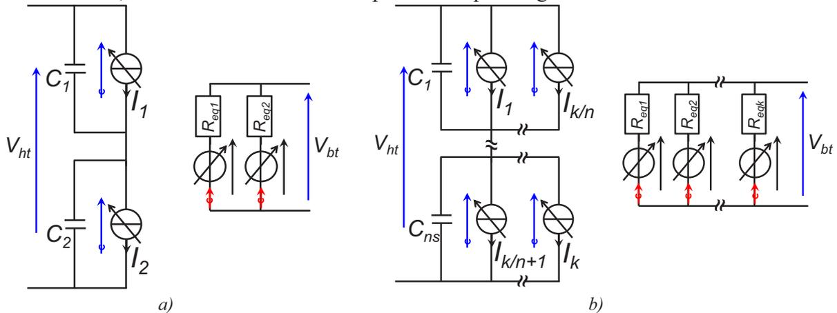
Figure 3.22 – Modèle moyen de la mise en série des cellules de commutation côté haute tension
