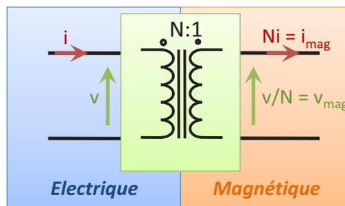
Du côté électrique nous avons une tension  $v$  et un courant  $i$  et du côté magnétique nous avons un courant  $N \cdot i$  qui représente l'intégrale  $\oint_C \vec{h} \cdot d\vec{l}$  e que nous appellerons un courant
