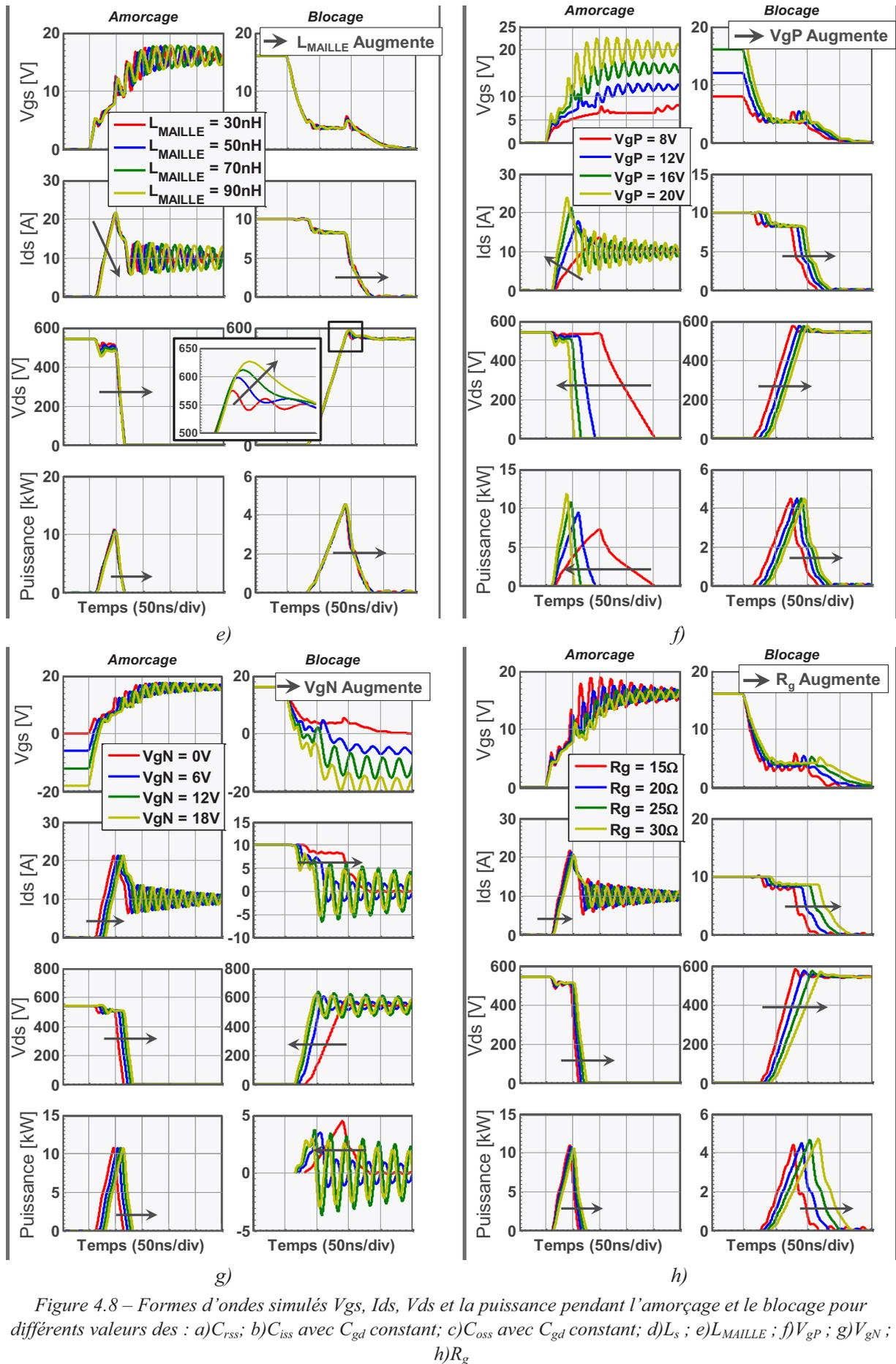
Figure 4.8 – Formes d'ondes simulés  $V_{gs}$ ,  $I_{ds}$ ,  $V_{ds}$  et la puissance pendant l'amorçage et le blocage pour différents valeurs des : a)  $C_{rss}$ ; b)  $C_{iss}$  avec  $C_{gd}$  constant; c)  $C_{oss}$  avec  $C_{gd}$  constant; d)  $L_s$ ; e)  $L_{MAILLE}$ ; f)  $V_{gP}$ ; g)  $V_{gN}$ ; h)  $R_g$
