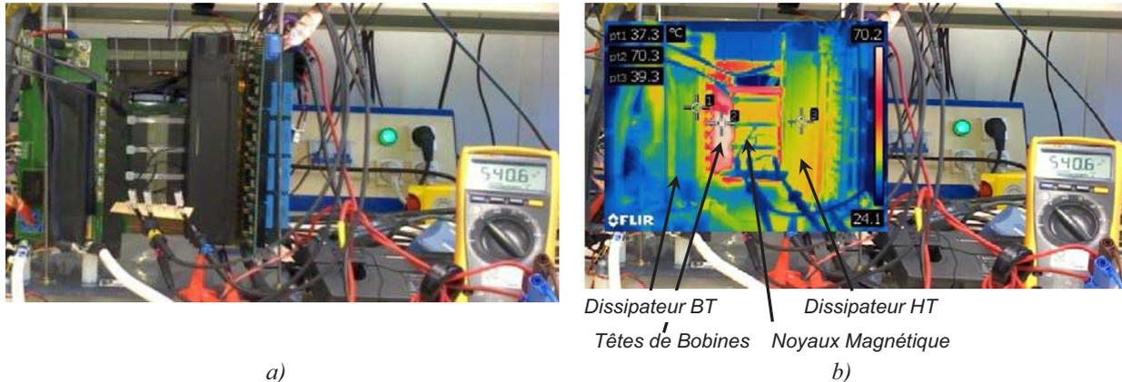
Figure 6.26 – Cartographie thermique a) Image Réel b) Cartographie thermique 540V/26V 284A
