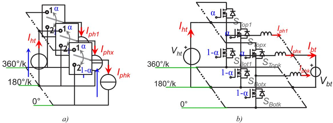
Figure 2.8 – Convertisseurs multicellulaires parallèles avec une commande entrelacée
