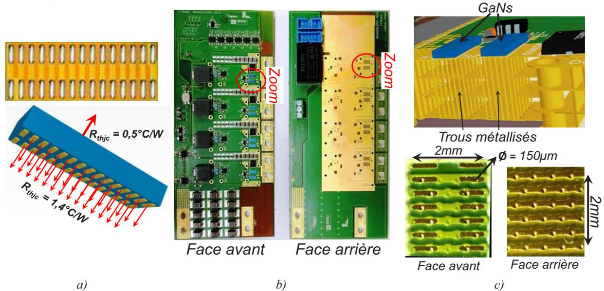
Figure 6.8 – Refroidissement carte BT d'épaisseur 500 $\mu\text{m}$  a) Boîtier des composants GaN b) Vue du circuit imprimé c) en haut la vue éclatée du PCB avec les trous métallisés (84 trous par composant), en bas la finition des trous métallisés
