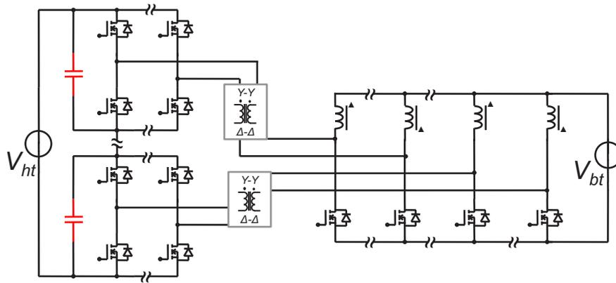
Figure 3.19 – Mise en série côté haute tension des cellules de commutation
