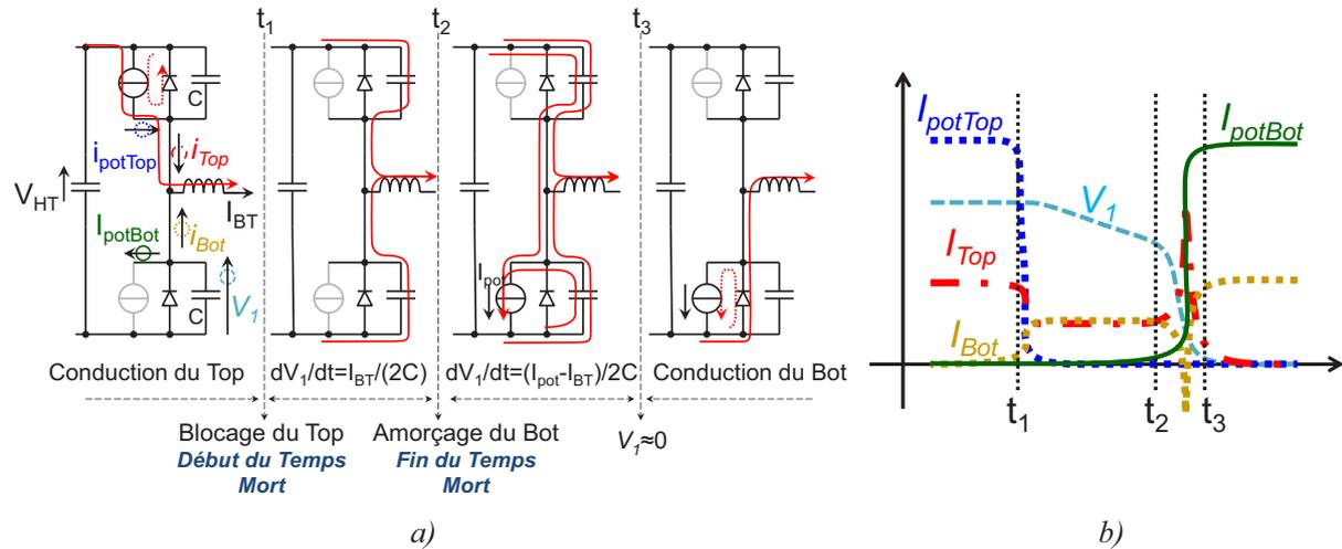
Figure 4.23 – Blocage commandé pour des faibles courants
