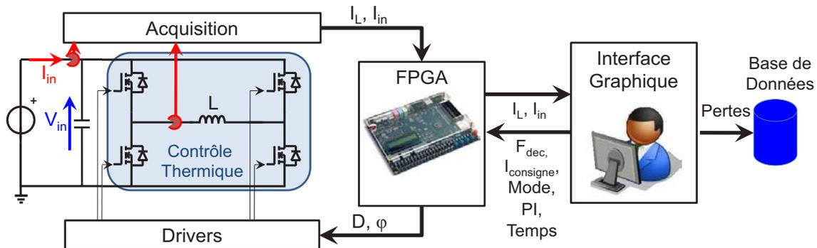
Figure 4.17 – Schéma Synoptique de la carte de mesure des pertes par commutation
