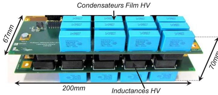
Figure 6.14 – Réalisation du filtre différentiel haute tension
