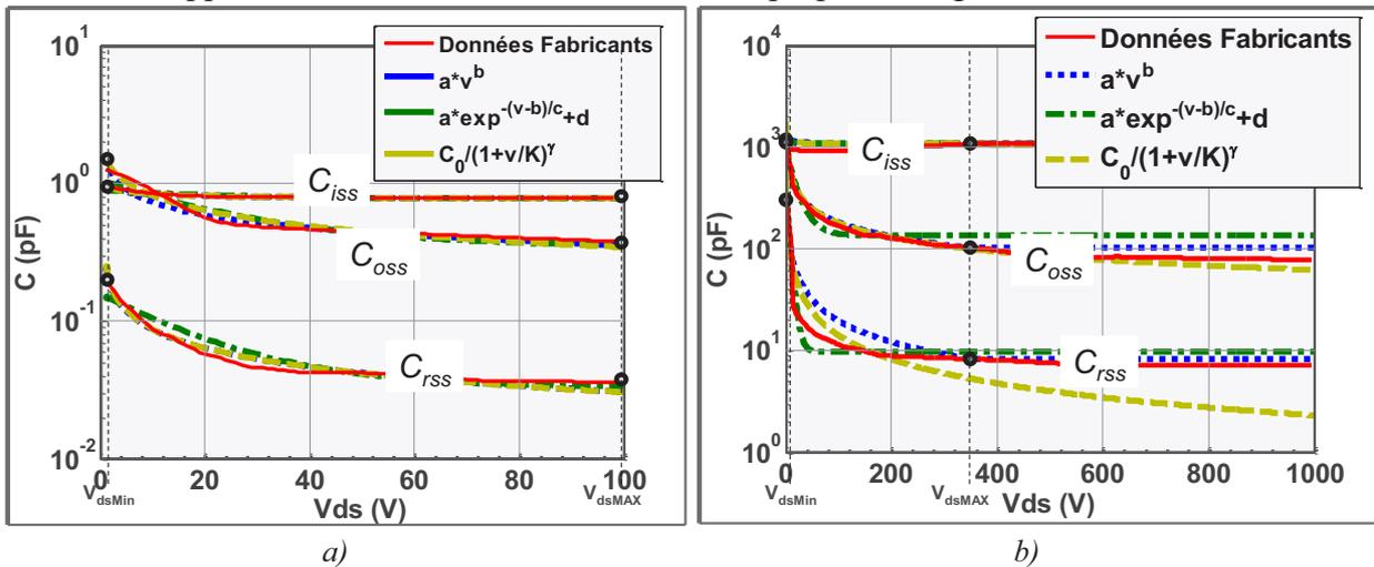
Figure 4.4 – Evolution des capacités parasites en fonction de  $V_{ds}$  – Comparaison des Modèles analytiques
