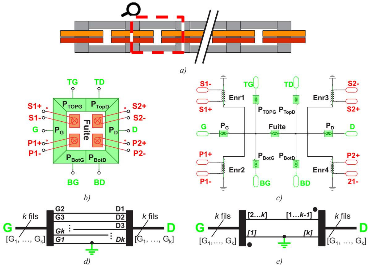
Figure 5.14 – Simulation vectorielle a) localisation d'une fenêtre dans un coupleur b) Définition des réluctances et des bornes d'une fenêtre c) modèle aux perméances/inductances d'une fenêtre d) connexion des faces latérales des fenêtres e) connexion des faces latérales des fenêtres à l'aide d'un multiplexeur vectorisé
