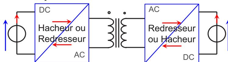
Figure 1.2 – Schéma synoptique d'un convertisseur statique isolé
