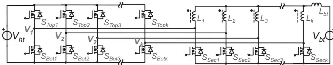
Figure 3.5 – Topologie multicellulaire DC/DC non-isolée
