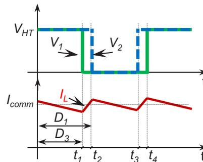
Figure 4.12 – Formes d'onde typiques pour le mode de commutation dure
