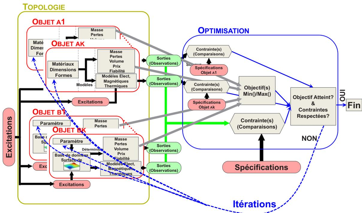
Figure 2.6 – Schéma d'Optimisation d'une topologie possédant plusieurs dispositifs (objets)
