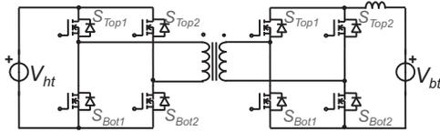
Dévolteur: Voltage Fed utilisée en [23]. [24]
