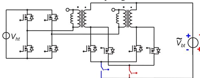
Figure 3.8 – Topologie de conversion statique DC/AC isolé
