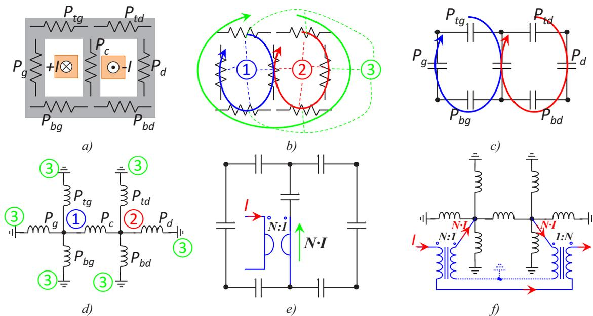
Figure 5.13 – Modèles électriques équivalents a) forme géométrique modélisée b) modèle aux réluctances c) modèle aux perméances/condensateur d) modèle aux perméances/inductance e) inclusion de l'excitation du modèle perméances/condensateur f) inclusion de l'excitation du modèle perméances/inductance
