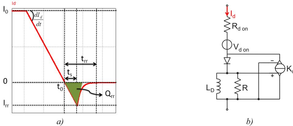
Fig. 2 – Modèle circuit de la diode avec recouvrement
