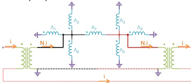
Nous pouvons lier le côté magnétique soit en série soit à la référence. (Dans le premier cas on applique directement la tension A-B aux bornes des transformateurs, dans le deuxième on applique une tension A au borne d'un transformateur et une tension B à l'autre, la résultante sera toujours la tension A-B).
