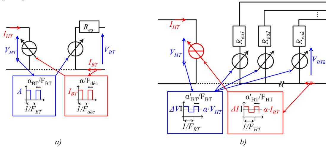
Figure 2.10 – Modélisation des convertisseurs statiques vus de bornes
