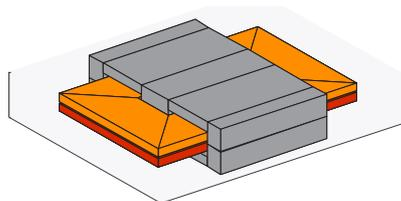
Figure 5.3 – Forme d'un transformateur en noyau E
