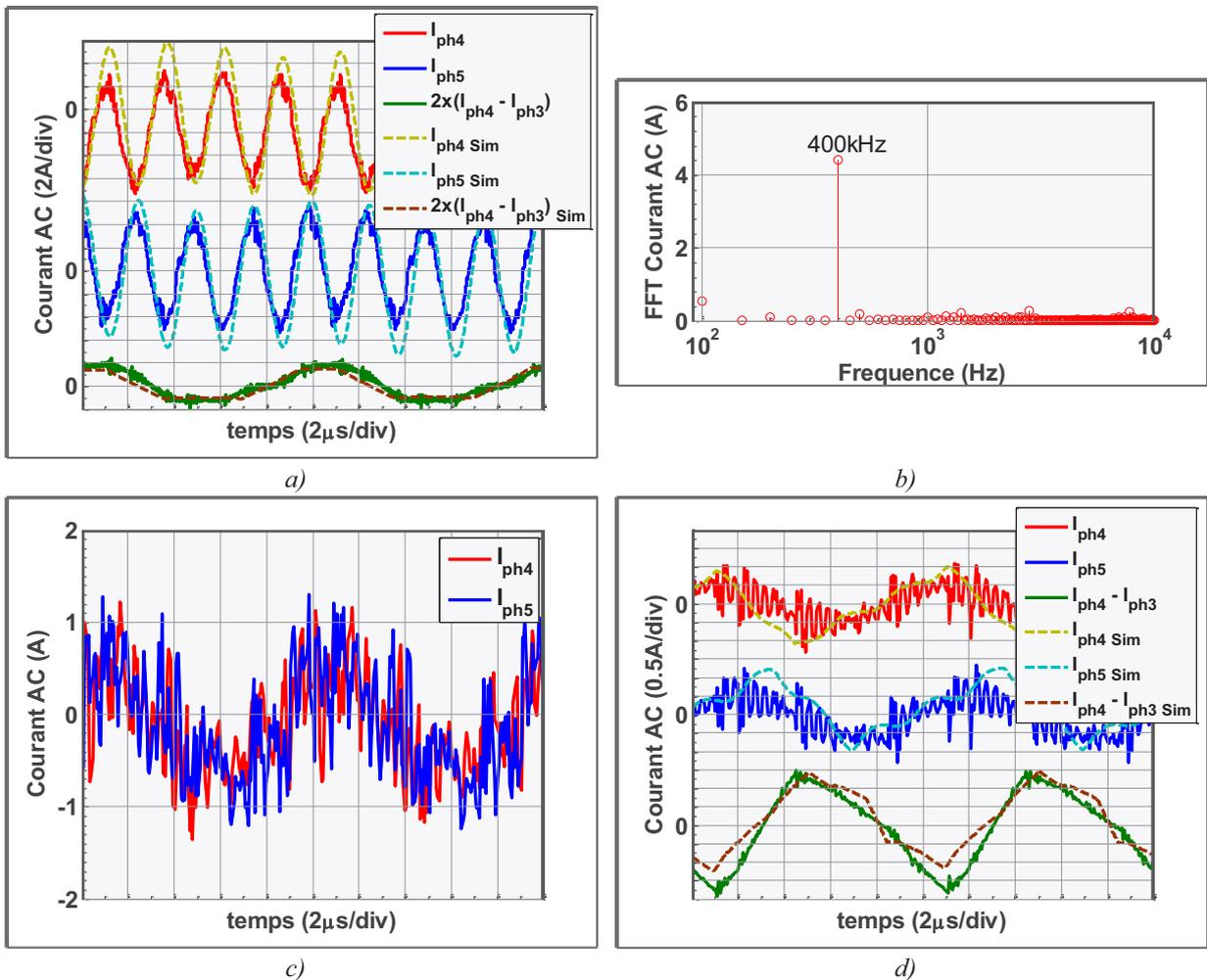
Figure 6.24 – Courant des enroulements pour une tension HT égale à 50V a) Courants pour un Déphasage 45° b) FFT du courant  $I_{ph4}$  c) Courant pour un déphasage de 45° sans la composante à 400kHz d) Courants pour un déphasage de 90°
