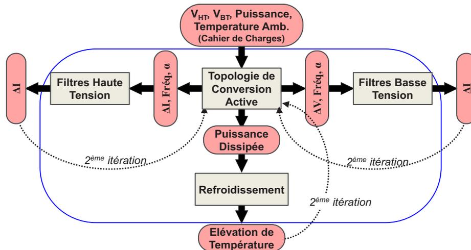
Figure 2.4 – Description du flux d'informations entre les topologies d'un convertisseur
