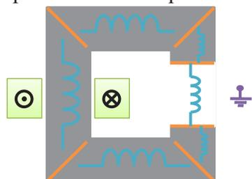
2. On écrit un «boucle de flux» pour le conducteur d'aller. Notons que le bobinage en dehors de la fenêtre ne nous intéresse pas.
