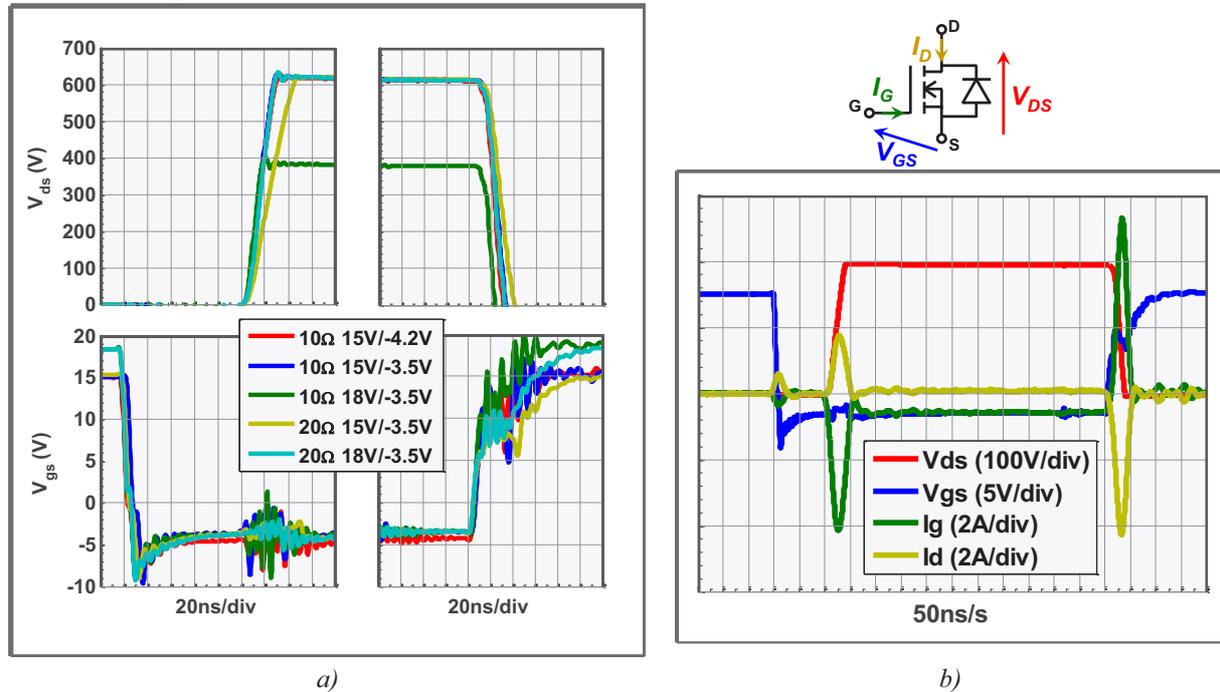
Figure 6.6 – Formes d'ondes à la commutation des interrupteurs SiC sans courant de charge
