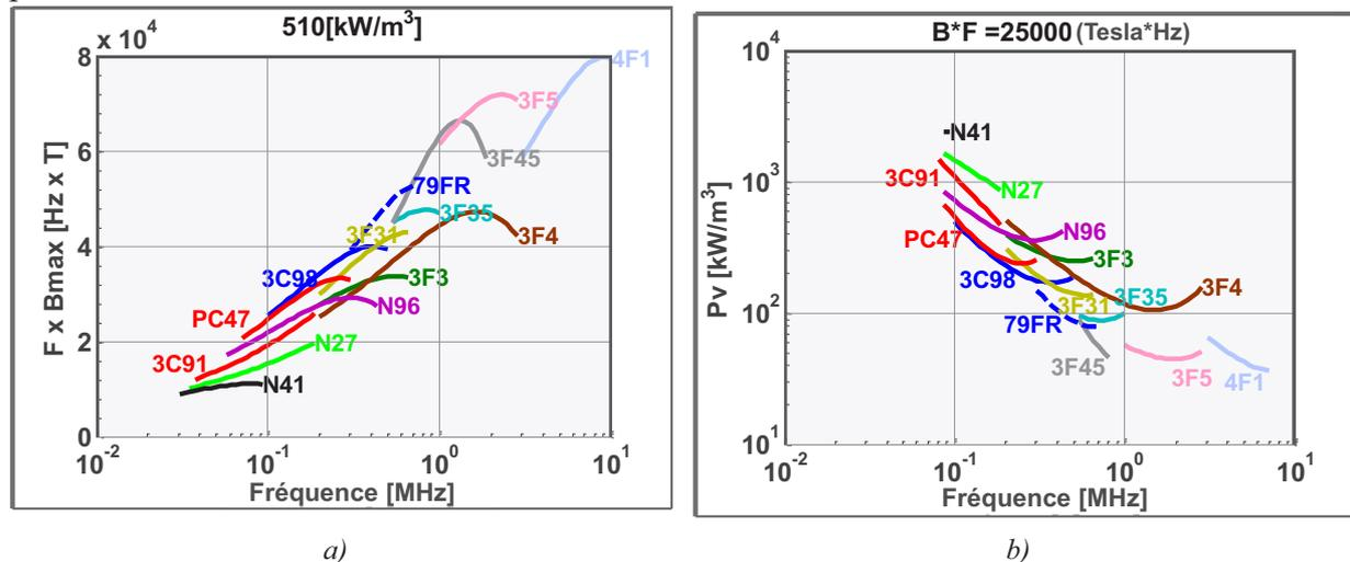
Figure 5.8 – a) Facteur de performance de certaines ferrites pour une puissance volumique de 500kW/mm³ b) Puissance dissipé pour un pair B.F égal à 2500Tesla\*Hz en fonction de la fréquence
