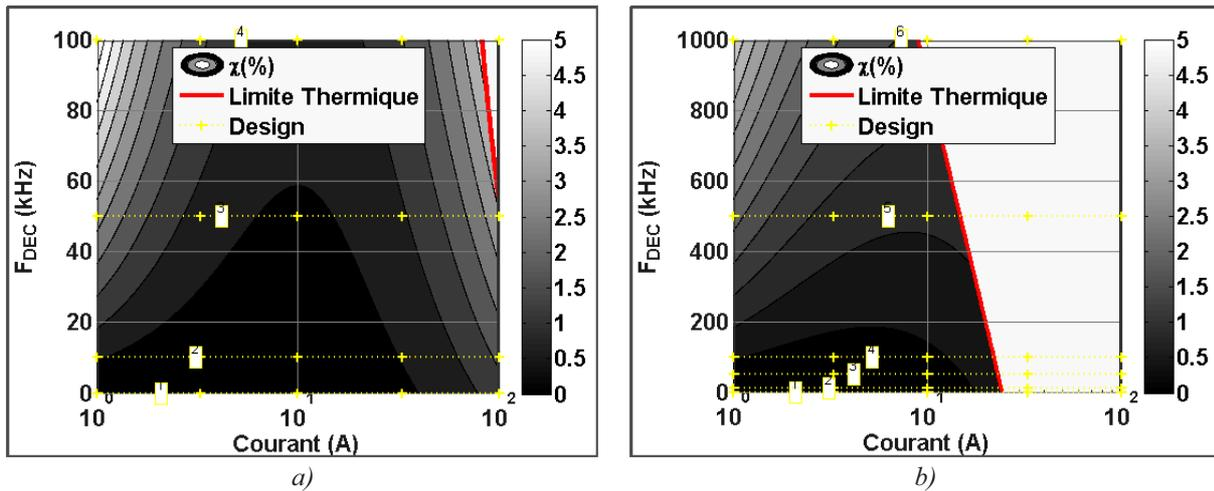
Figure 2.11 – Evolution du coefficient de pertes pour une tension de 40V
