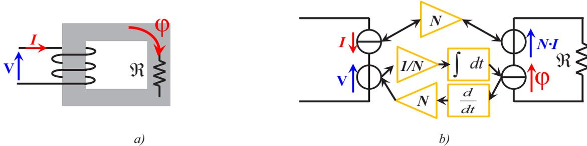
Figure 5.10 – Description du modèle aux Réluctances a) forme géométrique modélisée b) schéma électrique équivalent
