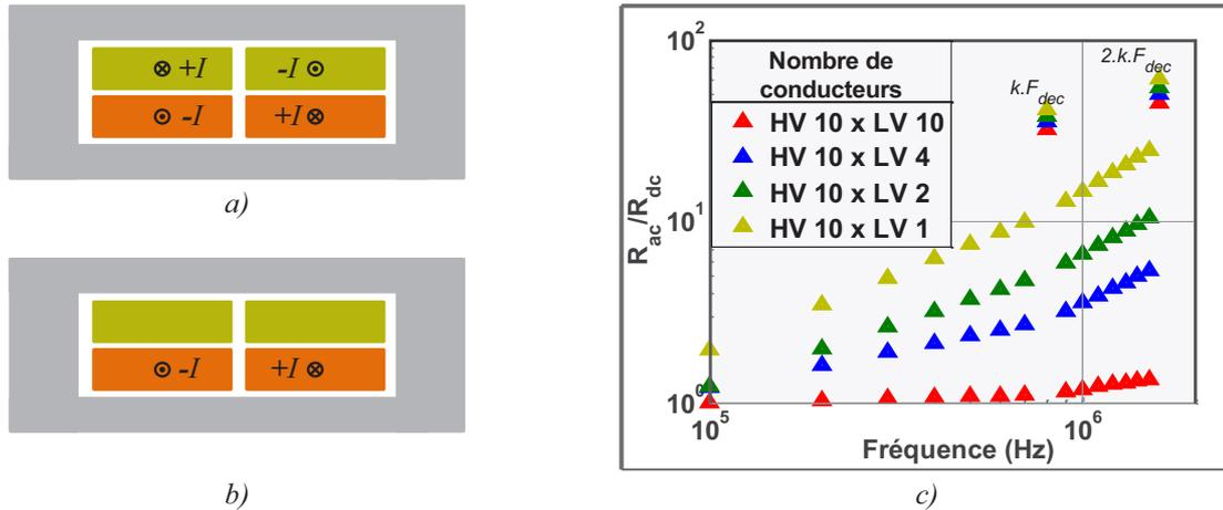
Figure 5.18 – Distribution du courant entre les bobinages a) fréquences non-multiples de  $k \cdot F_{dec}$  b) fréquences multiples de  $k \cdot F_{dec}$  c) Evolution de la résistance avec la fréquence avec  $F_{dec} = 100\text{kHz}$  et  $k=8$  pour un rapport de transformation 1 :10 en fractionnant le conducteur basse tension
