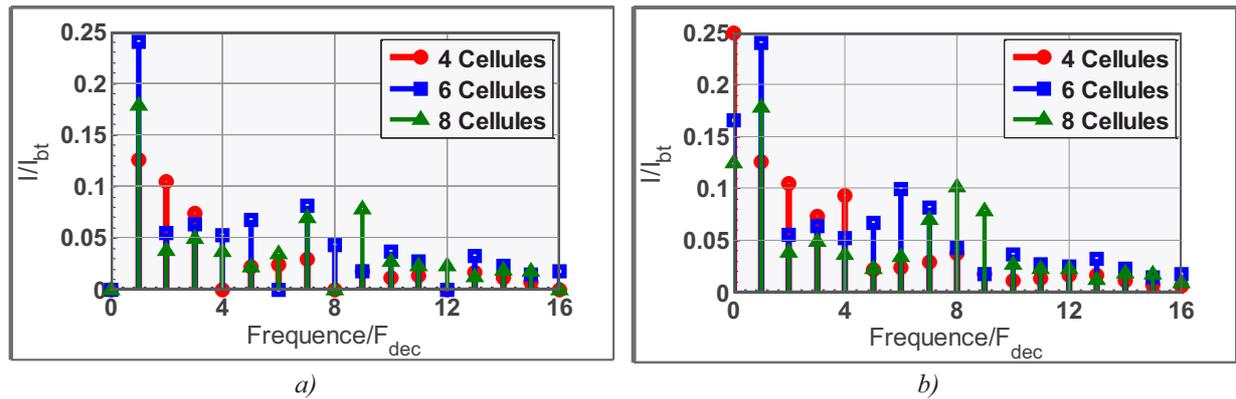
Figure 3.12 – Harmoniques de courants dans les enroulements du transformateur a) enroulement côté haute tension b) enroulement côté basse tension
