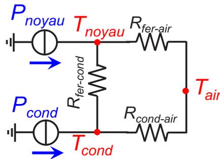
Figure 5.20 – Modèle thermique du coupleur simplifié
