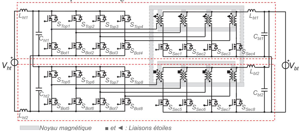
Figure 6.1 – Topologie de conversion DC/DC isolée choisie avec couplage négatif des enroulements des transformateurs: en rouge la délimitation des deux convertisseurs
