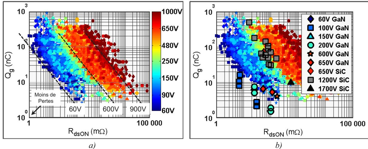
Figure 1.4 – Figure de Mérite  $Q_g$  vs  $R_{dsON}$  pour plusieurs références de semi-conducteurs
