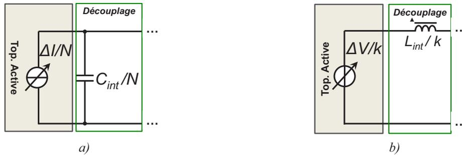
Figure 2.15 – Circuit simplifié de l'étage de découplage
