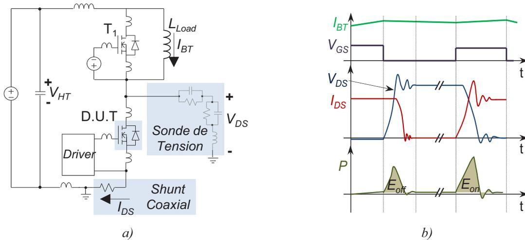
Figure 4.10 – Méthode de la double impulsion pour la mesure des énergies de commutation
