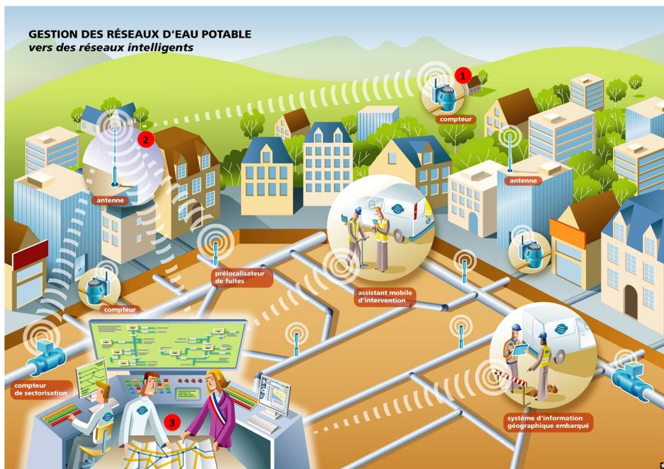
FIGURE 2.8 – Le fonctionnement du télérelevé des compteurs d'eau
