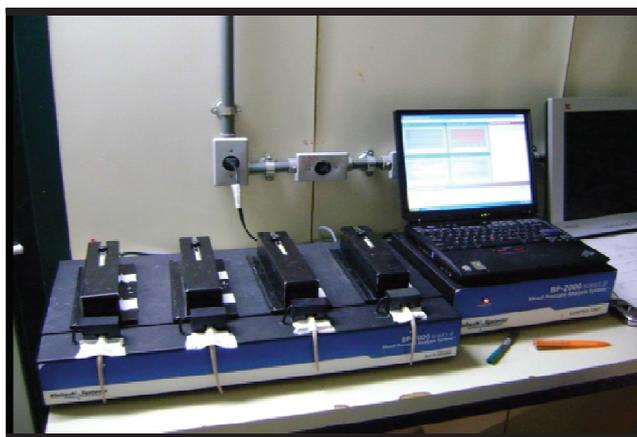
**Figura 3.2:** Sistema para registro indireto da pressão arterial caudal em ratos.
