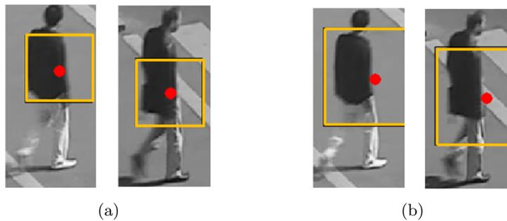
FIGURE 5.24 – Exemple de régions descriptives en jaunes : (a)  $\sigma = 2$ , (b)  $\sigma = 3$  (les points rouges sont des SURFs).
