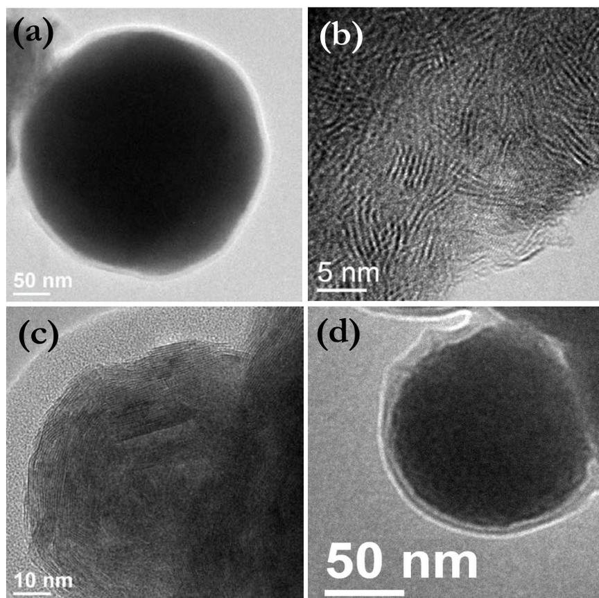
Figure D. 3. 1. Images HR-TEM des nanoparticules IF-MoS<sub>2</sub> de type LC (a), LpC (b), SC (c) et SpC (d)
