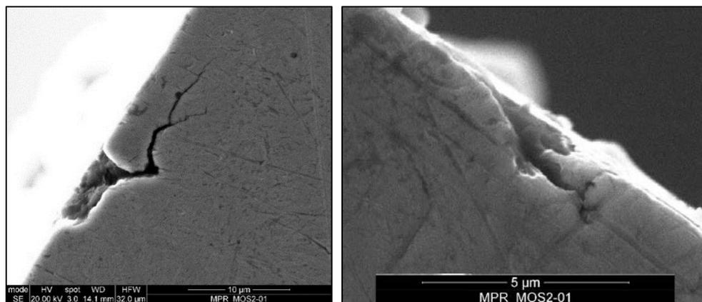
**Figure D. 5. 6.** Coupe du galet testé en présence de PAO seule (gauche) et de PAO + 1 wt% IF-MoS<sub>2</sub> (droite)
