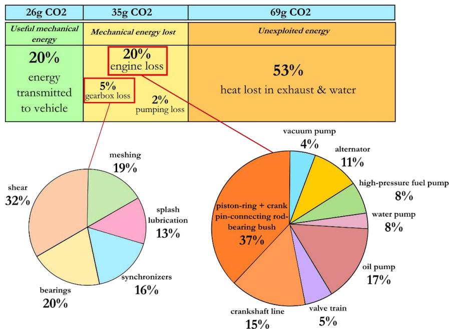
**Figure D. 2. 1.** Estimation des principales sources de pertes d'énergie et émissions de CO<sub>2</sub> correspondantes pour un moteur Diesel 1.6L classique et sa boîte de vitesses (valeurs extraites de données PSA Peugeot Citroën)
