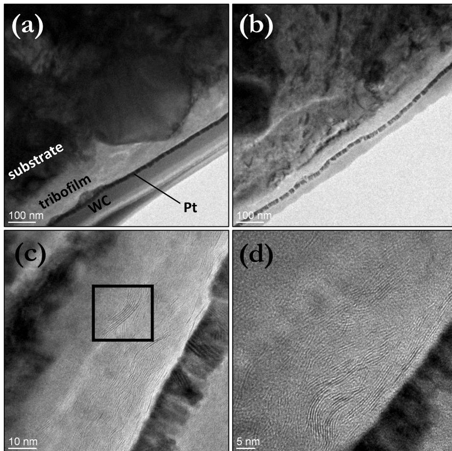
**Figure D. 3. 4.** Coupe FIB de la trace d'usure résultante de l'essai HFRR du mélange PAO+1% IF-MoS<sub>2</sub>SpC correspondantes en fin d'essai.
