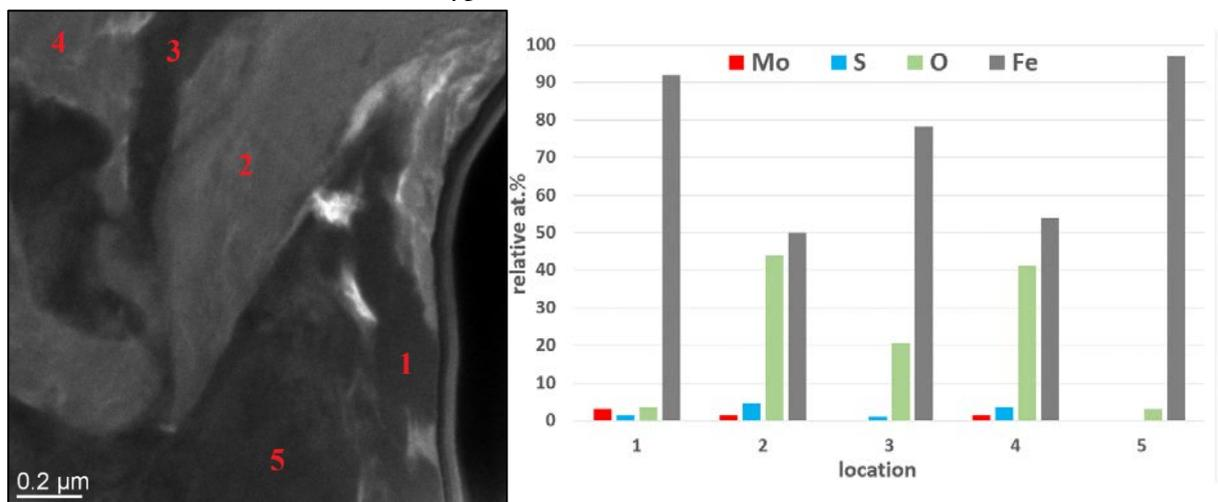
**Figure D. 3. 5.** Analyses EDX réalisées en différents points de la coupe FIB de la trace d'usure correspondant à l'essai des IF-MoS<sub>2</sub> de type LC
