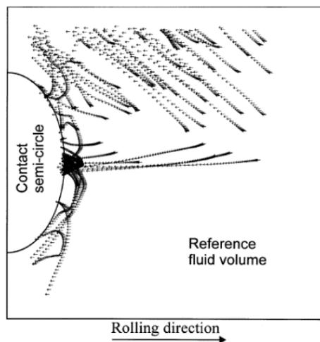
**Figure D. 2. 6.** Prédiction de la trajectoire d'une particule de 20 µm lorsqu'elle est placée aléatoirement en amont d'un contact EHD ( $h_c=0.3$  µm)
