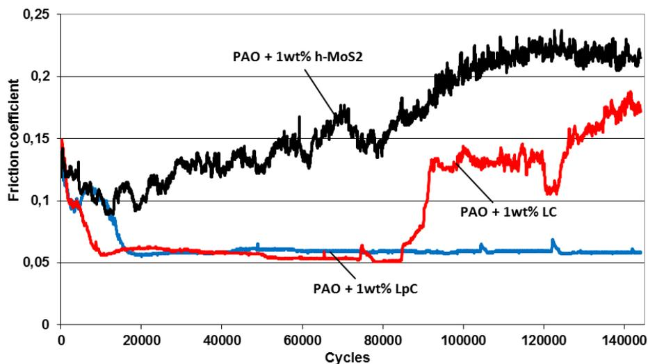
Figure D. 3. 6. Comparaison des propriétés tribologiques de particules h-MoS<sub>2</sub> et de nanoparticules IF-MoS<sub>2</sub>
