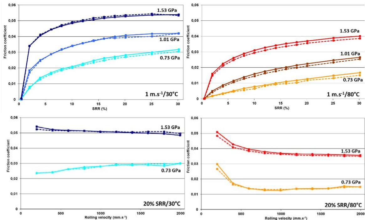
**Figure D. 5. 3.** Courbes de traction (haut) et de Stribeck (bas) dans des conditions de lubrification en film complet : PAO seule (pointillés) et PAO + IF-MoS<sub>2</sub> (lignes continues), essais à 30°C (bleu) et à 80°C (jaune/rouge)
