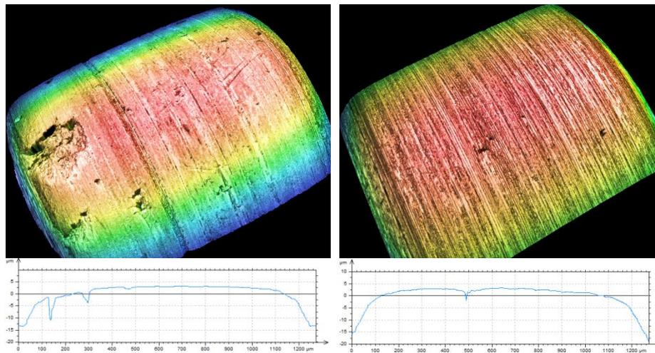
**Figure D. 5. 5.** Topographies 3D et profils des surfaces résultantes des essais MPR pour la PAO seule (gauche) et la PAO + 1 wt% IF-MoS<sub>2</sub> (droite)
