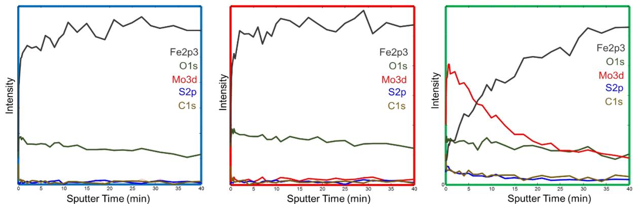
**Figure D. 4. 3.** Profils XPS réalisés par abrasion ionique sur les traces d'usure correspondants aux essais montrés sur la **Figure D. 4. 1** : PAO + dispersant (bleu), PAO + dispersant + IF-MoS<sub>2</sub> (rouge), PAO + IF-MoS<sub>2</sub> (vert)
