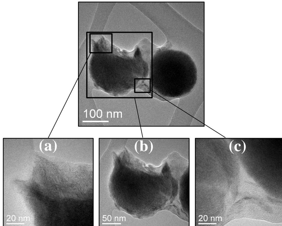
**Figure D. 4. 5.** Nanoparticules prélevées après essai tribologique en présence de dispersants – IF-MoS<sub>2</sub> endommagée (gauche) et intacte (droite)
