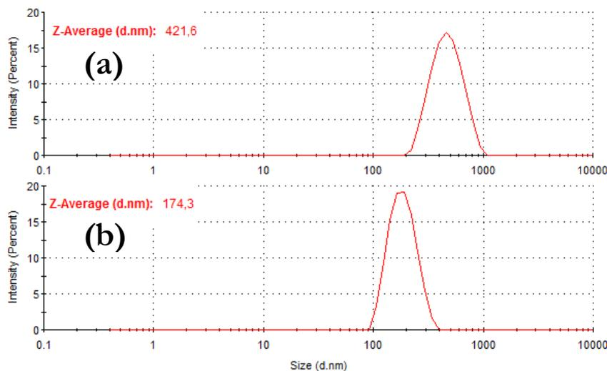
**Figure D. 4. 2.** Distribution des tailles d'agglomérats de nanoparticules SpC pour les huiles contenant 1% IF-MoS<sub>2</sub> sans dispersant (a) et avec 5% de dispersant (b)
