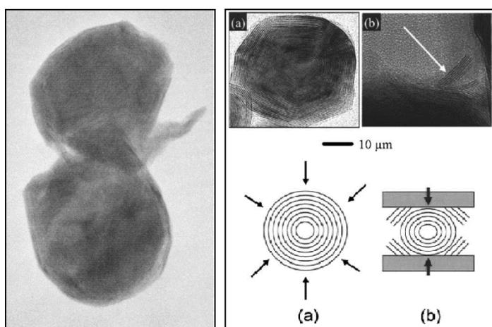
**Figure D. 2. 4.** Exfoliation d'IF- $WS_2$  telle qu'observée par Leshchinsky et al (gauche) et Joly-Pottuz et al (en haut à droite), et comportement schématique de nanoparticules de type fullerène sous pression hydrostatique (a) et uni-axiale (b)
