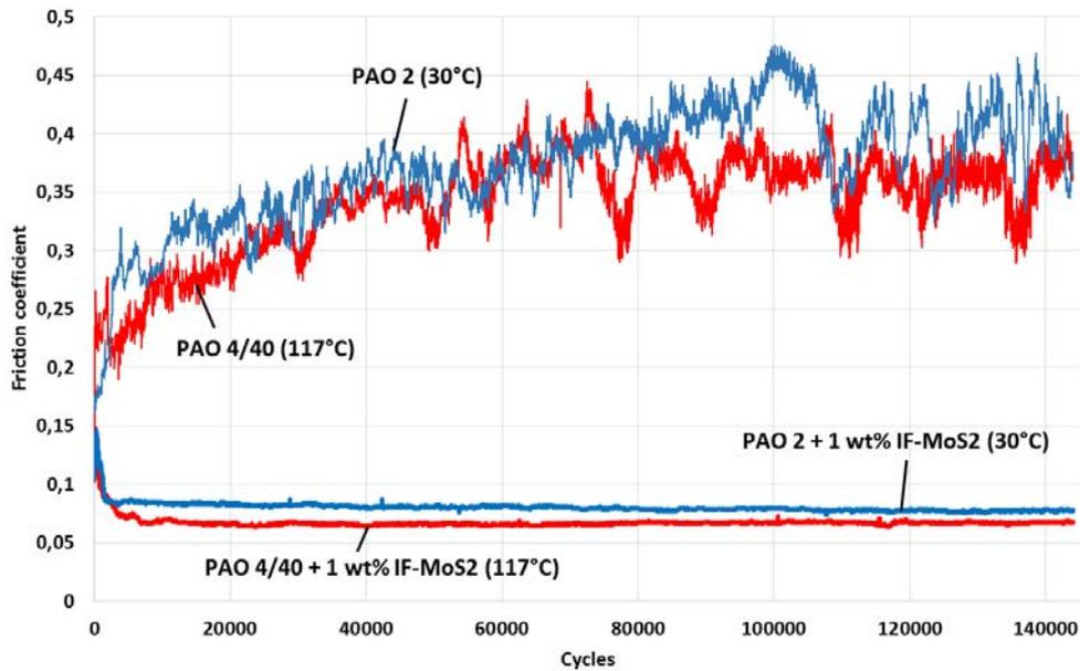
Figure D. 5. 1. Essai HFRR d'une PAO 2 à 30°C (bleu) et de la PAO 4/40 à 117°C (rouge) avec et sans 1 wt% IF-MoS<sub>2</sub>SpC
