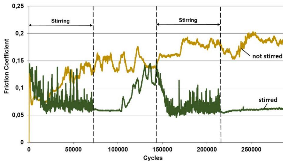
Figure D. 3. 3. Performance accrue des IF-MoS<sub>2</sub> de type LC lors de la modification du flux d'huile aux alentours du contact
