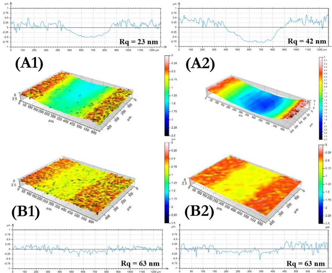
**Figure D. 5. 4.** Topographies et profils de surface mesurés à l'issue des essais réalisés à 10% (1) et 50% (2) de SRR pour la PAO seule (A) et la PAO + IF-MoS<sub>2</sub> (B). Les valeurs de Rq sont déterminées en ne prenant en compte que la trace d'usure.
