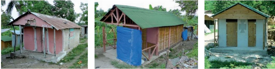
Fig.18: Haïti: a) habitat existant ; b) abri fourni après le séisme de 2010 ; c) pérennisation de l'abri par l'application d'un enduit en ciment
