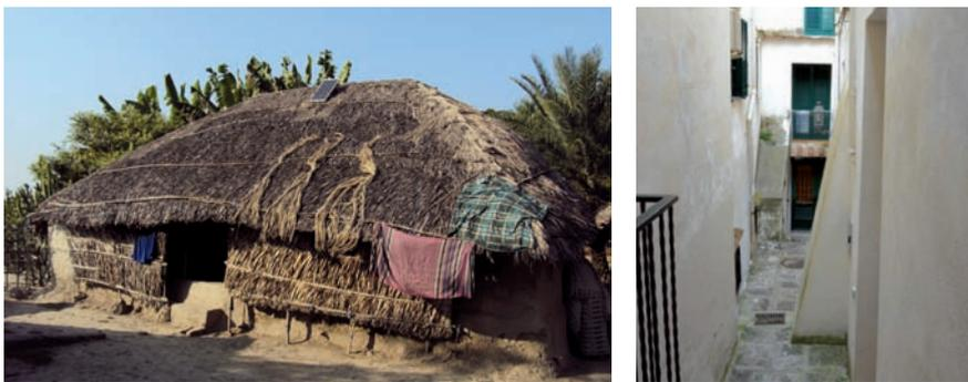
Fig.71: a) Forme trapue et toiture à quatre pentes : aérodynamisme morphologique envers les vents cycloniques (Khulna, Bangladesh) ;
