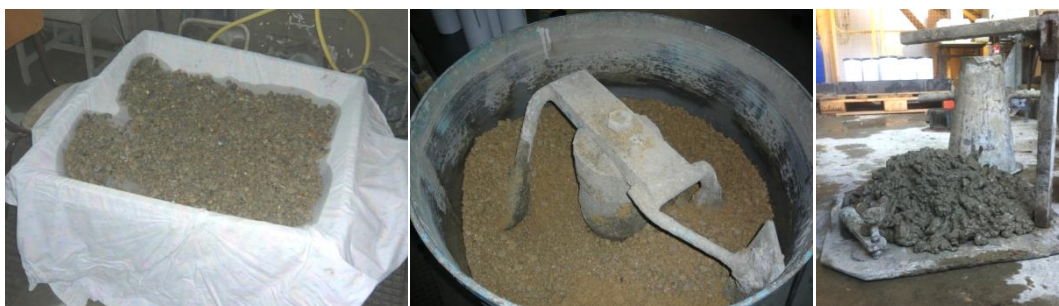
Figure 3-1. Procédure de mise en œuvre (a) égouttage des granulats (b) malaxage des matériaux secs et (c) essai d'affaissement au cône d'Abrams
