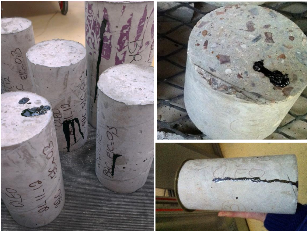
Figure 4-25. Combustion de déchets de construction non cimentaires dans les éprouvettes de BRI
