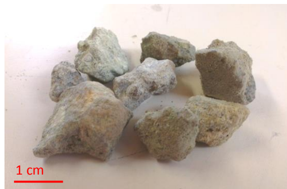
Figure 2-15. Les granulats recyclés industriels (GRI)
