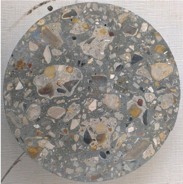
Figure 4-10. BRL 0.3 avant chauffage
