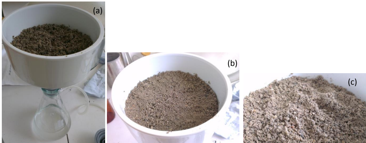
Figure 2-4. Photographies montrant l'évolution de l'état hydrique du sable a : au démarrage du pompage, b : après 5 minutes de pompage, c : après 10 minutes de pompage.
