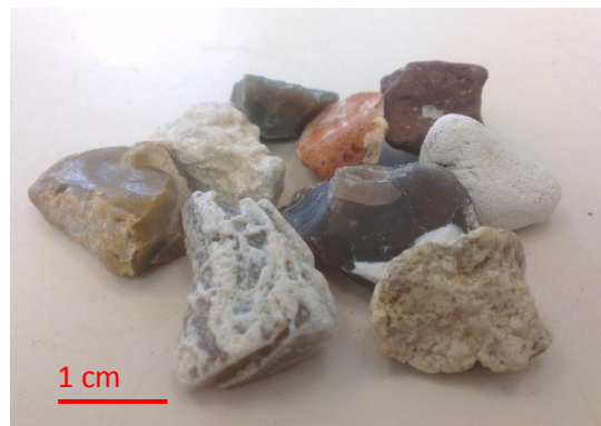
Figure 2-16. Les granulats silico-calcaires naturels (GSC)
