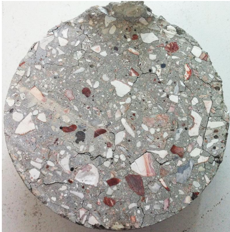
Figure 4-9. BRI 0.6 après chauffage à (a) 450°C et (b) 750°C
