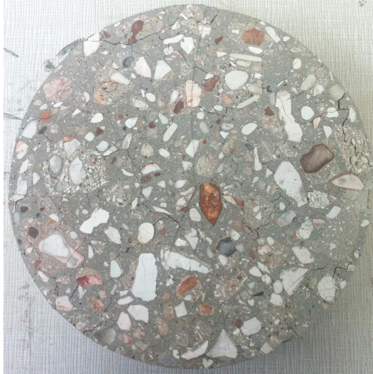
Figure 4-13. BRI 0.3 après chauffage à (a) 450°C et (b) 750°C
