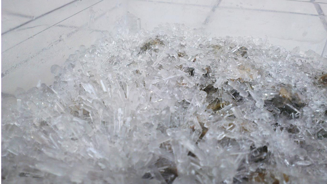
Figure 2-19. Résultat de la cristallisation du sulfate de sodium au contact des granulats de laboratoire
