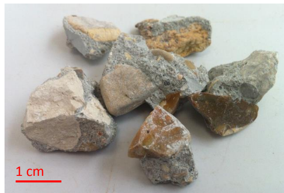
Figure 2-13. Granulats Recyclés de Laboratoire (GRL)
