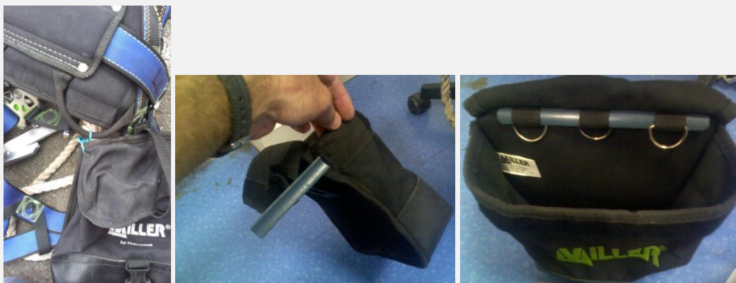
Figure 38 : raccrochage des sacoche par des fils de cuivre ; adaptation avec des tiges en plastique.
