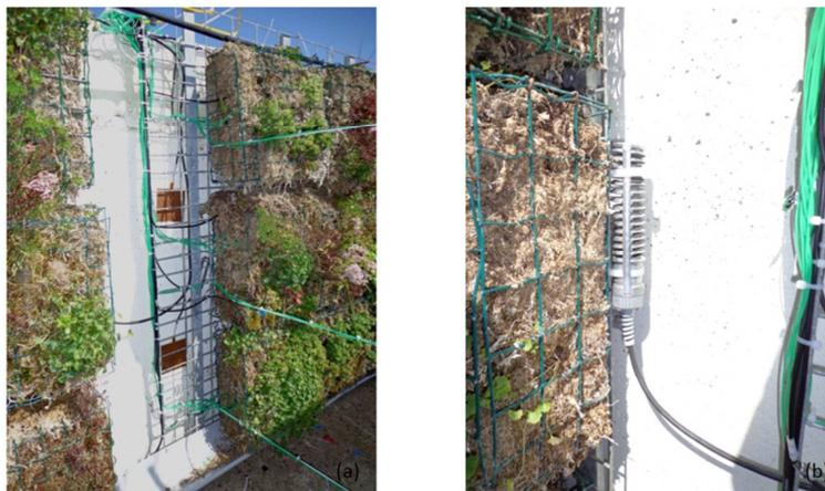
Figure 3-9 : Positionnement (a) des thermocouples, des capteurs de flux thermique et (b) de l'hygromètre dans le système du mur végétal
