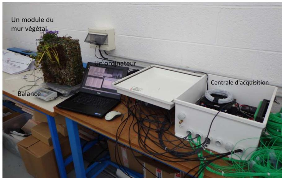
Figure 3-12 : Étalonnage des sondes de teneur en eau
