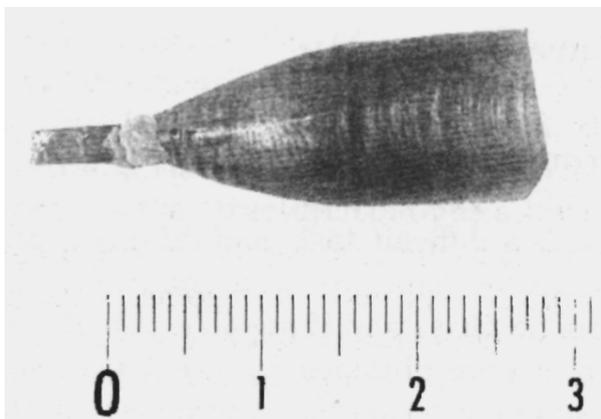
Figure I-4 : Echantillon de AlPdMn produit par tirage Czochralski. Cette méthode permet d'obtenir des échantillons quasicristallins avec un seul domaine (monograins), de plusieurs centimètres de longueur et d'un diamètre pouvant atteindre le centimètre [12]. L'échelle dans la figure est en centimètre.
