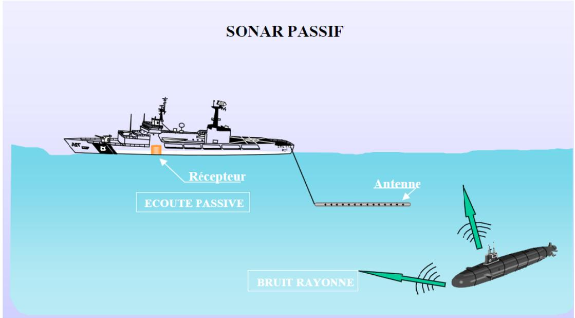
Figure 2 : Principe du SONAR passif [4]
