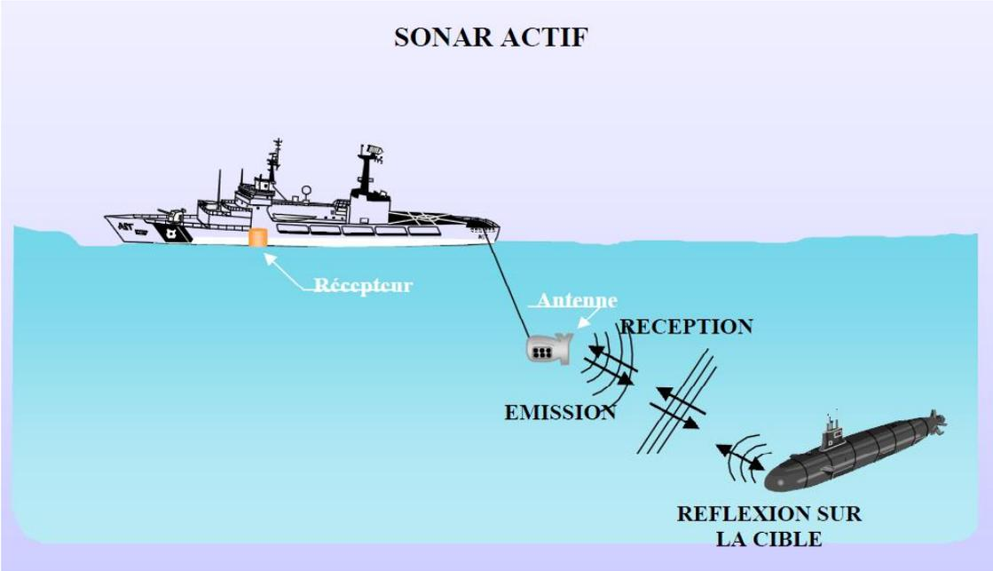
Figure 1 : Principe du SONAR actif [4]
