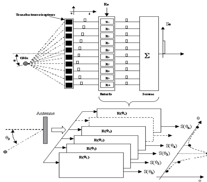
Figure 4 : Illustration du principe de formation de voies [4]
