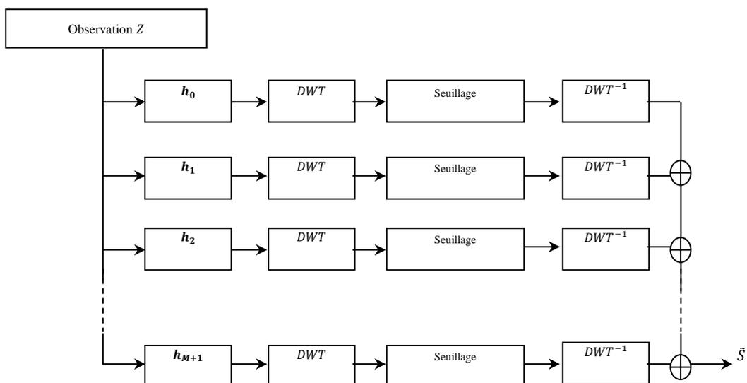
Figure 43: Schéma fonctionnel du processus de débruitage proposé
