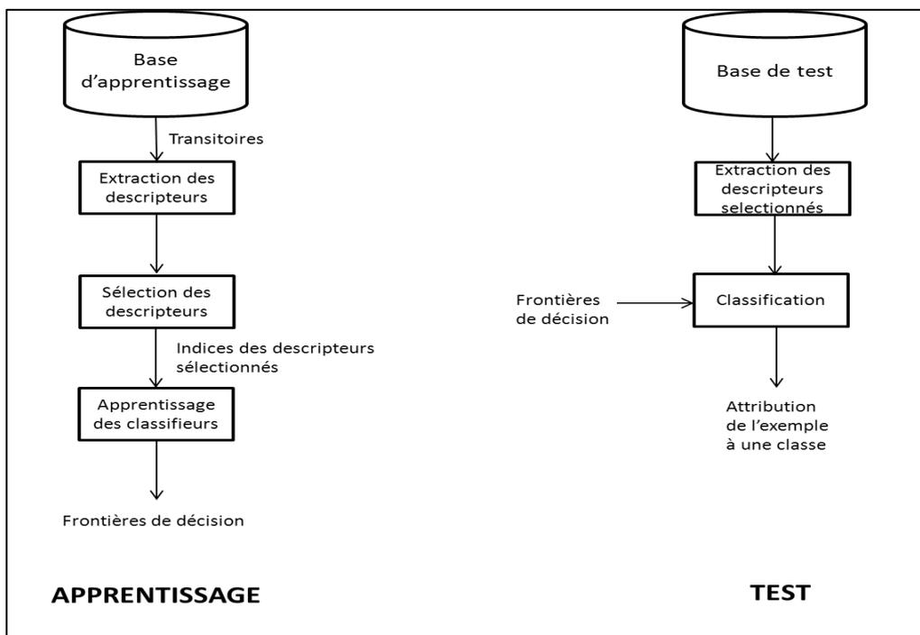
Figure 55: Description des étapes de la classification supervisée
