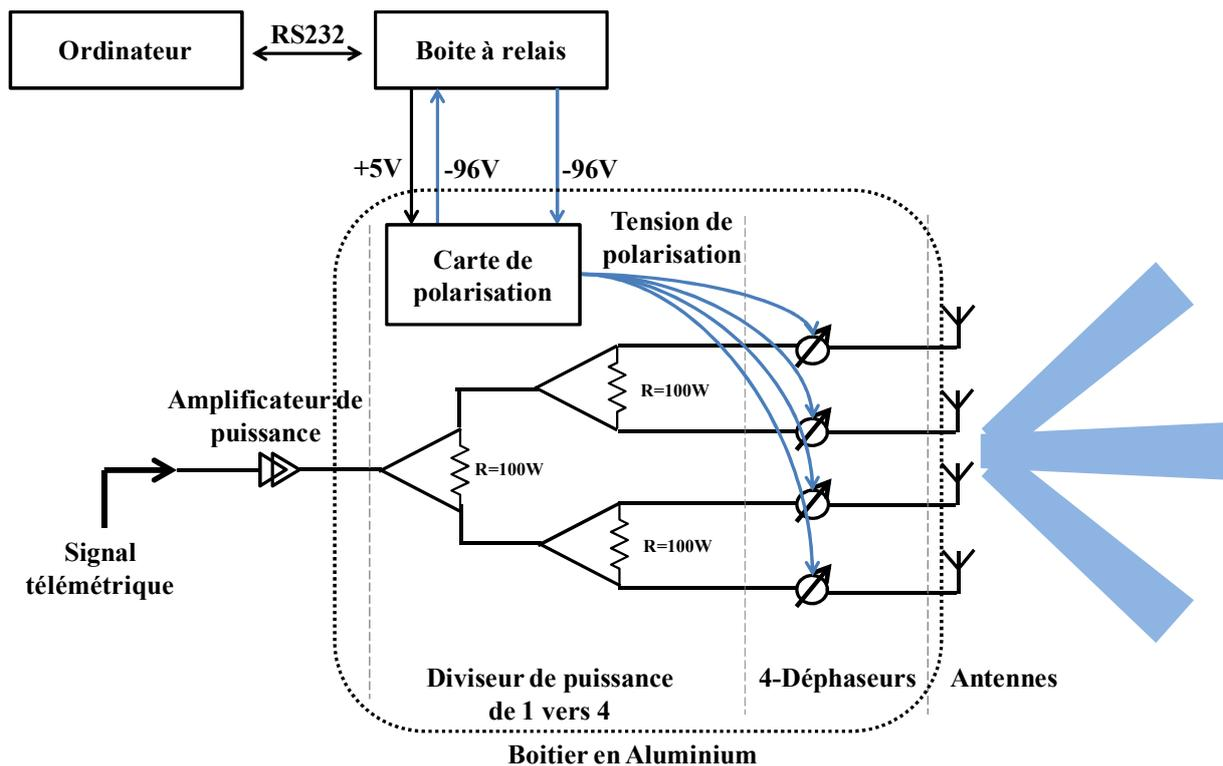
Figure I-1 : Schéma du prototype
