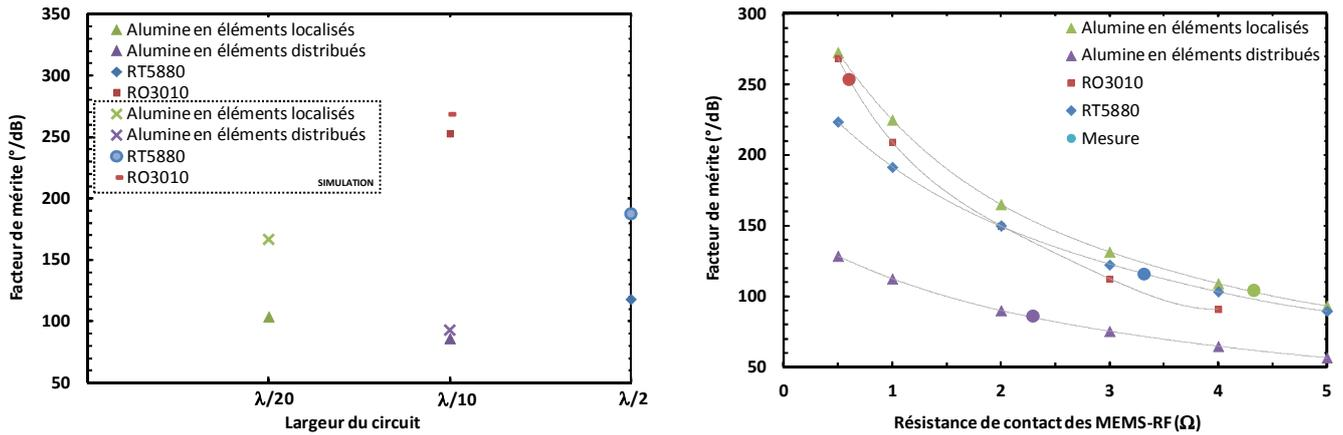
Figure IV-0-1 : Evolution du facteur de mérite en fonction de la taille du circuit et de la résistance de contact des MEMS-RF
