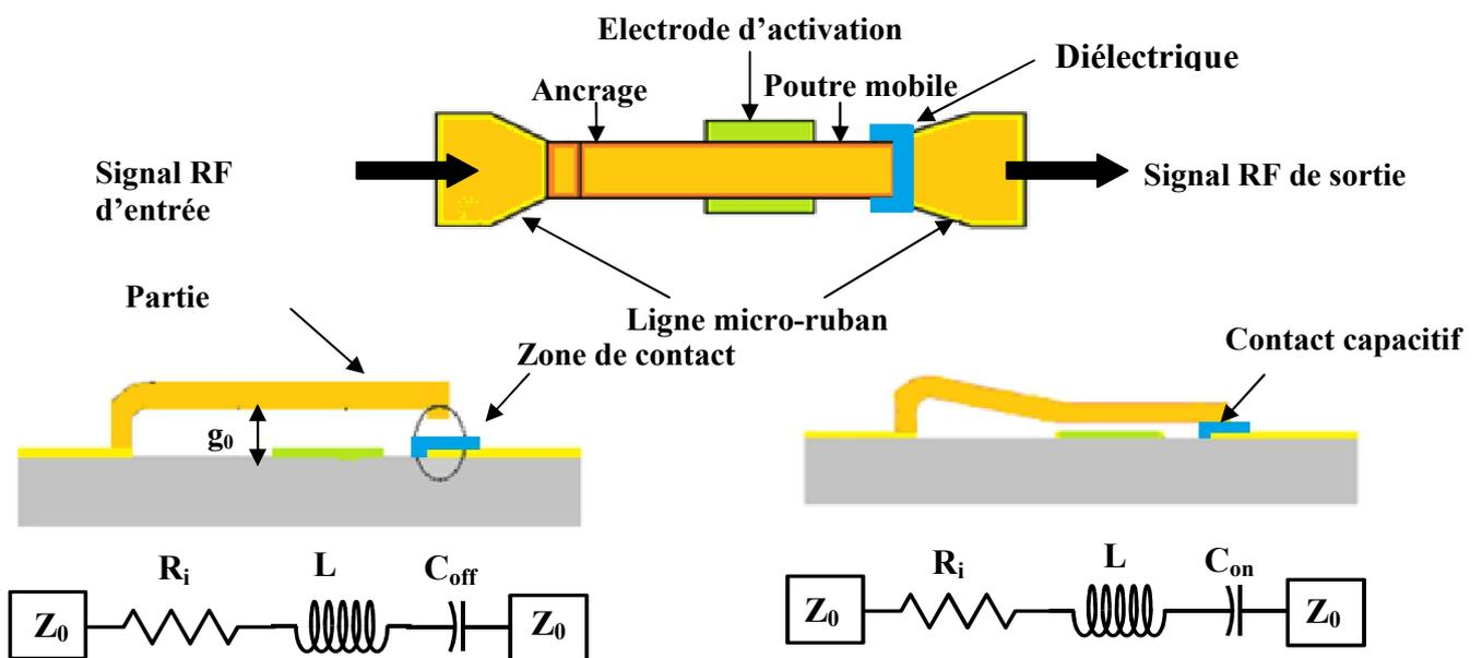
Figure IV-6 : illustration et schéma équivalent d'un switch capacitif
