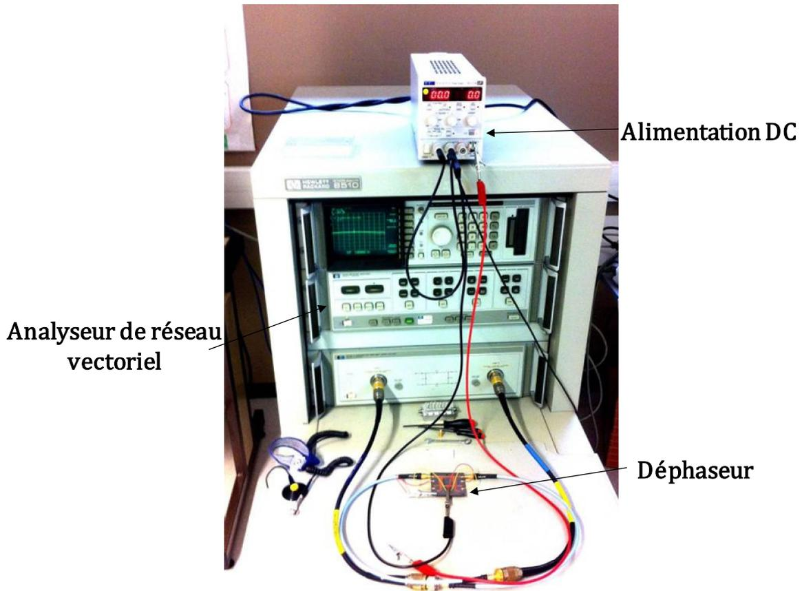
Figure V-2 : Montage de mesure
