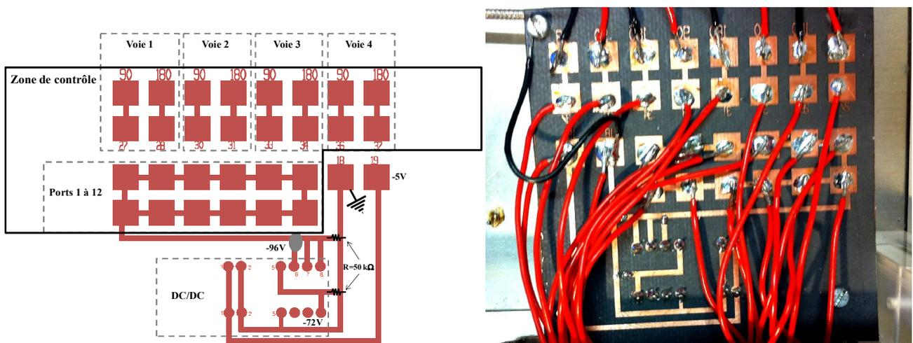
Figure I-5 : Carte d'alimentation pour les MEMS-RF sur les déphaseurs 60\*60mm
