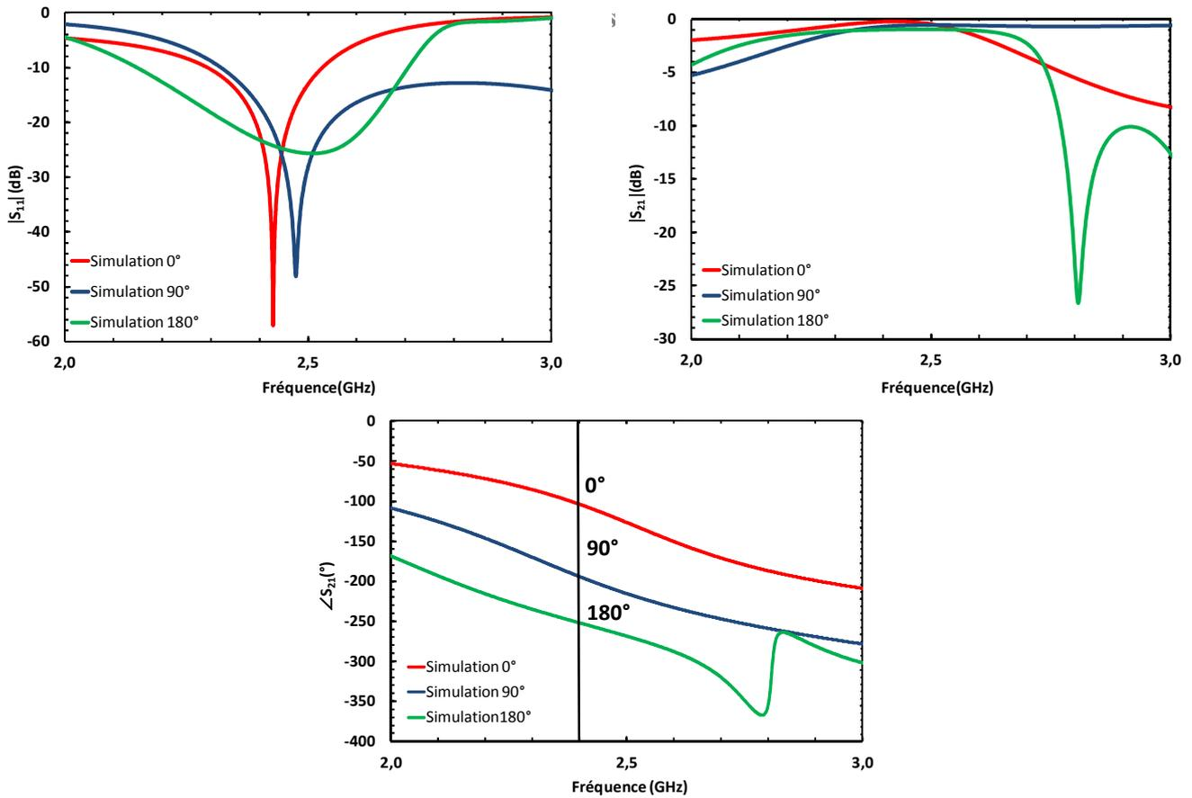
Figure II-3 : Simulation du déphaseur en éléments localisés
