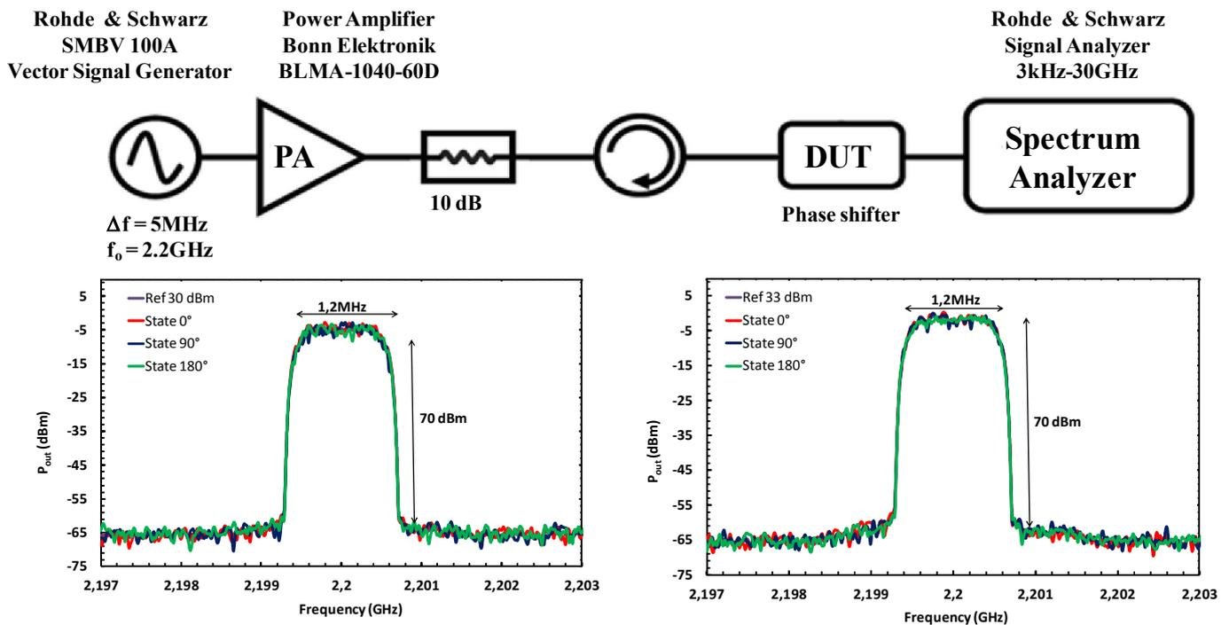
Figure III-5 : Mesure APCR des deux déphaseurs à base de coupleur hybride, (a) En éléments localisés, (b) En éléments distribués
