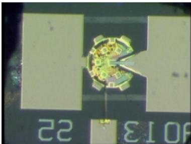
Figure IV-1 : Flip-chip endommagé
