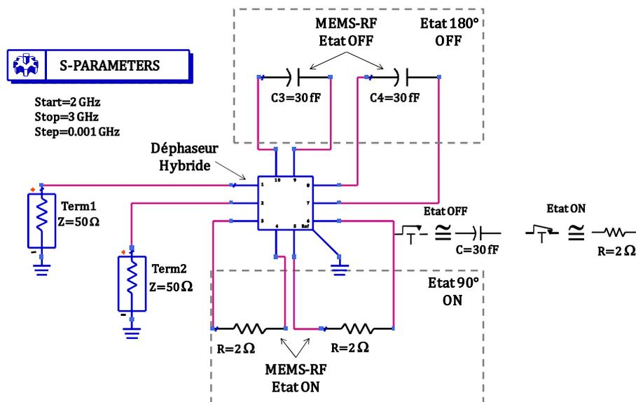
Figure II-3 : Schéma équivalent sur ADS circuit, exemple à 90° de déphasage
