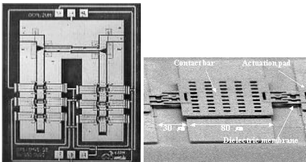
Figure I-4 : Déphaseur à base de coupleur hybride de l'université de Séoul, MEMS-RF
