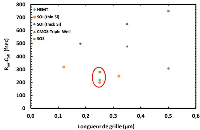
Figure IV-2 : Comparaison des différents technologies de commutateurs capables de tenir la puissance[20]
