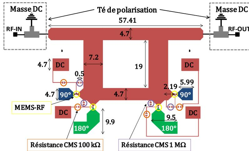
Figure II-2: Déphaseur à base de coupleur hybride 57mm\*43mm
