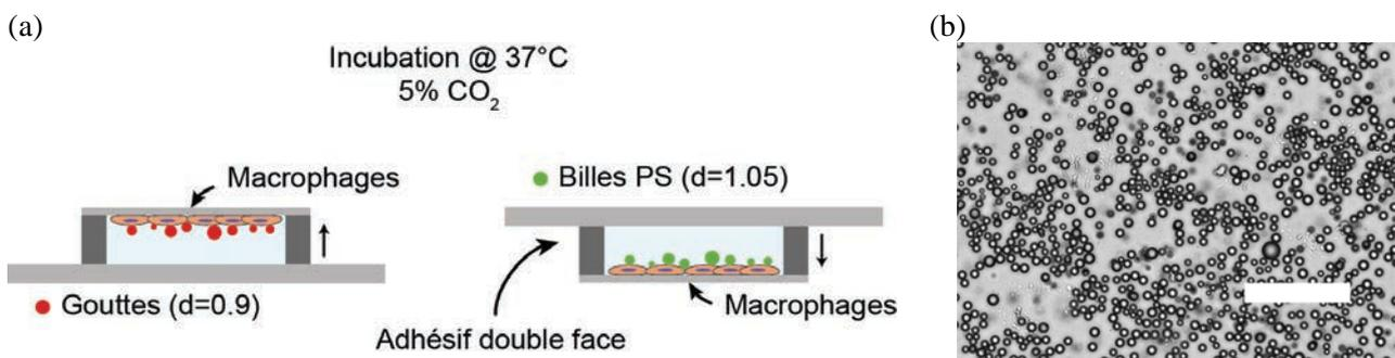
**Figure 4.2.** (a) Représentation schématique de la configuration de l'expérience et des chambres d'observation lamelle-lamelle incubées à 37°C sous 5% de CO<sub>2</sub>. (b) Image en microscopie optique de transmission (10x) d'une suspension de gouttes dans du DMEM. Echelle : 100 microns.
