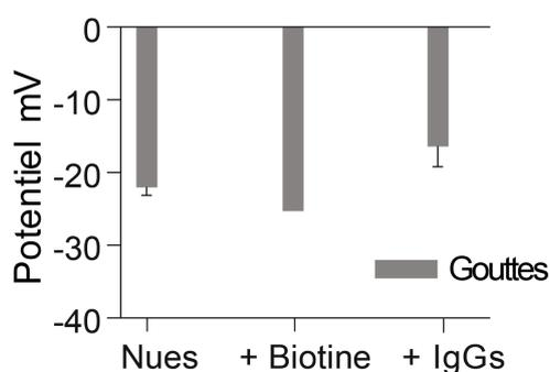
**Figure 3.31.** Comparaison du potentiel  $\zeta$  des gouttes d'émulsions à différentes étapes de fonctionnalisation de l'interface. Chaque valeur obtenue correspond à la moyenne de trois séries de dix acquisitions.
