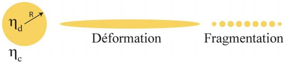
**Figure 3.10.** Processus de fragmentation qui utilise l'instabilité de Rayleigh. Lorsqu'une goutte de viscosité interne  $\eta_d$  est cisailée dans une phase externe de viscosité  $\eta_c > \eta_d$ , celle-ci s'allonge puis se divise en plusieurs petites gouttes.
