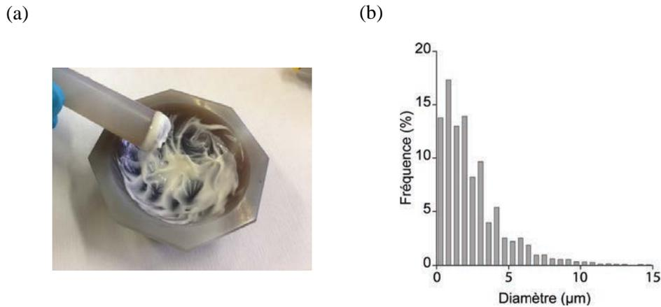
**Figure 3.8.** (a) Image du mortier en agate utilisé. (b) Distribution des gouttes d'émulsion faites au mortier en fonction de la taille obtenue à partir d'analyse d'images du microscope par le logiciel d'imagerie Image J. L'émulsion est polydispense avec un diamètre moyen  $< 5 \mu\text{m}$  pour 60% des gouttes.
