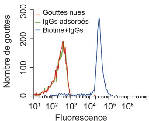
**Figure 3.25.** Profil d'intensité de fluorescence de gouttes nues (sans biotine), gouttes nues incubées dans une solution d'IgGs à  $0.03 \text{ mg.mL}^{-1}$  et gouttes biotinylées incubées avec la même concentration d'IgGs.
