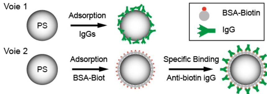
**Figure 3.32.** Schéma de principe des deux méthodes de fonctionnalisation de la surface des billes de polystyrène. Voie 1 : Adsorption directe des IgGs de types différents. Voie 2 : Adsorption de BSA biotinylée à la surface des billes suivie par l'incubation avec les IgGs anti-biotines.
