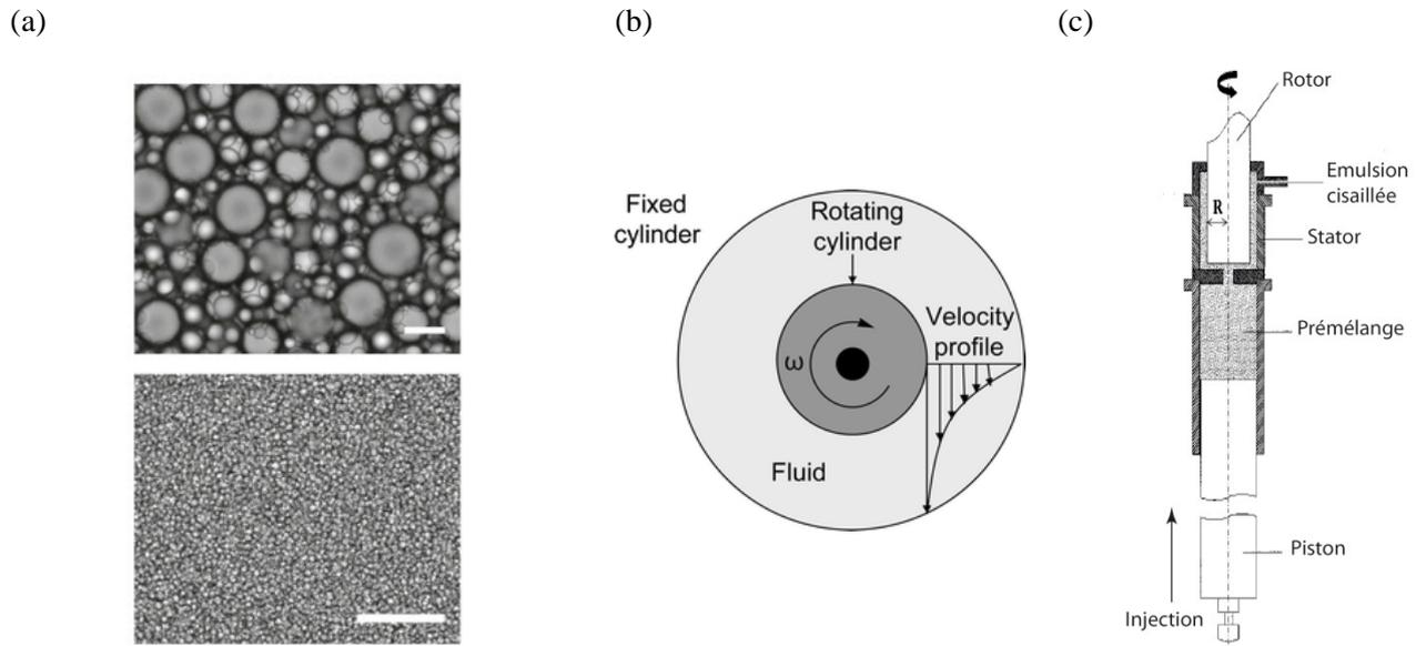
**Figure 3.9.** (a) Photographie d'un *premix* à la main et une émulsion fragmentée après passage en Couette. Échelle : 30  $\mu\text{m}$ . (b) Plan d'une cellule de Couette avec le rotor interne, le stator externe, et une représentation du profil de vitesse. Dans un écoulement de Couette, le cisaillement est constant quelle que soit la distance à la paroi. (c) Schéma de l'émulsificateur de Couette que nous avons utilisé.
