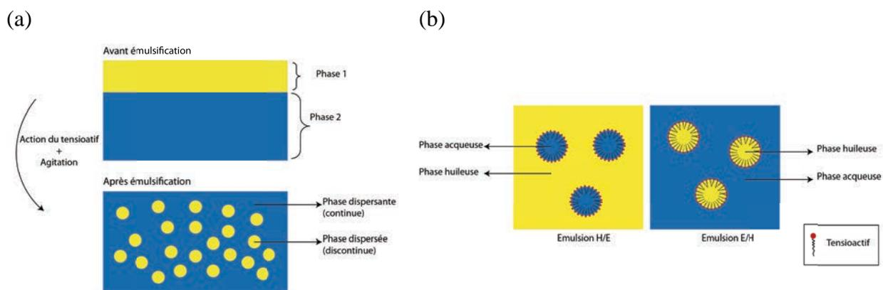
**Figure 2.1.** (a) Représentation schématique de la formation d'une émulsion à partir de deux liquides non miscibles. (b) Représentation schématique des deux types d'émulsions les plus couramment utilisées, indirecte (H/E) et directe (E/H).
