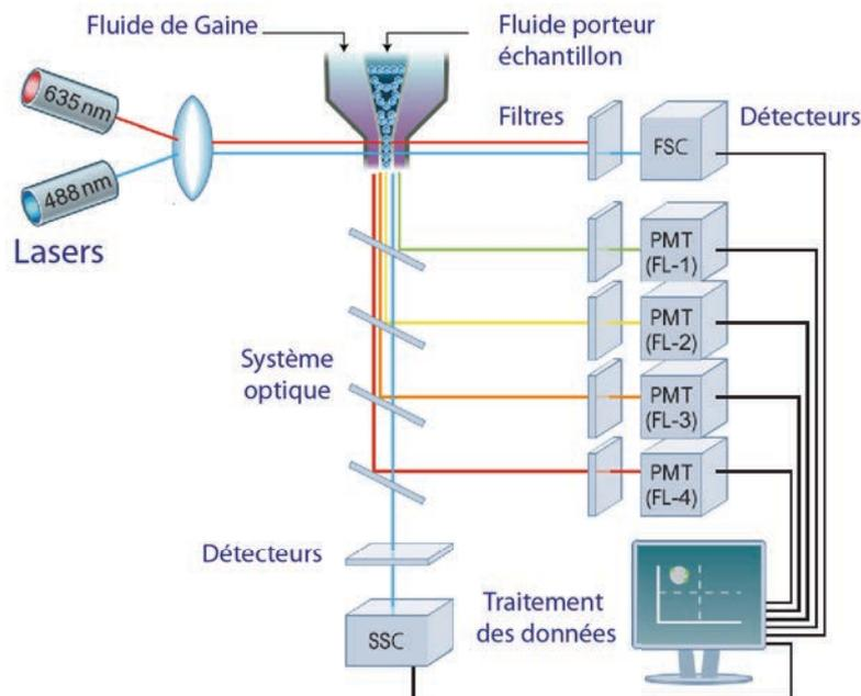
**Figure 3.18.** Schéma du système de focalisation hydrodynamique d'un cytomètre de flux couplé au système optique d'illumination et de mesure des deux paramètres de diffusion FSC et SSC ainsi que les signaux de fluorescence. Image adaptée de (Rahman, 2006).
