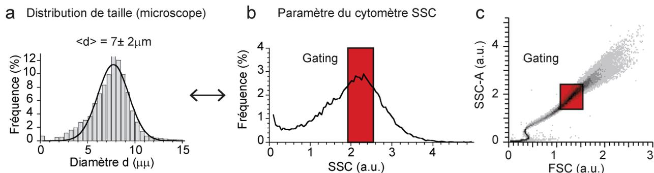
**Figure 3.21.** (a) Distribution de taille des gouttes obtenue en microscopie. (b) Intensités de diffusion sur le côté (SSC) de notre émulsion monodisperse mesurées avec le cytomètre de flux. La diffusion latérale dans notre cas correspond à la taille de nos gouttes et possède la même allure que la distribution de taille mesurée avec le microscope. (c) En rouge, la fenêtre de *gating* correspondant aux gouttes ayant un SSC proche du maximum de la distribution de taille
