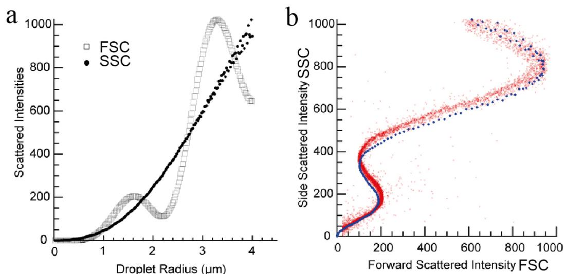
**Figure 3.20.** (a) Evolution des intensités de diffusion FSC et SSC, calculées numériquement, en fonction de taille des gouttes d'huile. FSC montre des oscillations alors que le paramètre SSC est monotone croissant. (b) Superposition du diagramme de diffusion  $SSC=f(FSC)$  calculé numériquement (bleu) avec une courbe expérimentale enregistrée pour une émulsion d'huile de soja polydispense (rouge) avec un cytomètre de type B Facscalibur.
