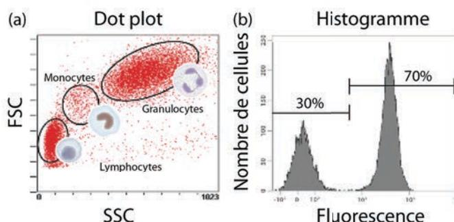
**Figure 3.19.** (a) Représentation bi-paramétrique de l'intensité de diffusion vers l'avant FSC en fonction de celle vers le côté SSC. Les populations de cellules apparaissent comme des nuages de points homogènes où chaque point représente une cellule. (b) Histogramme de diffusion sur le côté où on peut isoler deux populations d'intensités de fluorescence différentes. Images adaptées de (Rahman, 2006).
