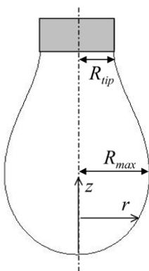
**Figure 3.28.** Représentation schématique d'une goutte pendante à l'extrémité d'un tube. Image adaptée de (ESPCI).
