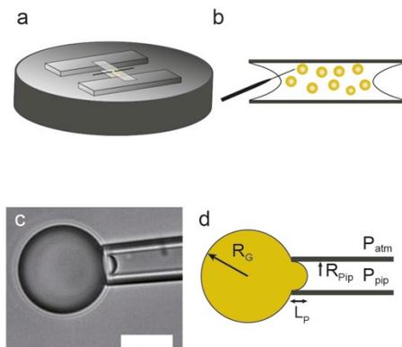
**Figure 3.29.** (a) et (b) La chambre d'observation est constituée de deux lamelles où des gouttes sont diluées dans du tampon PB à 0,2%<sub>m/m</sub> Tween20 pour éviter l'adhésion aux parois de la pipette. (c) La goutte est soumise à une aspiration contrôlée par une différence de pression. (d) La mesure du rayon de la goutte et de celle de la pipette permet de mesurer la tension interfaciale.
