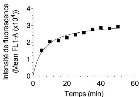
**Figure 3.16.** Evolution de l'intensité de fluorescence des gouttes en fonction du temps d'incubation pour des émulsions à  $0.03 \text{ mg.mL}^{-1}$  de DSPE-PEG<sub>2000</sub>-Biotine et incubées dans une solution de  $0,03 \text{ mg.mL}^{-1}$  d'IgGs.
