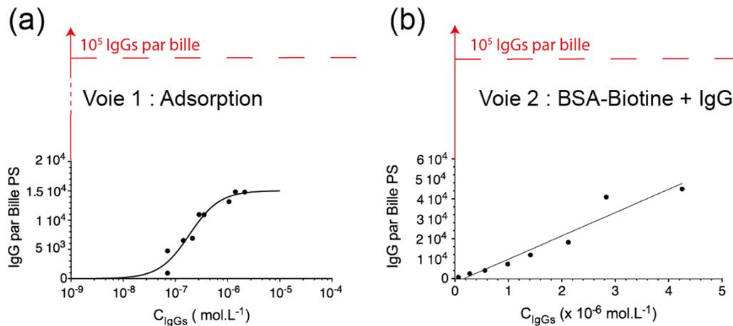
**Figure 3.33.** Courbes de fonctionnalisation de la surface des billes avec en (a) le protocole en deux étapes faisant intervenir de la BSA-biotine et en (b) l'opsonisation par adsorption physique directe des IgGs en surface.
