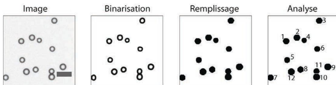
**Figure 3.17.** Image en microscopie en transmission de gouttes d'émulsions qui a été modifiée avec le logiciel Image J. Les gouttes étant très contrastées il est aisé de les seuiller et de les binariser avant de mesurer leur nombre et leurs tailles. Échelle : 10  $\mu\text{m}$ .
